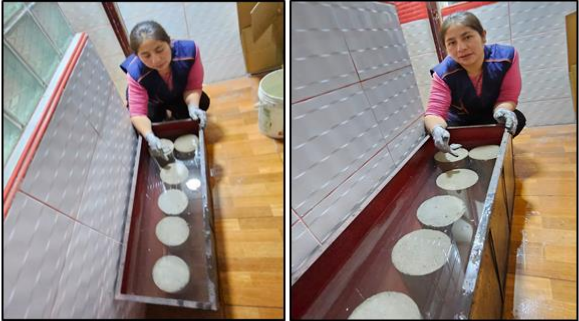
Figura 14. Curado de probetas cilíndricas
