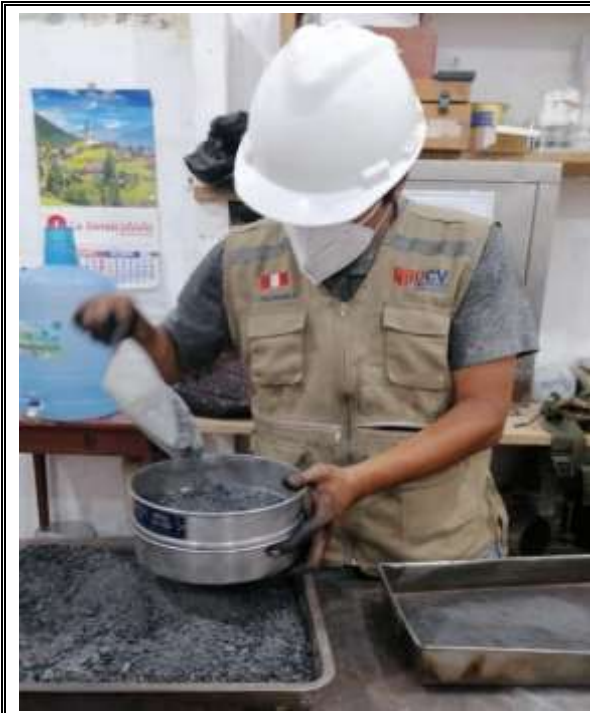
Fotos N° 05-06: En las imágenes se puede apreciar el muestreo de ceniza de cascarilla de café.
