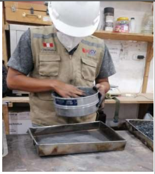
Fotos N° 05-06: En las imágenes se puede apreciar el muestreo de ceniza de cascarilla de café.
