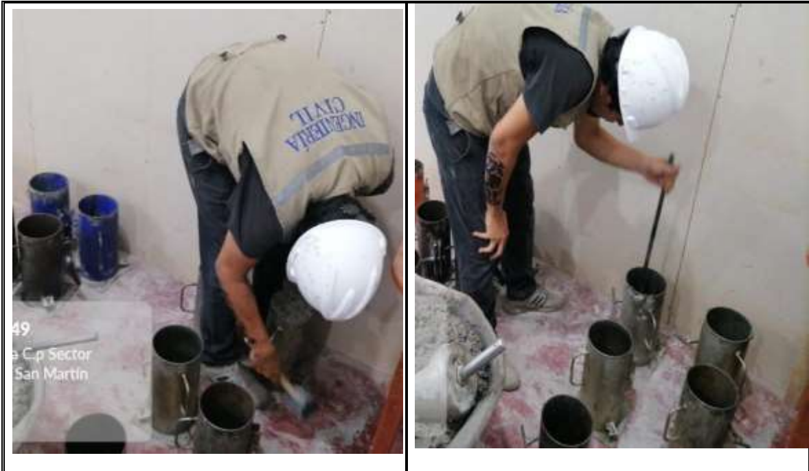
Fotos N° 21-22: En las imágenes podemos observar el moldeo de los testigos de concreto.
