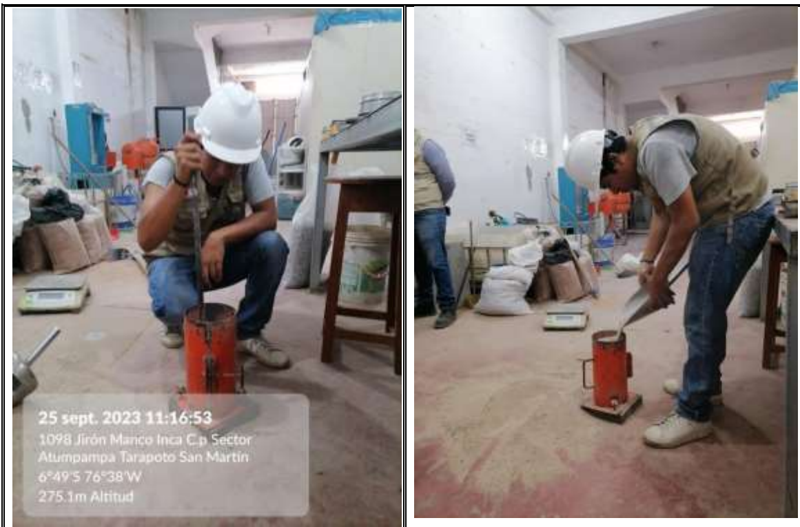
Fotos N° 13-14: En las imágenes podemos observar realización del ensayo de peso unitario de la arena zarandeada.
