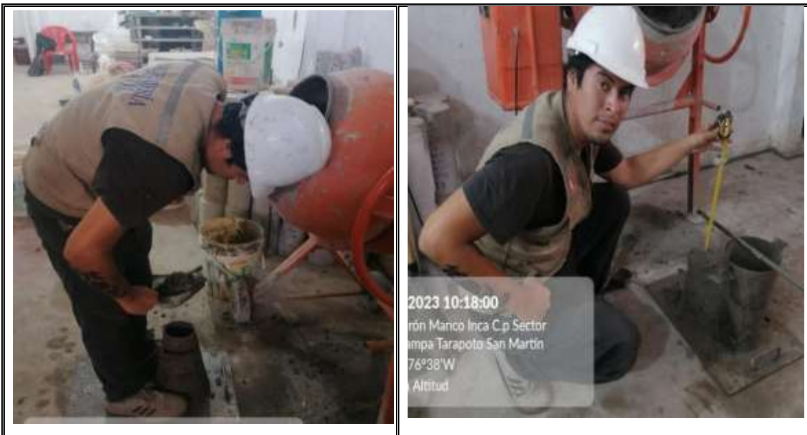
Fotos N° 15-16: En las imágenes podemos observar al personal realizando la prueba de asentamiento para los diseños de Mezclas.
