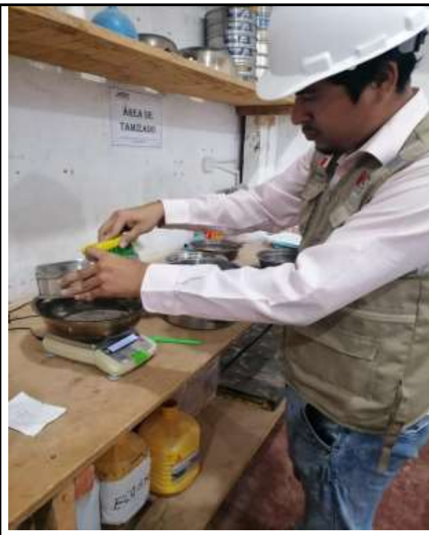
Fotos N° 09-10: En las imágenes se puede apreciar el ensayo de análisis granulométricos.
