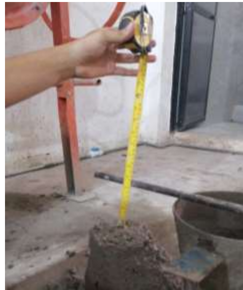
Fotos N° 19-20: En las imágenes podemos observar al personal realizando la prueba de asentamiento para los diseños de Mezclas.
