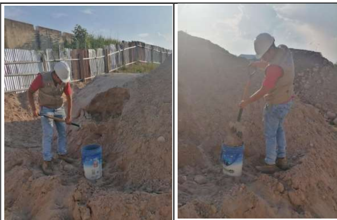
Fotos N° 03-04: En las imágenes se puede apreciar el muestreo de la arena zarandeada.
