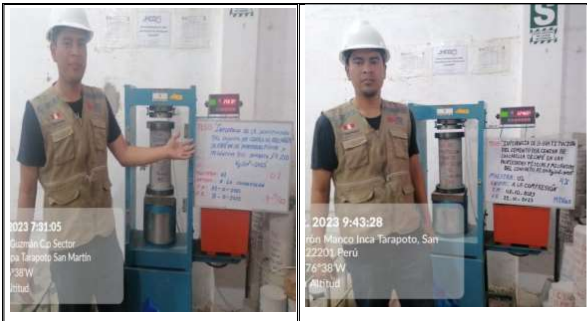
Fotos N° 23-24: En las imágenes podemos observar la resistencia a la compresión axial de los testigos de concreto.
