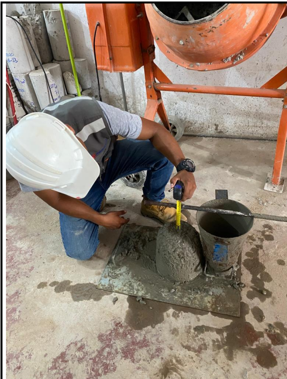
Fotos nº 17-18: En las imágenes podemos observar al personal realizando la prueba de asentamiento para los diseños de Mezclas.
