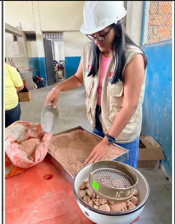
Fotos nº 09-10: En las imágenes se puede apreciar el ensayo de análisis granulométricos.
