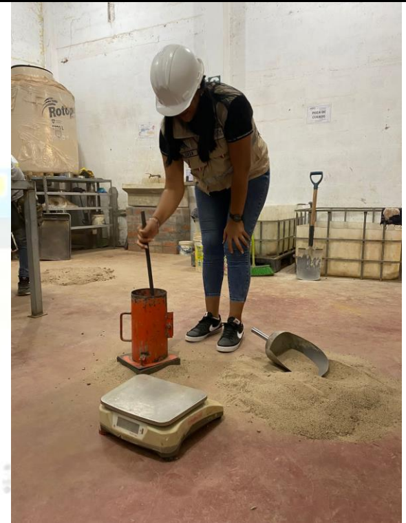
Fotos nº 13-14: En las imágenes podemos observar realización del ensayo de peso unitario de la arena zarandeada.
