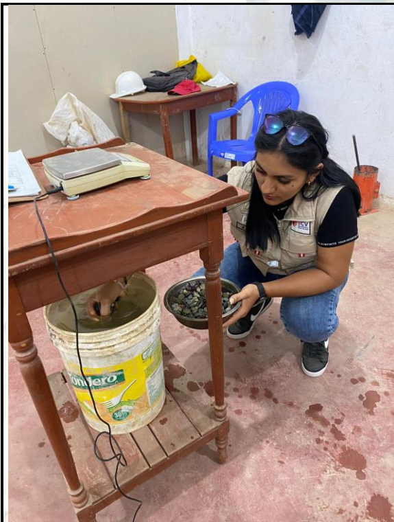
Fotos nº 11-12: En las imágenes podemos observar el ensayo de gravedad específica de los agregados.
