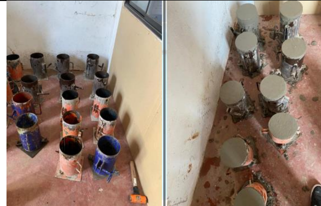
En las fotografías se pueden observar el moldeo de los testigos de concreto.
