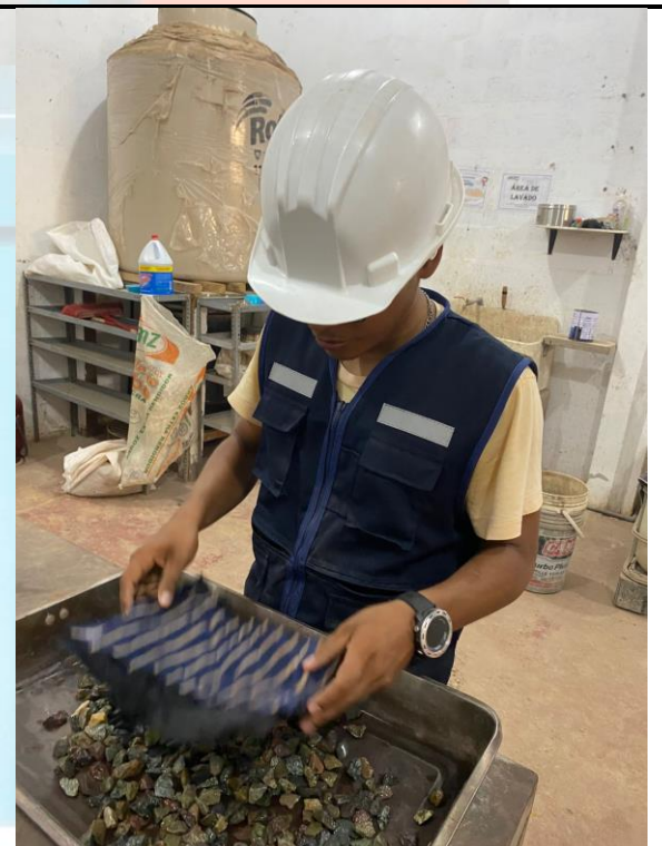
Fotos nº 11-12: En las imágenes podemos observar el ensayo de gravedad específica de los agregados.
