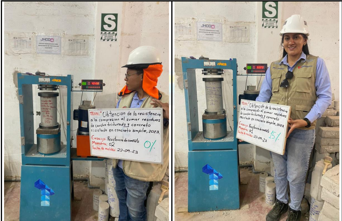
Fotos n° 25-26: En las imágenes podemos observar la resistencia a la compresión axial de los testigos de concreto
