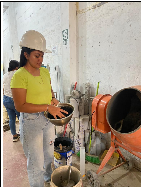
Fotos nº 17-18: En las imágenes podemos observar al personal realizando la prueba de asentamiento para los diseños de Mezclas.
