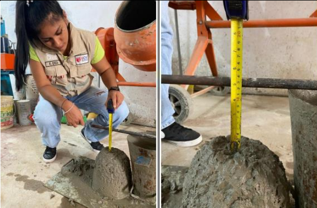
En las fotografías se aprecia el ensayo del asentamiento de las mezclas antes de realizar los testigos de concreto.
