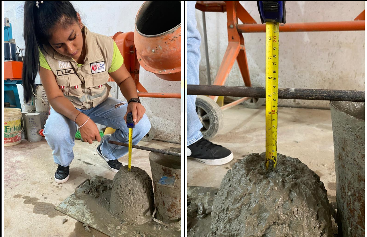
Fotos n° 21-22: En las imágenes podemos observar al personal realizando la prueba de asentamiento para los diseños de Mezclas.
