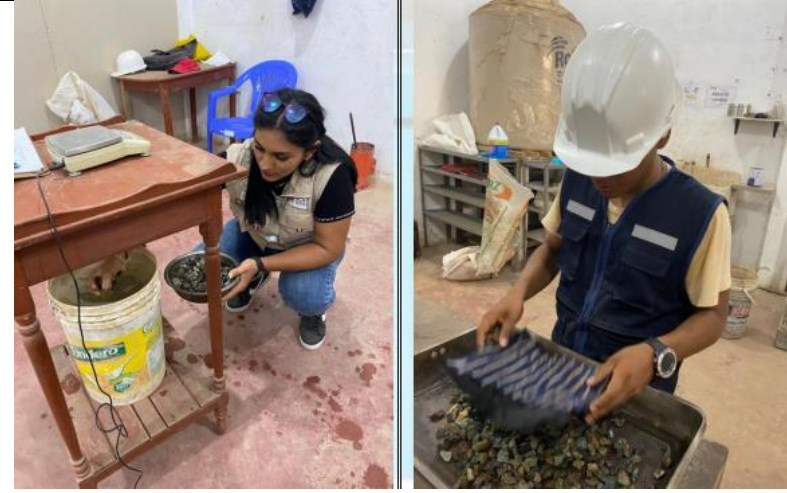
En las fotografías se pueden observar el ensayo de gravedad específica y absorción de los agregados.
