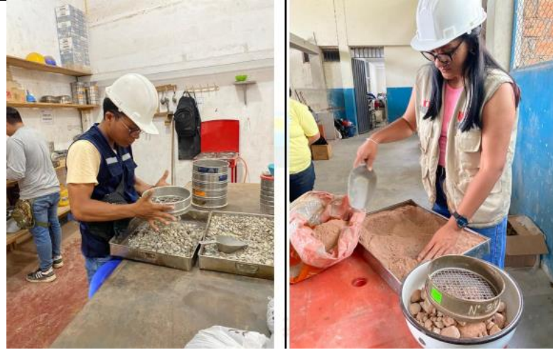
En las fotografías se aprecia el ensayo de granulometría.
