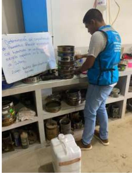
**Fotografía 2:** Análisis Granulométrico por Tamizado
