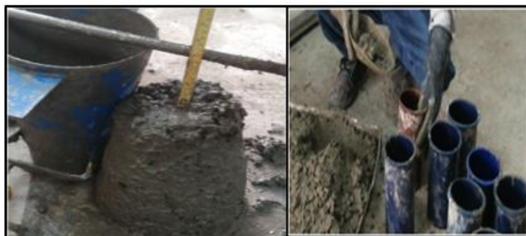
Figura 26. Ensayo de asentamiento
