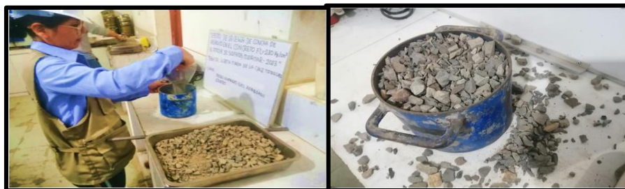
Figura 17. Colocación vertical y enraizado del agregado grueso Fuente: Producción propia.
