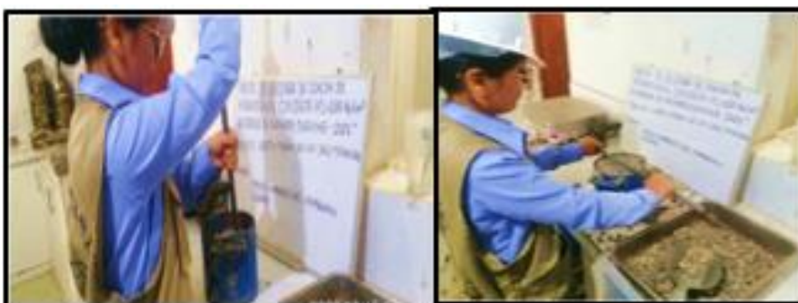
Figura 18. Apisonamiento y enrazado agregado grueso
