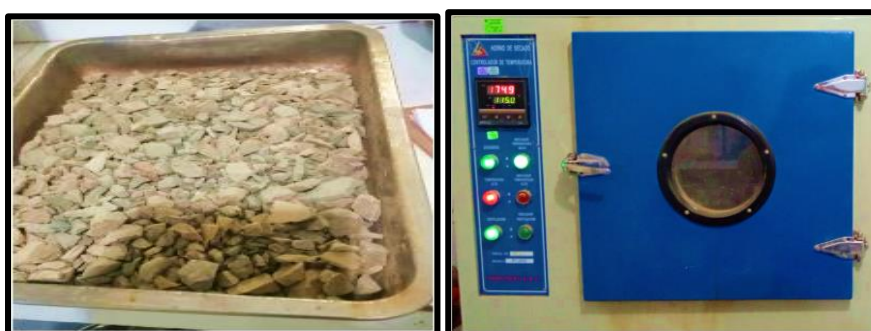
Figura 21. Obtención del peso seco agreg. grueso
