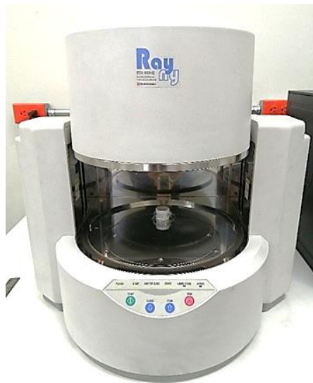
FIGURA N°2. ANÁLISIS DE COMPOSICIÓN QUÍMICA USANDO EL ESPECTRÓMETRO DE FLUORESCENCIA DE RAYOS X DE ENERGÍA DISPERSIVA (SHIMADZU, EDX-800HS).
