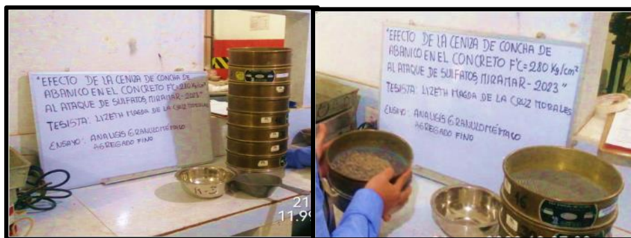
Figura 15. Proceso de tamizado del agreg. fino
