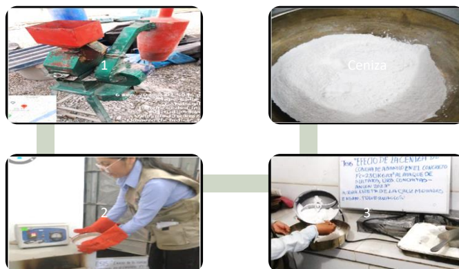
Figura 12. Obtención de la ceniza concha de abanico Fuente: Producción propia.
