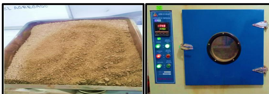
Figura 22. Obtención del peso seco agreg. fino
