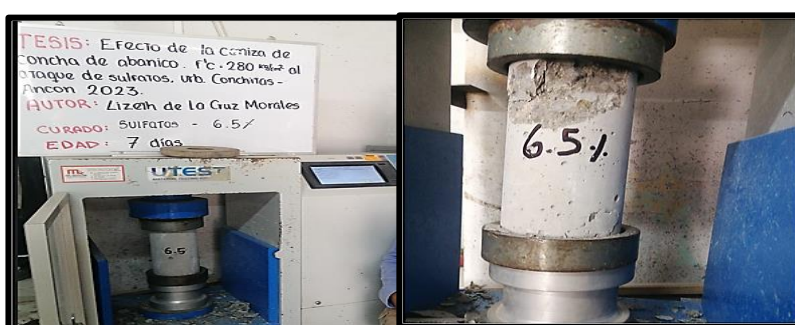
Figura 38. Ensayo de resistencia a la compresión Fuente: Elaboración propia.
