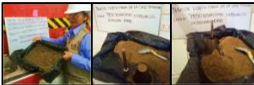
Figura 24. Verificación de la humedad del agreg. fino
