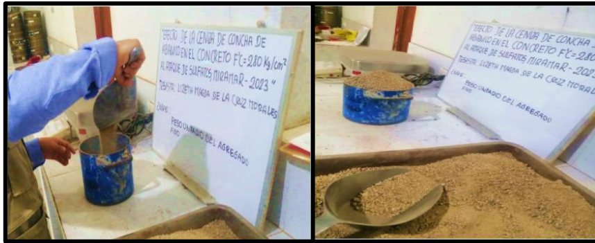
Figura 19. Colocación y enrazado vertical del agreg. fino Fuente: Producción propia.
