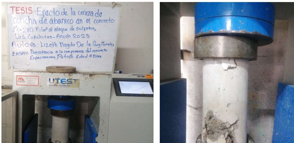
Ensayo de resistencia a la compresión
