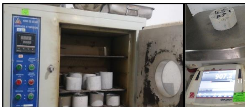
Figura 33. Ensayo de densidad
