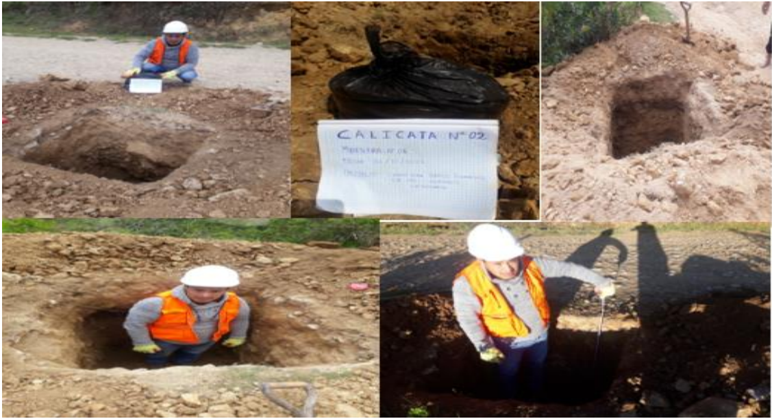
Figura N°10: Figura Calicatas en situ C-01, C-02, C-03, C- 04 y C- 05. Fuente: Elaboración propia
