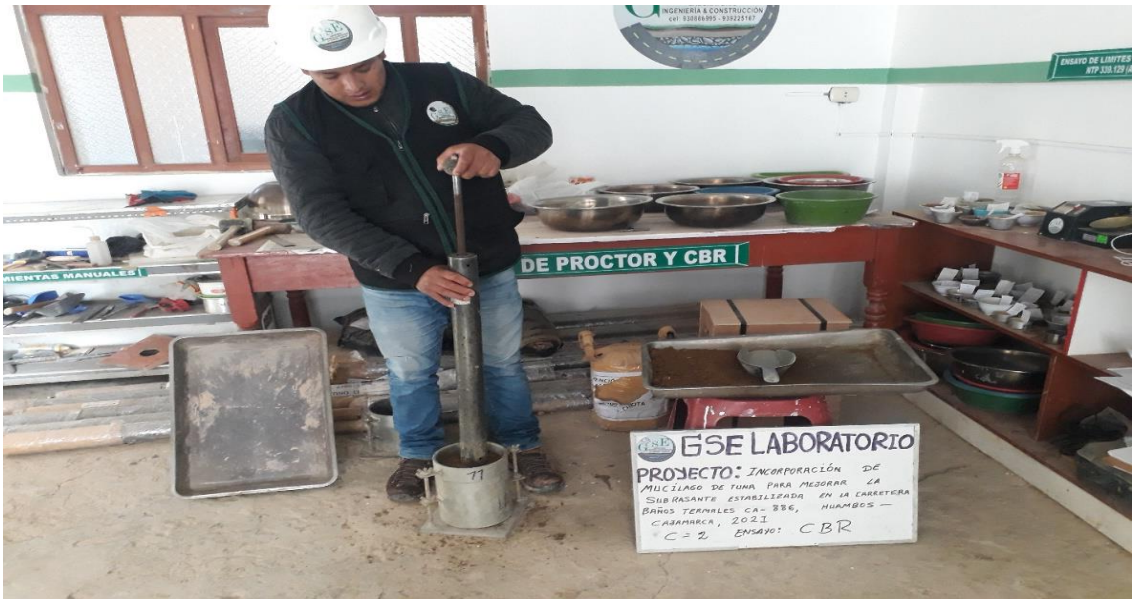
Figura N°14: Ensayo de CBR C2 patrón Fuente: Elaboración propia
