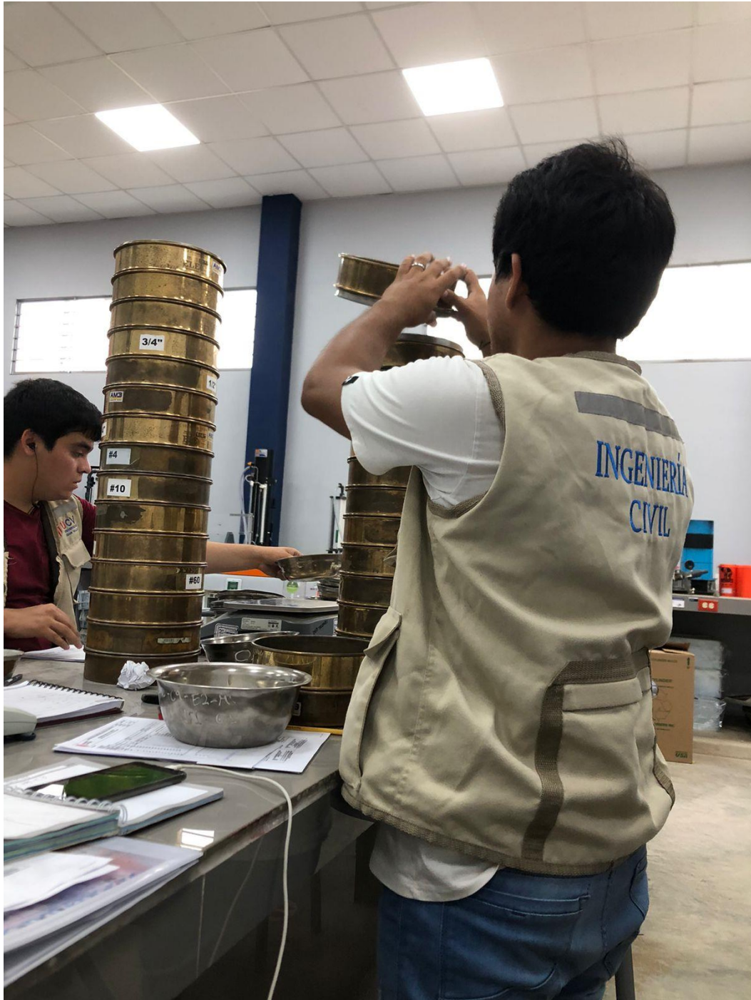
Figura 34. Análisis granulométrico por tamizado Fuente: Elaboración propia
