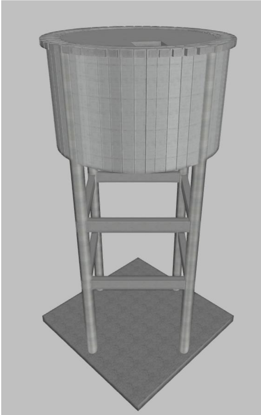
Vista 3d RESERVORIO CIRCULAR ELEVADO 80M3
