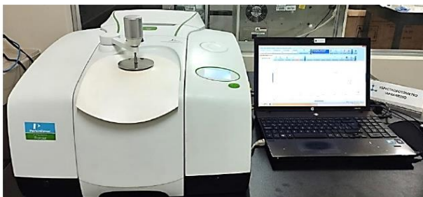
FIGURA N°2. Espectrofotómetro infrarrojo de reflectancia total atenuada (FTIR – ATR) PERKIN ELMER. FRONTIER Serie: 102921.
