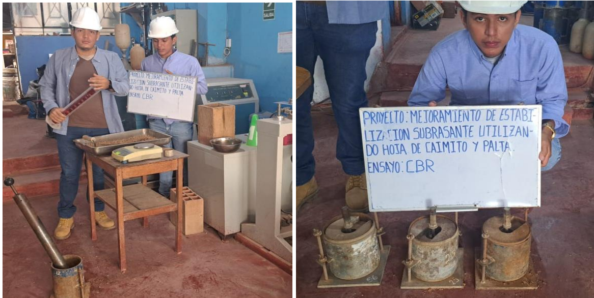
Foto 1: Ensayos del CBR.
