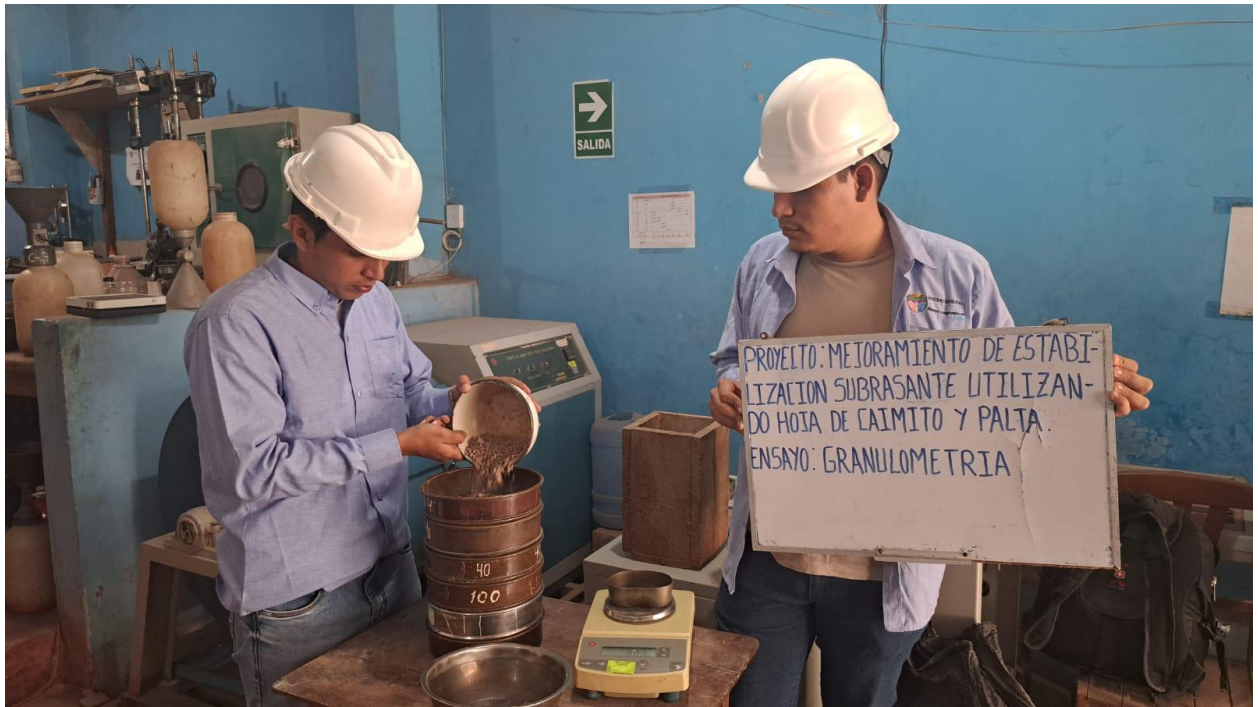
Foto 3: ensayo granulométrico iniciando el proceso
