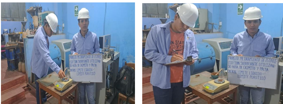
Figura 8: Análisis del límite líquido
