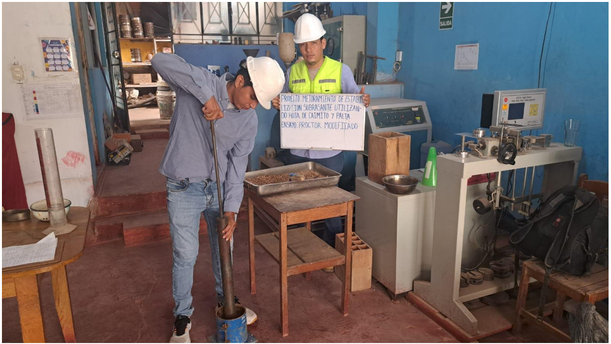
Foto 7: Análisis del proctor modificado
