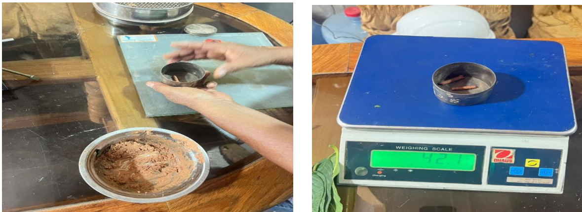
Figura 7: Preparando el material para el ensayo de consistencia
