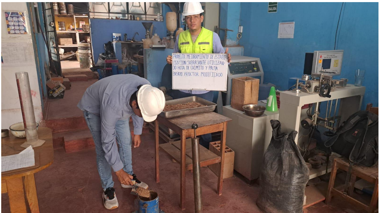
Foto 6: Análisis del proctor modificado
