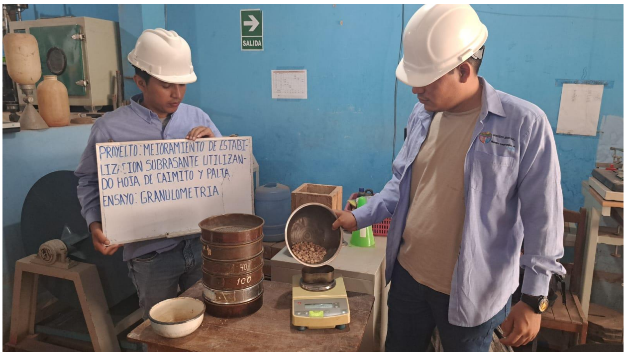
Foto 4: ensayo granulométrico realizando el pesado.
