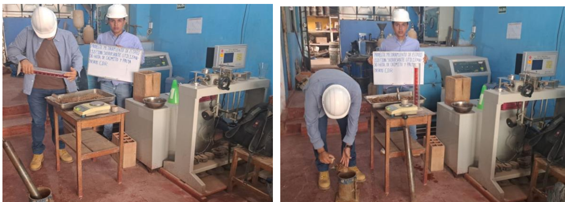
Foto 11. Análisis del CBR Análisis del CBR de la C-1, C-2 y C-3 de la muestra patrón y con adición de 2%, 2.5% y 3% de CHC.
