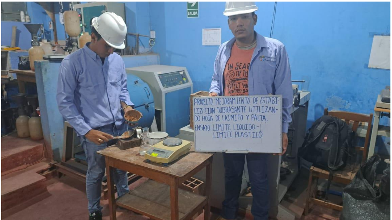
Foto 10: Análisis de limite plástico y limite líquido
