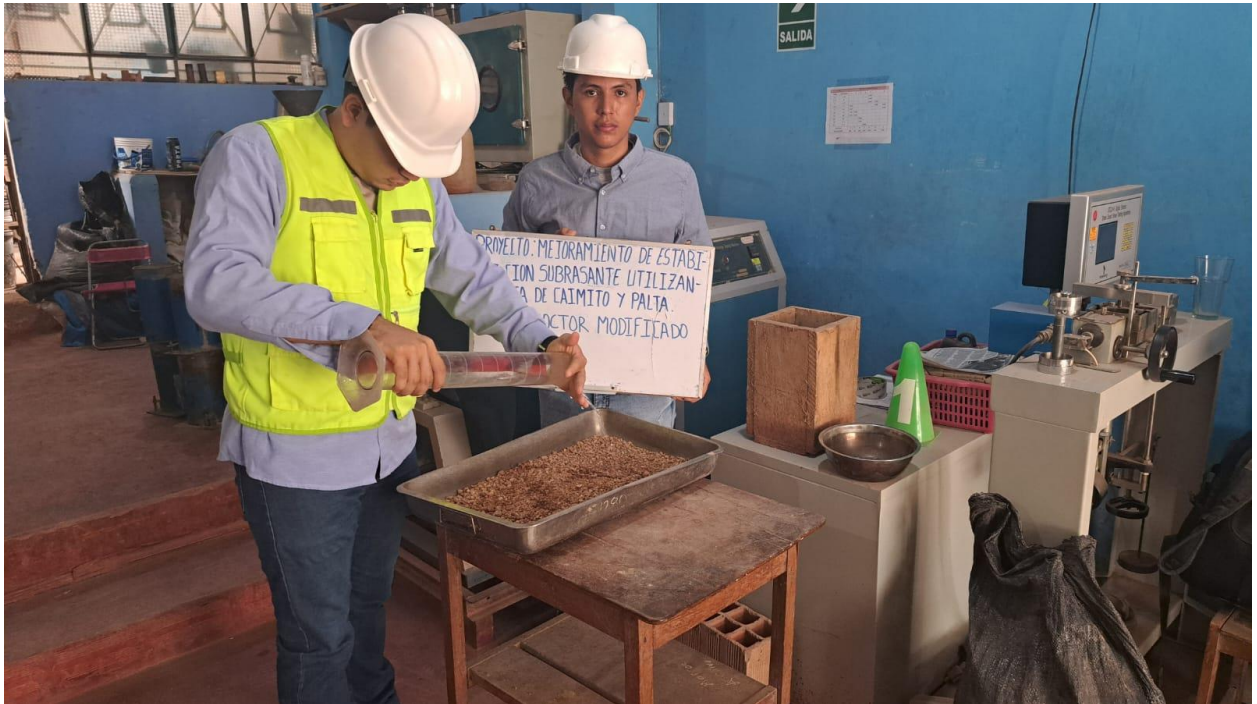
Foto 5: Análisis del proctor modificado
