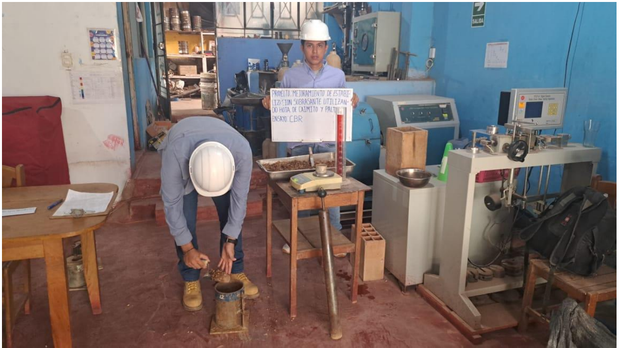
Foto 9: Ensayo del proctor modificado
