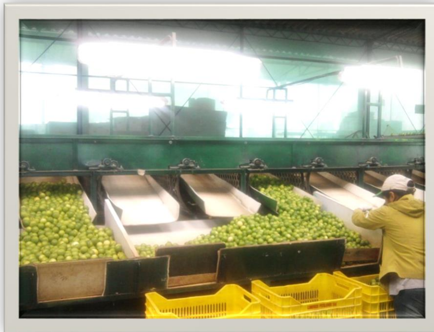
Figura 20: Saturación de tolvas centrales Fuente: Elaboración propia
