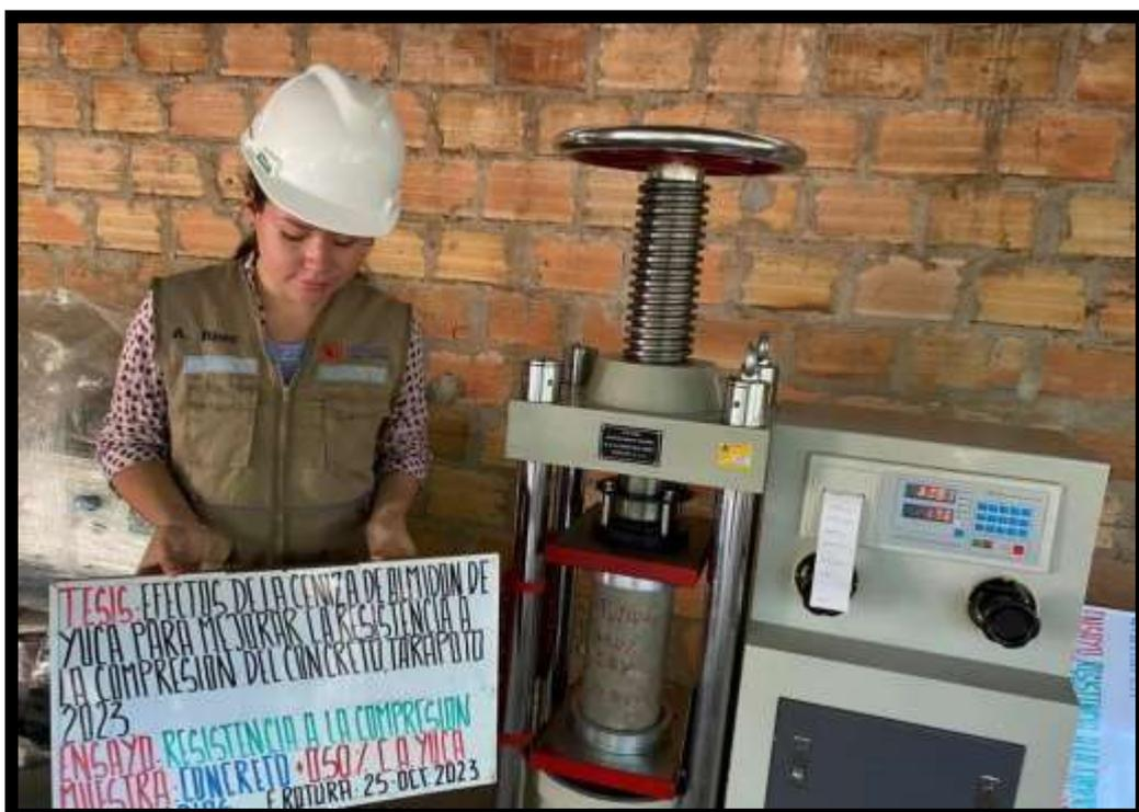
**IMAGEN 28:** RUPTURA DE LAS PROBETAS ADICIONANDO LAS CENIZAS DEL ALMIDÓN 0.75% A LOS 14 DIAS
