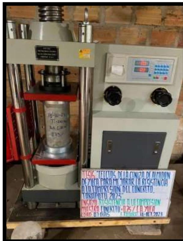
**IMAGEN 26:** RUPTURA DE LAS PROBETAS ADICIONANDO LAS CENIZAS DEL ALMIDÓN 0.25% A LOS 14 DIAS
