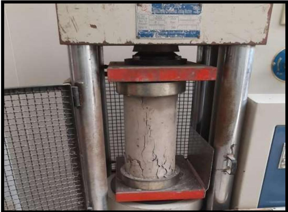
**IMAGEN 23: RUPTURA DE LAS PROBETAS ADICIONANDO LAS CENIZAS DEL ALMIDÓN 0.25% A LOS 07 DIAS**
