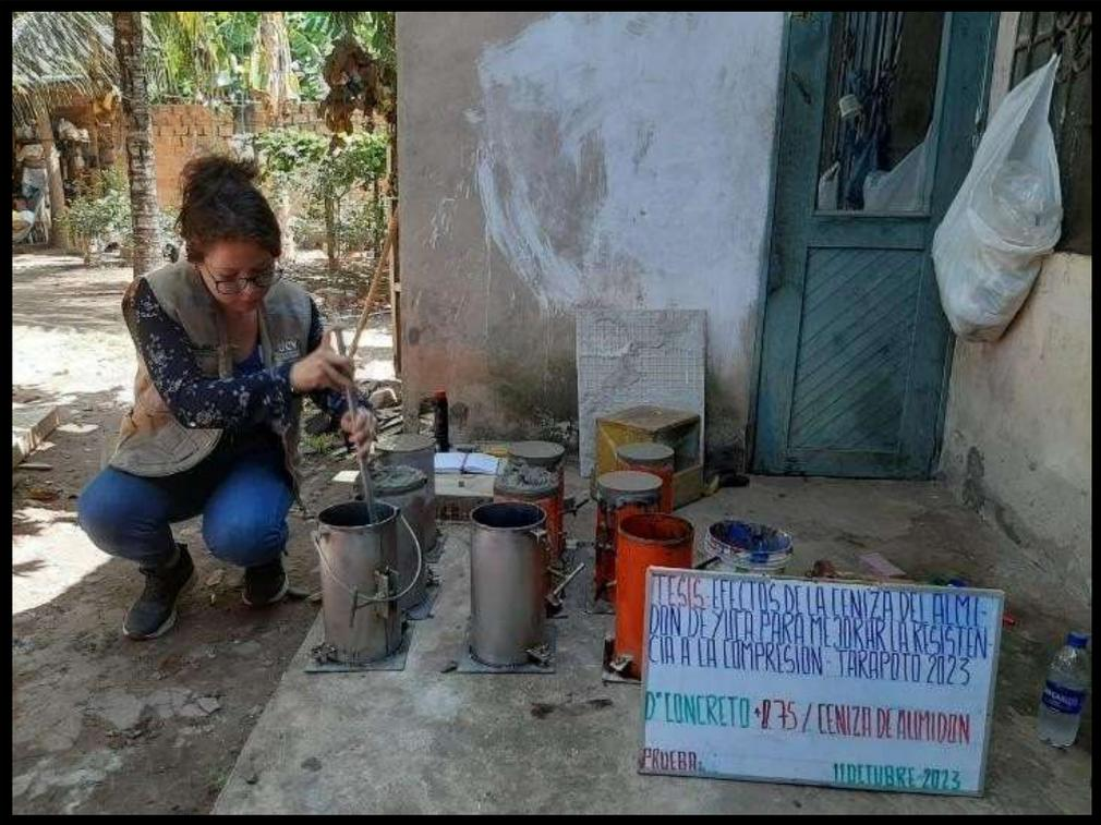
**IMAGEN 18:** SE OBSERVA LOS TESTIGOS DE CONCRETO YA ELABORADOS (CONCRETO CON ADICIÓN DE 0.25%)
