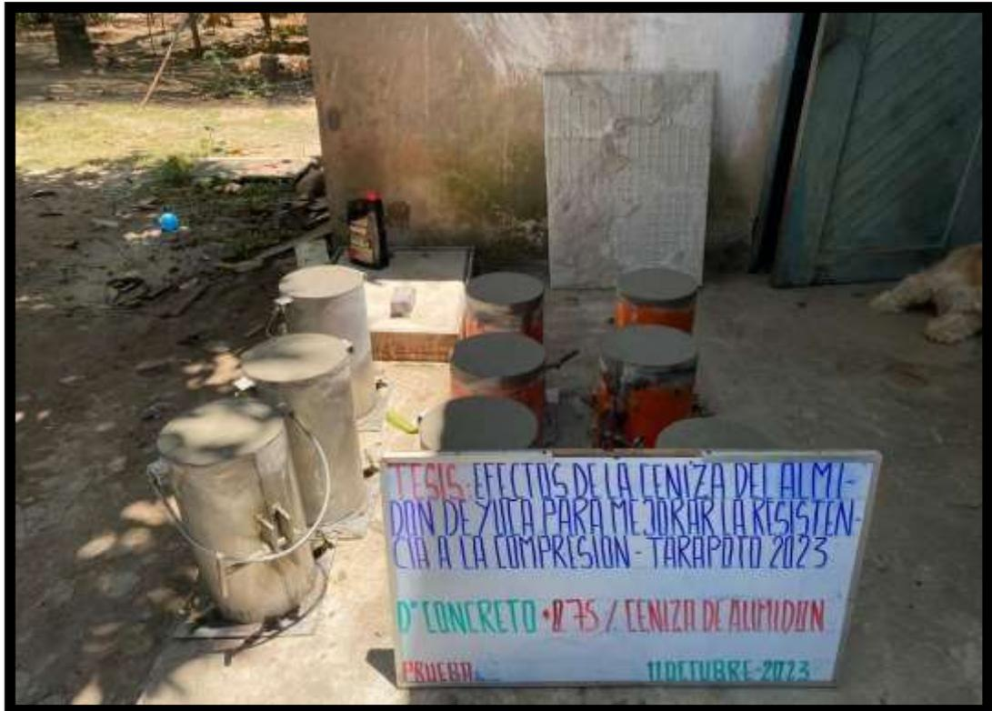
**IMAGEN 21:** SE OBSERVA LOS TESTIGOS DE CONCRETO YA ELABORADOS (CONCRETO CON ADICIÓN DE 0.75%)
