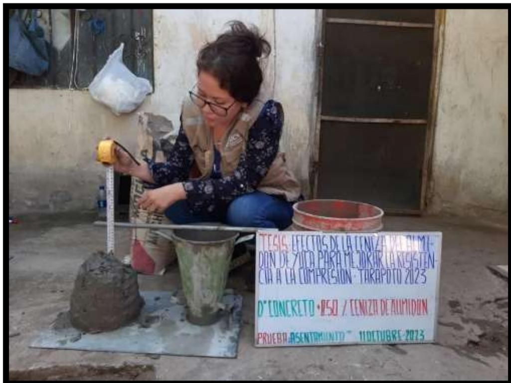
**IMAGEN 14: PRUEBA DE ASENTAMIENTO DEL 0.75% CENIZAS DEL ALMIDÓN**
