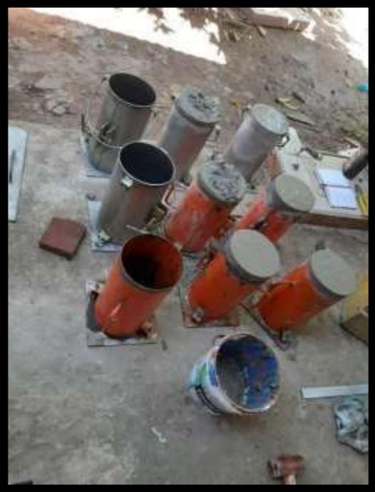
**IMAGEN 17:** ELABORACIÓN DE TESTIGOS DE CONCRETO EN MOLDES CILÍNDRICOS DE 15 CM DE DIÁMETRO X 30CM DE ALTO CON 0.75% DE INCORPORACIÓN DE CENIZAS
