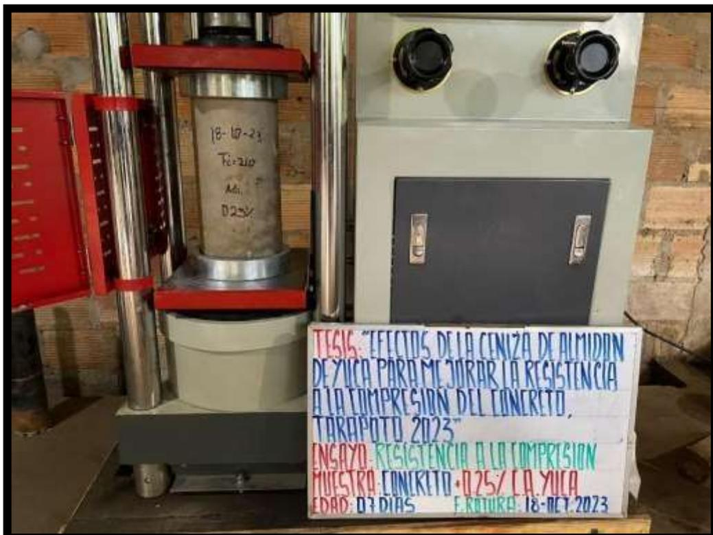
**IMAGEN 24:** RUPTURA DE LAS PROBETAS ADICIONANDO LAS CENIZAS DEL ALMIDÓN 0.50% A LOS 07 DIAS
