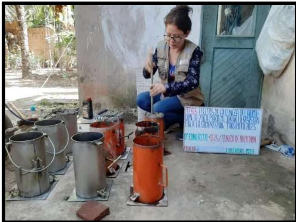
**IMAGEN 16:** ELABORACIÓN DE TESTIGOS DE CONCRETO EN MOLDES CILÍNDRICOS DE 15 CM DE DIÁMETRO X 30CM DE ALTO CON 0.50% DE INCORPORACIÓN DE CENIZAS
