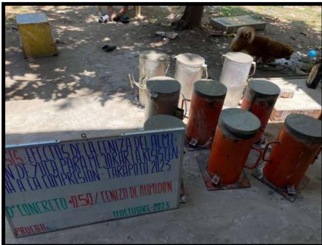
**IMAGEN 20:** SE OBSERVA LOS TESTIGOS DE CONCRETO YA ELABORADOS (CONCRETO CON ADICIÓN DE 0.75%)
