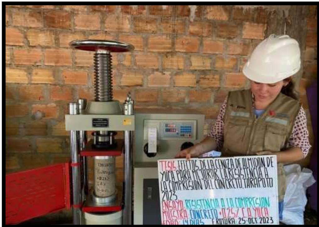
**IMAGEN 27:** RUPTURA DE LAS PROBETAS ADICIONANDO LAS CENIZAS DEL ALMIDÓN 0.50% A LOS 14 DIAS
