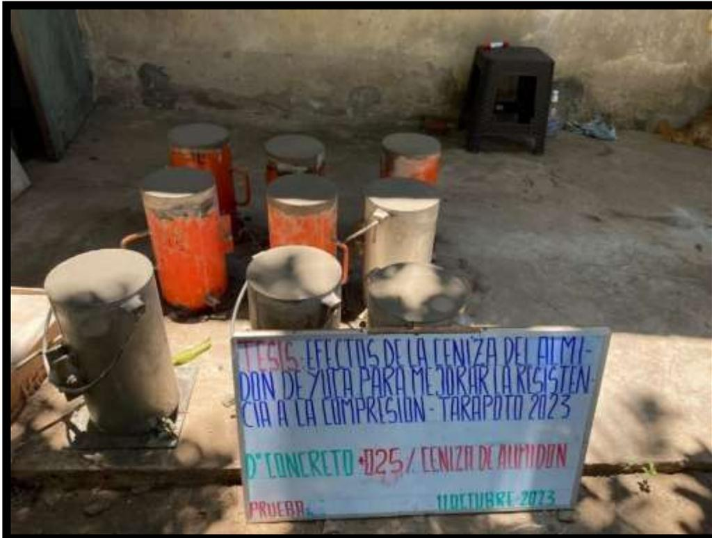
**IMAGEN 19:** SE OBSERVA LOS TESTIGOS DE CONCRETO YA ELABORADOS (CONCRETO CON ADICIÓN DE 0.50%)
