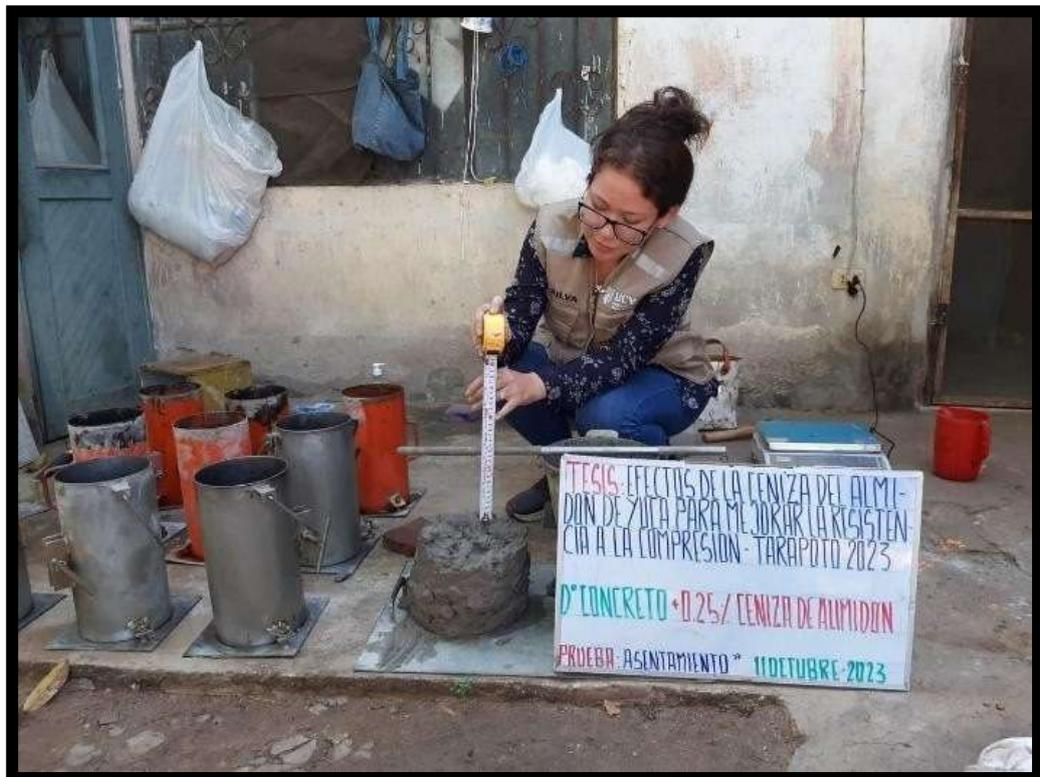
**IMAGEN 13: PRUEBA DE ASENTAMIENTO DEL 0.50% CENIZAS DEL ALMIDÓN**
