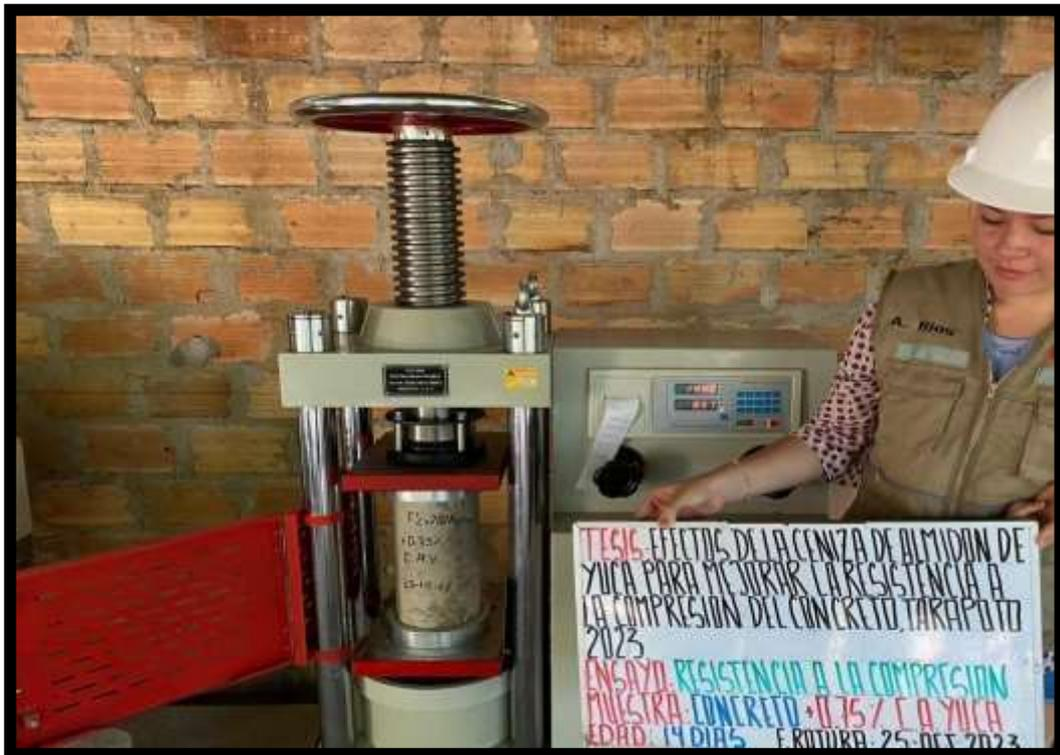
**IMAGEN 29:** RUPTURA DE LAS PROBETAS ADICIONANDO LAS CENIZAS DEL ALMIDÓN 0.25%, 0.50% y 0,75% A LOS 28 DIAS
