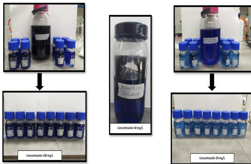
Figura 27. Preparación de las concentraciones de colorante reactivo 20, 60 y 100 mg L -1 (Elaboración propia, 2023).
