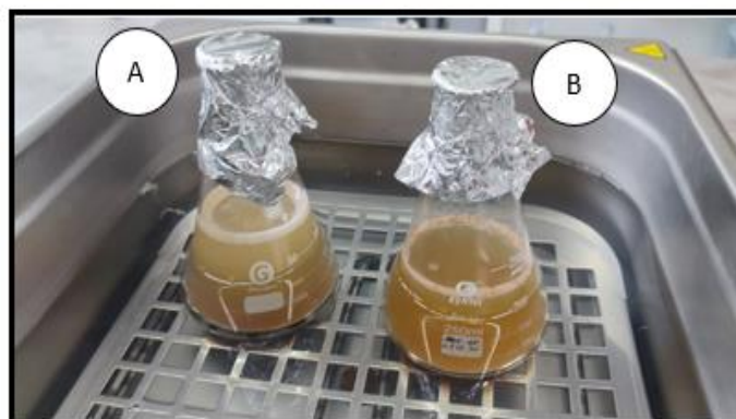
Figura 28. a) 2.5 g de levadura disuelta en 250 ml + 5g de glucosa, b) 2.5g de levadura disuelta en 250 ml + 5 g de sacarosa (Elaboración propia, 2023).
