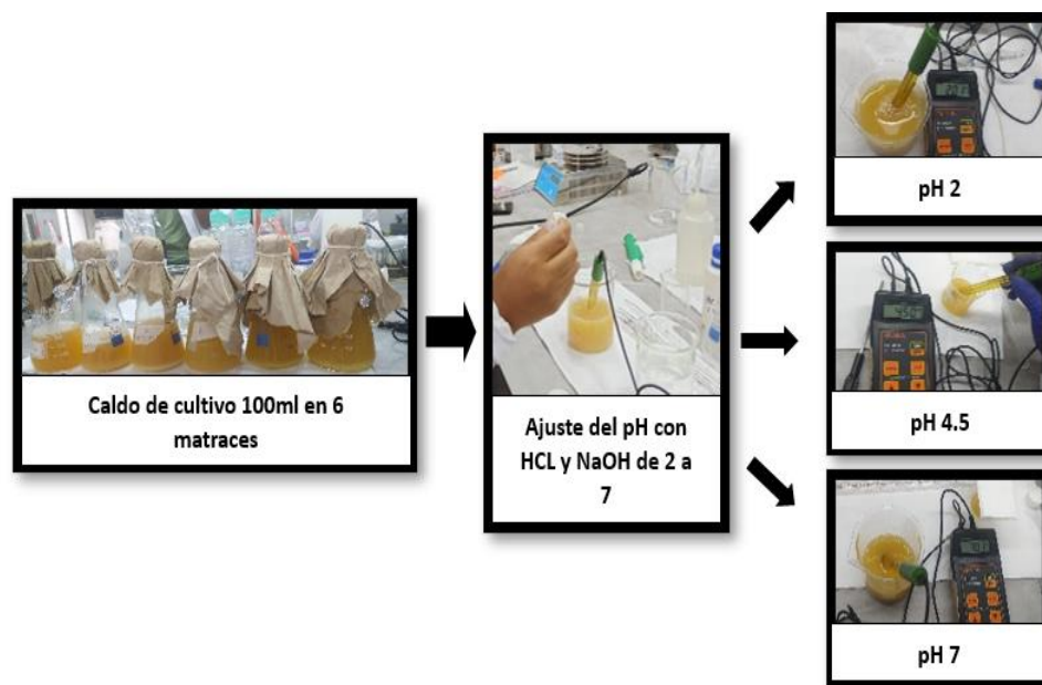
Figura 25. Proceso del ajuste del pH del caldo de cultivo utilizando ácido clorhídrico e hidróxido de sodio (Elaboración propia, 2023).
