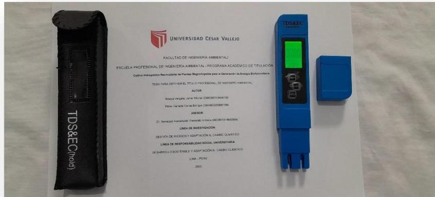
Figura A.1: Medido conductímetro de calidad de agua
