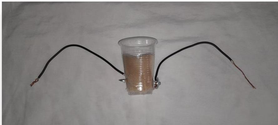
**Figura E.2: Instalación de cátodo y ánodo en los vasos de cada planta**
