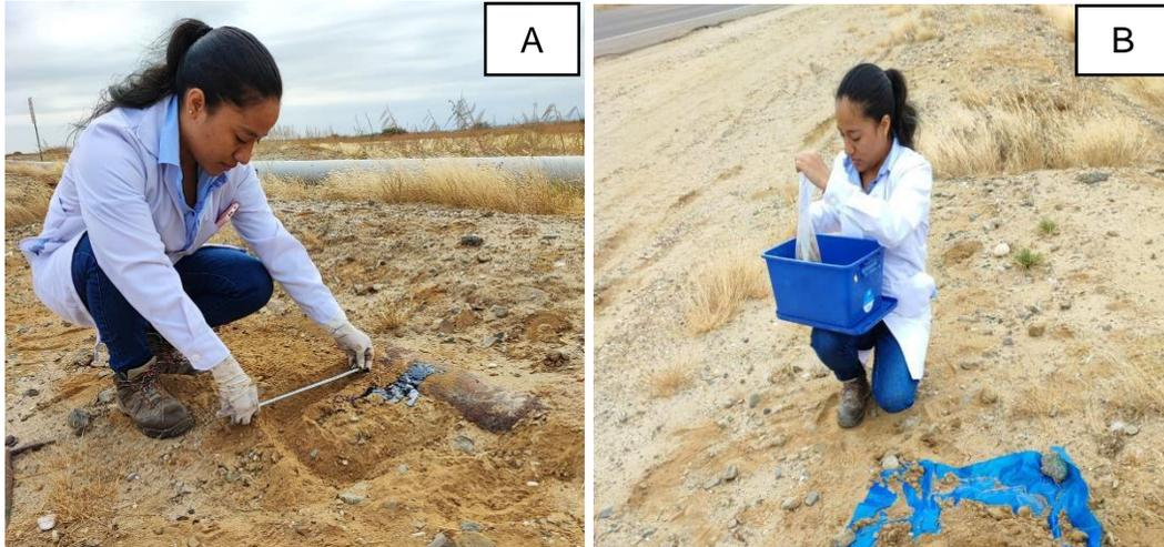
Figura 6. Proceso de muestreo del suelo contaminado con crudo de petróleo
