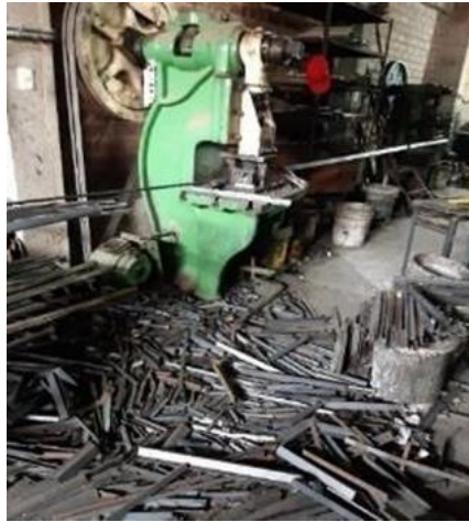
Ilustración 1 : Desorden , repuestos en mal estado. (Caídas - Trabajador propenso a contraer el tétano)
