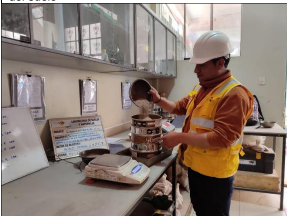
Fotografía 23. Ensayo de granulometría
