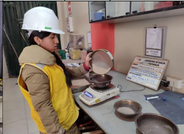
Fotografía 22. Ensayo de granulometría
