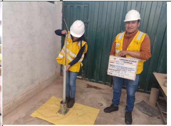
Fotografía 30. Compactación del suelo en el ensayo de Proctor
