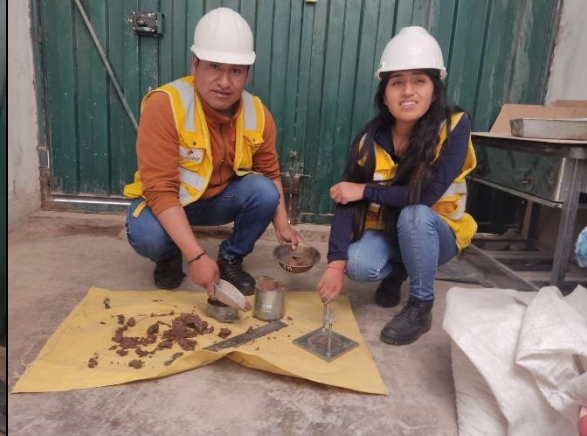
Fotografía 32. Extracción de material de la parte media del espécimen para la obtención del contenido de humedad
