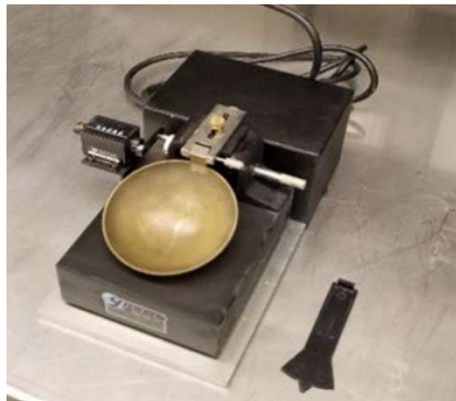
Figura 3. Cuchara de Casagrande
