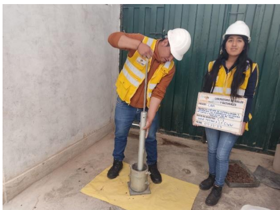
Figura 31. Compactación de las muestras
