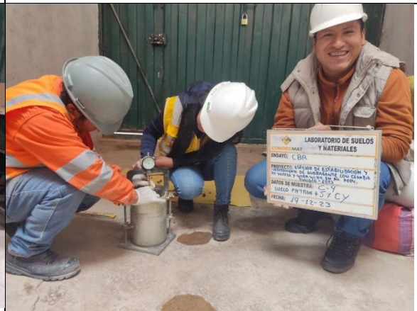
Fotografía 34. Calibración del dial para medir la expansión
