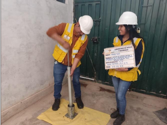
Fotografía 31. Compactación del suelo en el ensayo de Proctor
