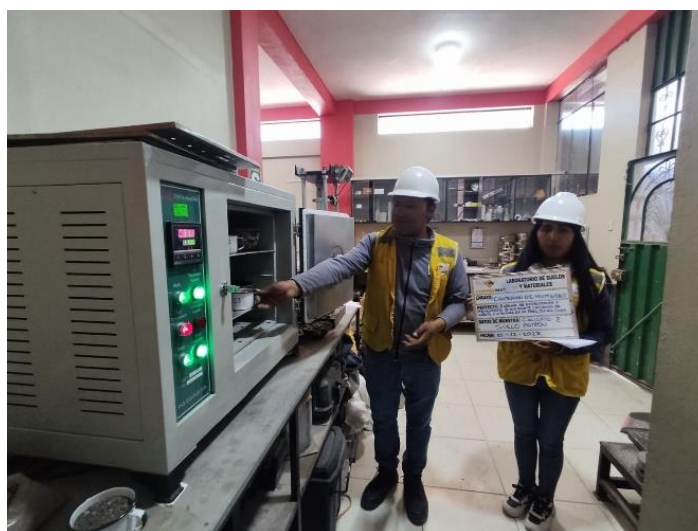
Figura 16. Ensayo de contenido de humedad
