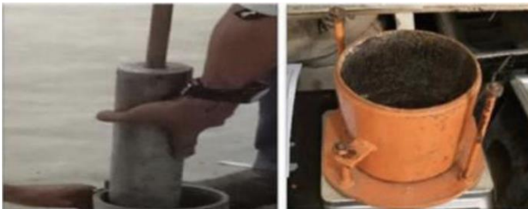
Figura 5. Ensayo de compactación Proctor
