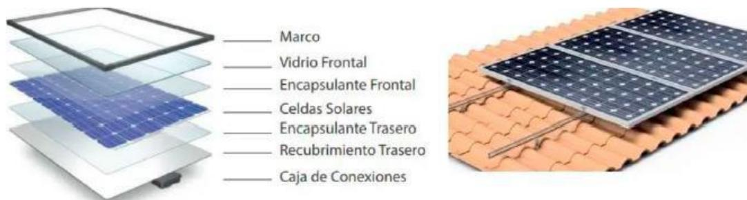
Nota. La figura muestra los componentes de un panel fotovoltaico, (OVACEN, 2019)
