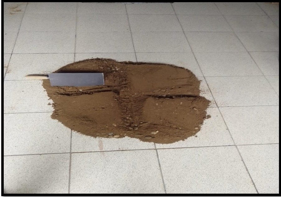
DESCRIPCIÓN: Cuarteo de la muestra del suelo.
