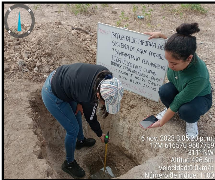
DESCRIPCIÓN: Cálculo para determinar la permeabilidad en calicata N°01.
