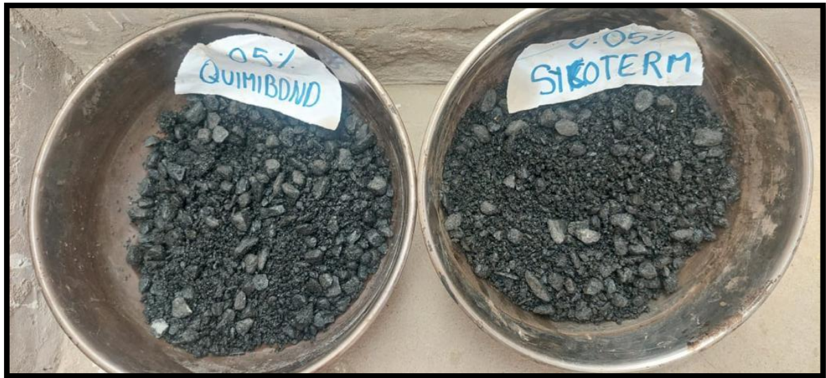
Foto N°9. Elección del aditivo adherente para el proceso del método Lottman
