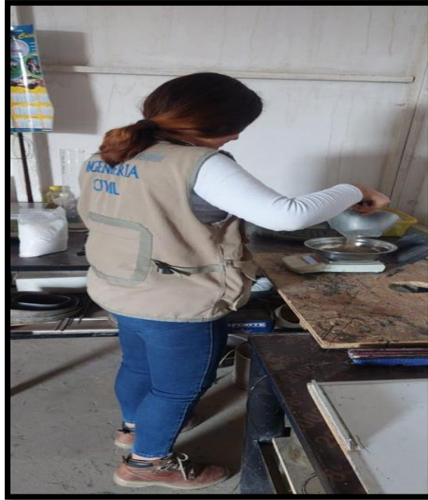
Foto N°7. Peso de material para el proceso de Diseño de Mezcla Asfáltica
