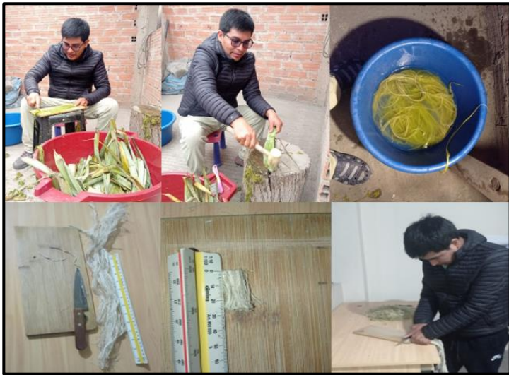
Fase 01: Calcinación del eucalipto y fabricación de fibras de piña
