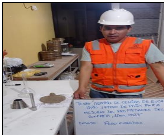
Figura 8. Gravedad específica y absorción en agregado fino
