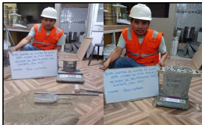
Figura 10. PUS de los agregados
