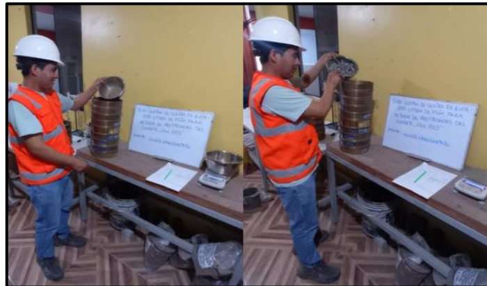
Figura 7. Granulometría de los agregados
