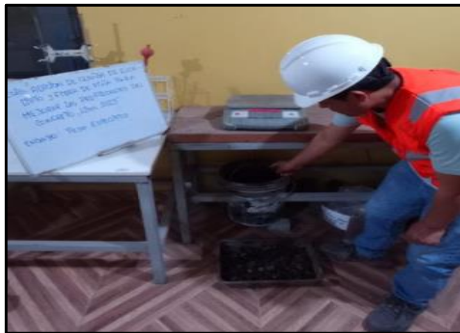
Figura 9. Gravedad específica y absorción en agregado grueso
