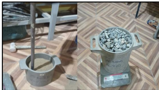
Figura 11. PUC de los agregados
