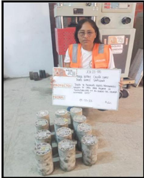
Figura 9: Rotura de probetas a los 7 días.
