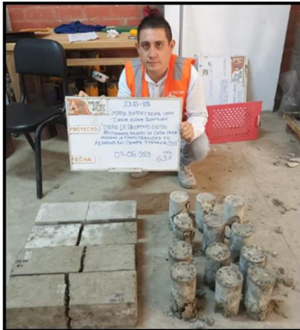
Figura 13: Rotura de probetas y flexión de vigas a los 28 días
