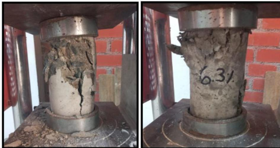
Figura 8: Rotura de probetas a los 7 días.
