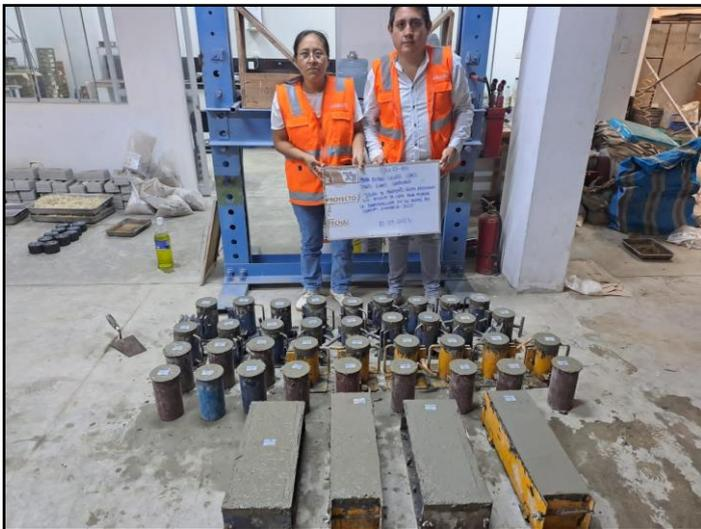
Probetas (36 und.) y Vigas (04)
