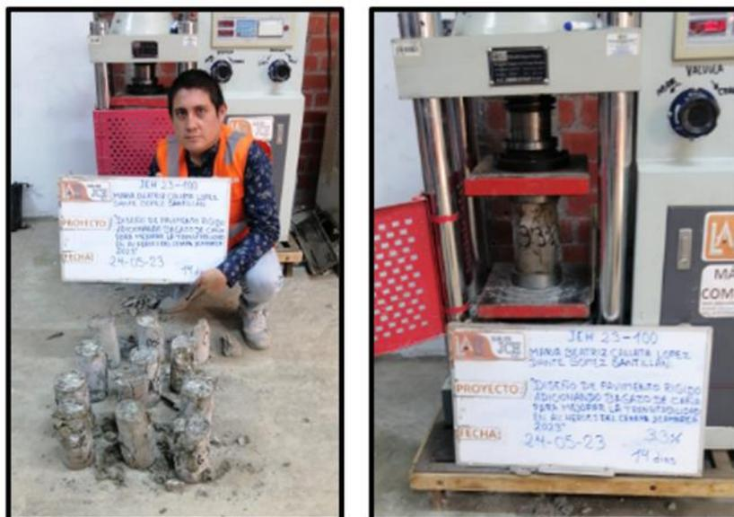
Figura 11. Rotura de probetas a los 14 días
