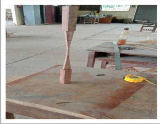
Muestras de probeta para tracción paralela
