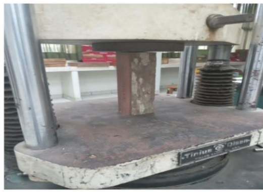
Ensayo de compresión paralela
