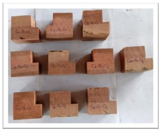
Muestra de probetas para corte o cizallamiento
