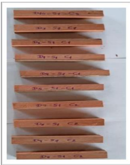
Muestra de probeta para densidad
