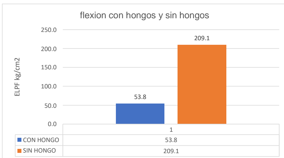
Figura 35: Comparación de los resultados en flexión
