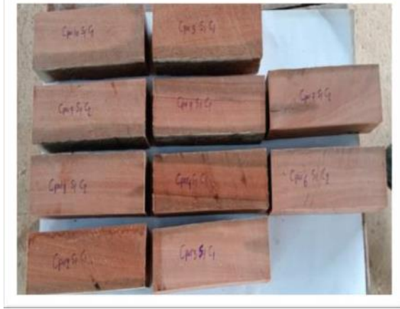
Muestra de probetas para compresión paralela
