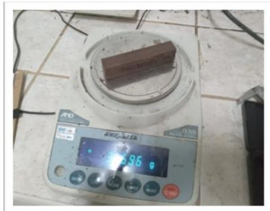
Pesado de probeta en balanza
