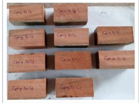
Muestra de probeta para compresión perpendicular
