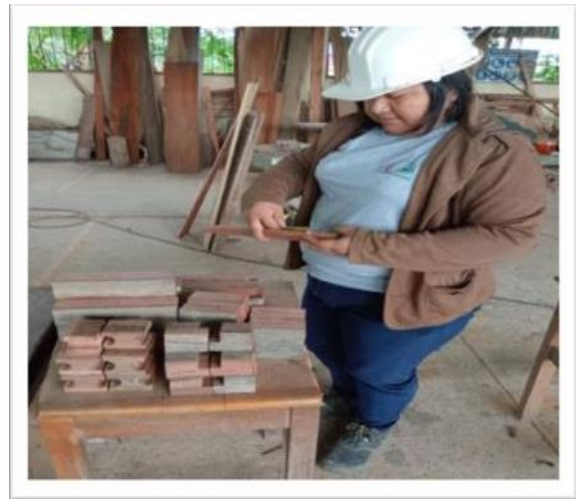
Verificando medidas a las probetas
