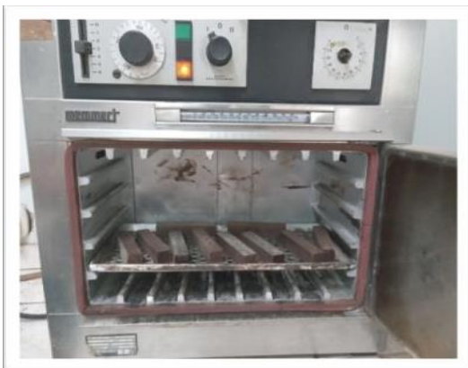
Secado al horno las probetas
