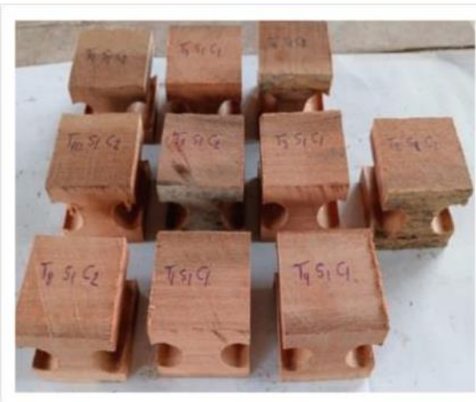
Muestra de probeta para tracción perpendicular
