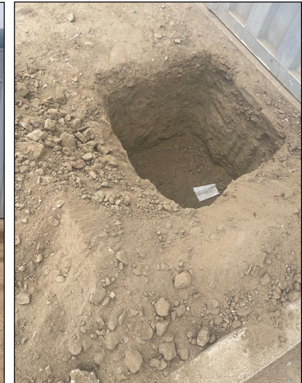
Fotografías N o 03, 04: TOMA DE MUESTRA DE CALICATA 02 DE 0.15 A 1.50M DE ESTRATO.
