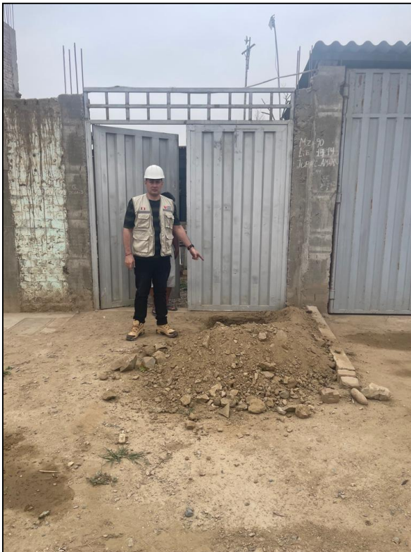
Fotografías N o 03, 04: TOMA DE MUESTRA DE CALICATA 02 DE 0.15 A 1.50M DE ESTRATO.
