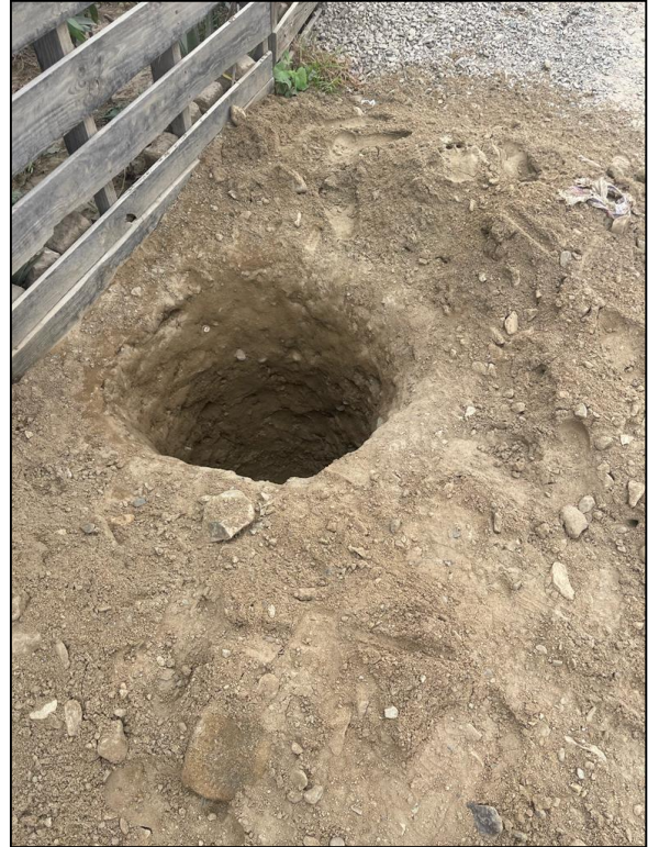
Fotografías N o 01, 02: TOMA DE MUESTRA DE CALICATA 01 DE 0.15 A 1.50M DE ESTRATO.
