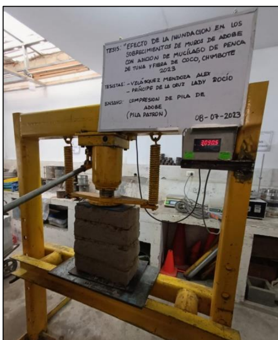
Figura 44 Resistencia a la compresión de pila SC muro patrón
