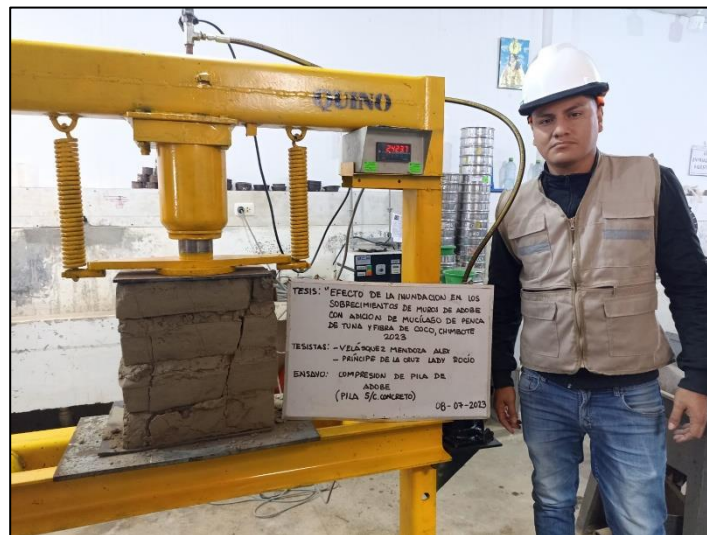
Figura 45 Resistencia a la compresión de pila SC de concreto
