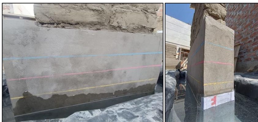
Figura 22 Ensayo de inundación en MST, 24hrs transcurridas
