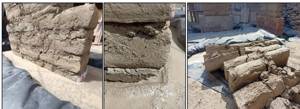
Figura 21 Volcadura del Muro Patrón MP.
