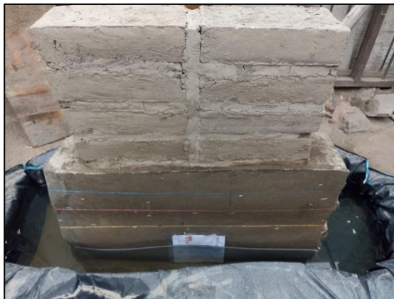
Figura 35 Día 15 del ensayo de inundación en MSC
