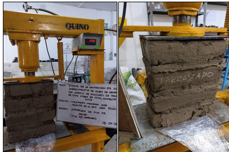
Figura 47 Resistencia a la compresión de pila SC tarrajado
