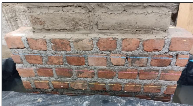
Figura 28 Ensayo de inundación en MSL, 24hrs transcurridas
