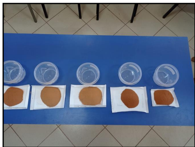
Fotografía 10 y 11: Submuestras activadas térmicamente para el proceso de remoción
