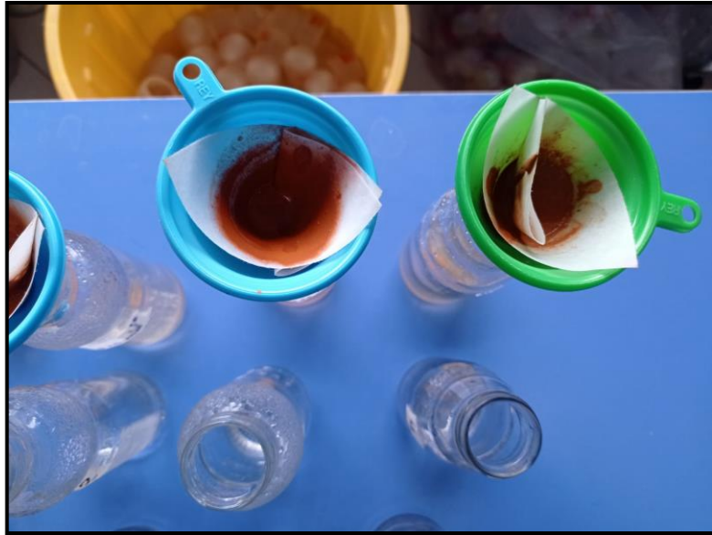
Fotografía 15: Filtrado de las submuestras para el análisis correspondiente.
