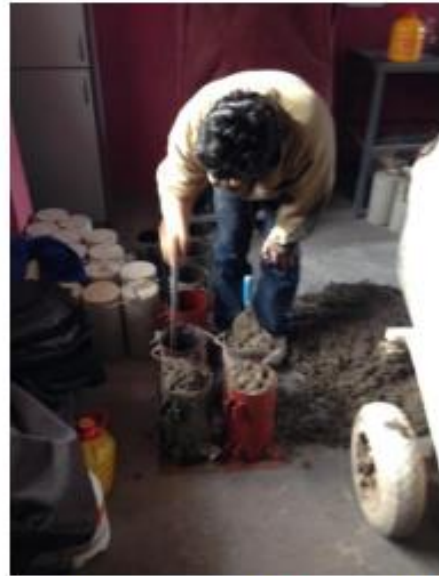
Colocación de la mezcla en los moldes (briquetas)
