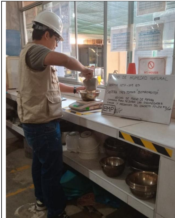
Figura N°05: Ensayo de humedad natural. Chiclayo. Fuente: Elaboración propia
