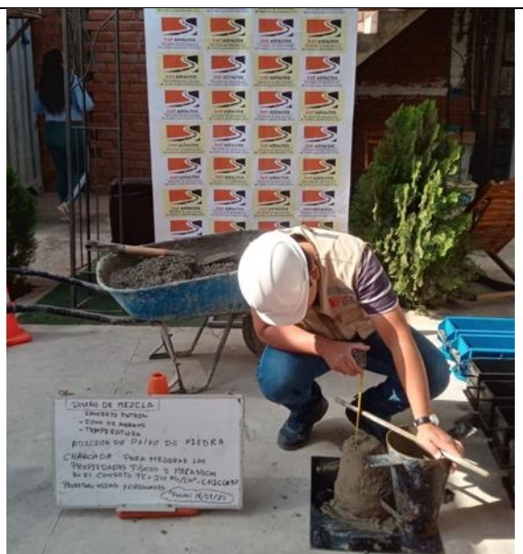
Figura N°08: Ensayo del cono de Abrams. Verificación de consistencia de mezcla. Chiclayo. Fuente: Elaboración propia
