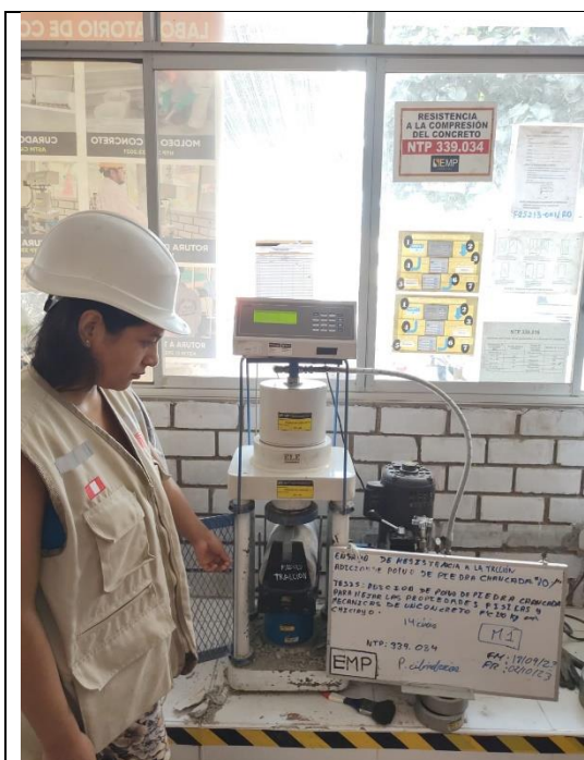
Figura N°15: Ensayo a tracción, con 10% de polvo de piedra chancada. Chiclayo. Fuente: Elaboración propia
