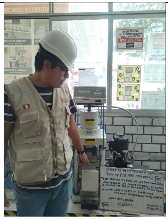
Figura N°12: Ensayo de resistencia a la flexión, con 5 % de polvo de piedra chancada. Chiclayo. Fuente: Elaboración propia
