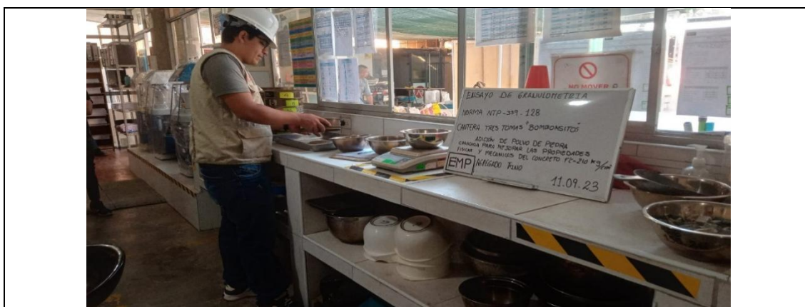
Figura N°04: Ensayo de granulometría agregado fino. Chiclayo. Fuente: Elaboración propia
