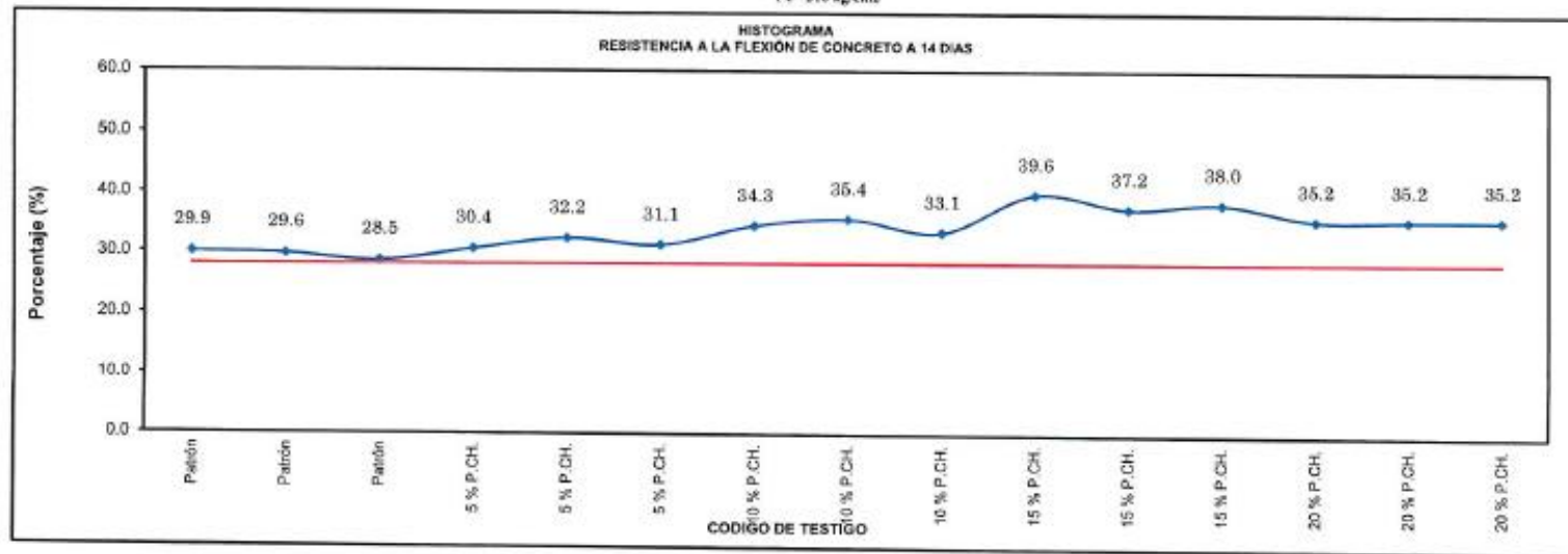
CUADRO ESTADISTICO DE RESISTENCIA A LA FLEXIÓN DEL CONCRETO f'c= 210 \text{ kg/cm}^2
