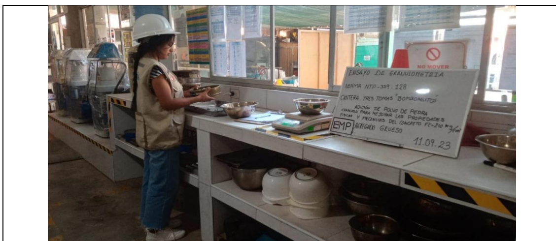
Figura N°03: Ensayo de granulometría agregado grueso. Chiclayo. Fuente: Elaboración propia
