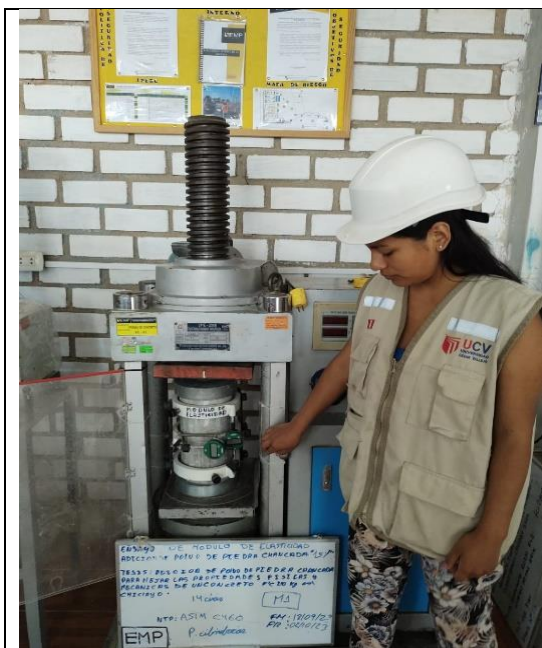
Figura N°25: Ensayo de módulo de elasticidad con el 15% de polvo de piedra chancada. Chiclayo. Fuente: Elaboración propia
