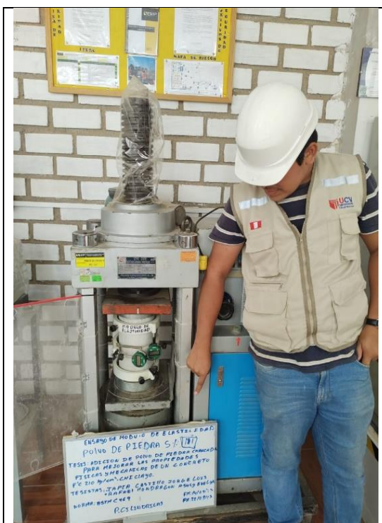
Figura N°27: Ensayo de módulo de elasticidad con el 5% de polvo de piedra chancada. Chiclayo. Fuente: Elaboración propia
