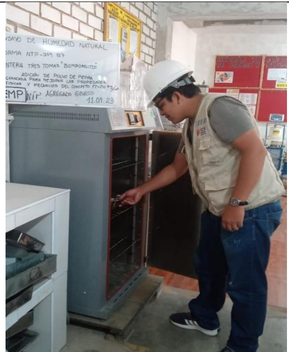
Figura N°06: Ensayo de Humedad Natural. Chiclayo. Fuente: Elaboración propia
