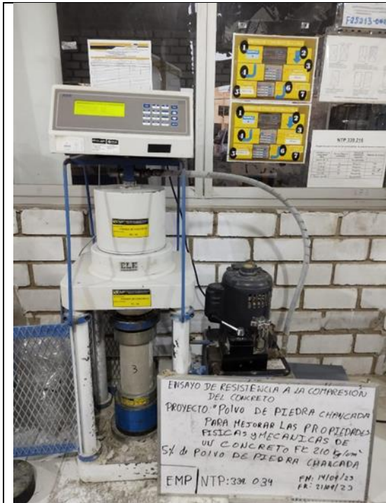
Figura N°21: Resistencia a la compresión, con 5% de polvo de piedra chancada. Chiclayo. Fuente: Elaboración propia
