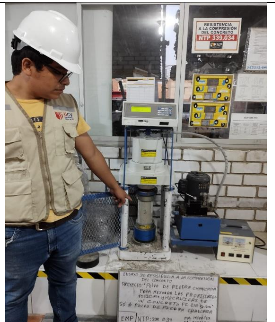
Figura N°20: Resistencia a la compresión, con 5% de polvo de piedra chancada. Chiclayo. Fuente: Elaboración propia
