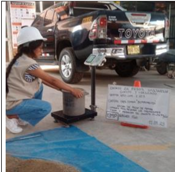
Figura N°09: Ensayos de pesos unitarios sueltos y varillados. Chiclayo. Fuente: Elaboración propia
