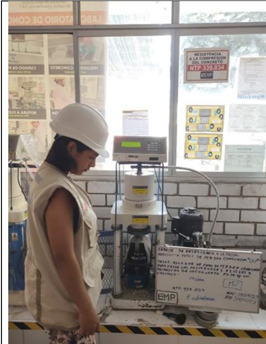
Figura N°17: Resistencia a la tracción, con 15% de polvo de piedra chancada. Chiclayo. Fuente: Elaboración propia
