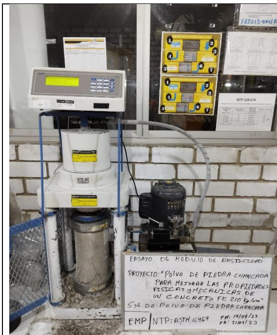
Figura N°23: Ensayo de módulo de elasticidad. Chiclayo. Fuente: Elaboración propia
