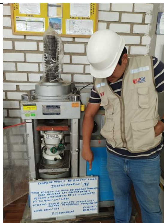
Figura N°28: Ensayo de módulo de elasticidad de diseño patrón. Chiclayo. Fuente: Elaboración propia
