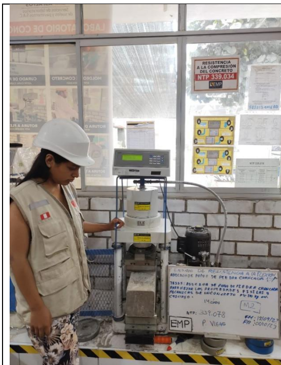
Figura N°11: Ensayo de resistencia a la flexión, con 15 % de polvo de piedra chancada. Chiclayo. Fuente: Elaboración propia
