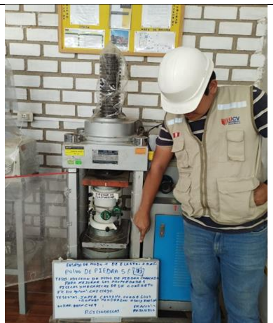
Figura N°26: Ensayo de módulo de elasticidad con el 5% de polvo de piedra chancada. Chiclayo. Fuente: Elaboración propia
