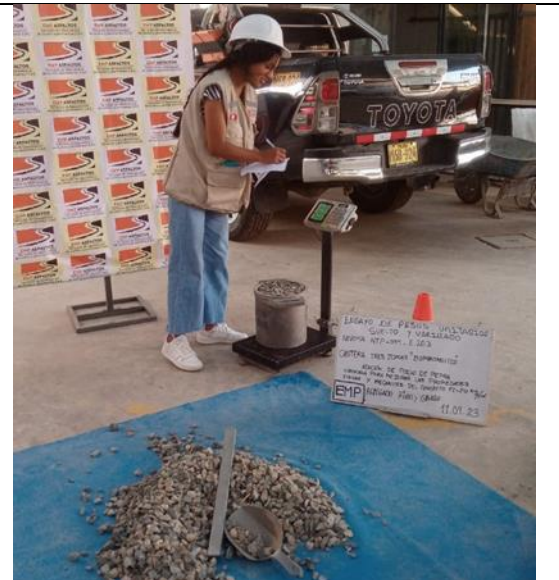
Figura N°10: Ensayos de pesos unitarios sueltos y varillados. Chiclayo. Fuente: Elaboración propia
