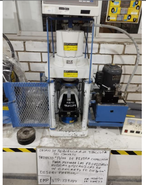
Figura N°18: Resistencia a la compresión de diseño patrón. Chiclayo. Fuente: Elaboración propia
