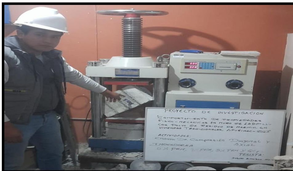
Figura 29: Equipo que permite llevar a cabo los ensayos de resistencia a la compresión diagonal en murete
