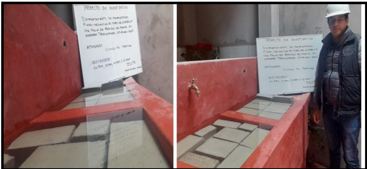
Curado ladrillos con adición del polvillo de residuo de mármol según los indicadores de 0%PRM, 4%PRM, 5%PRM y 6%PRM.
