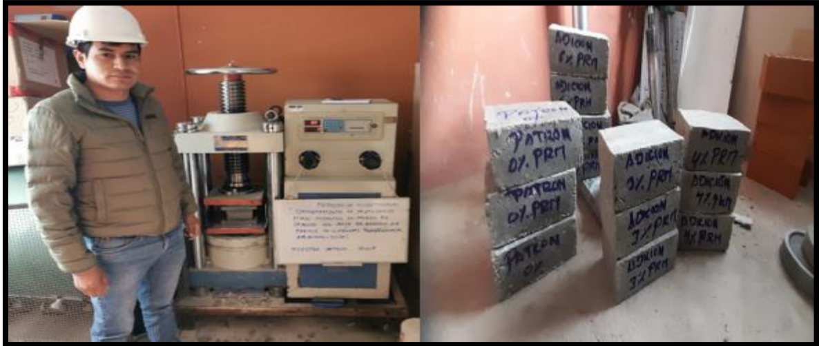
Figura 20. En la izquierda equipo para ejecutar ensayo de resistencias a compresión; en la derecha se muestra los especímenes correspondientes.
