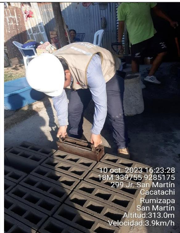
Desmontado de los bloques de concreto
