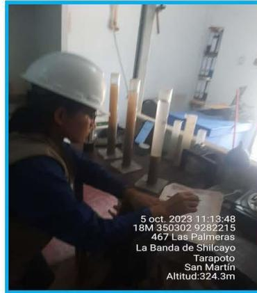
**ENSAYO DE EQUIVALENTE DE ARENA**
