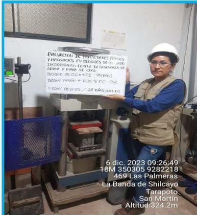
**REALIZANDO LA VERIFICACION DE LA RESISTENCIA DE LOS BLOQUES. DE CONCRETO F'c 140 kg/cm<sup>2</sup>**
