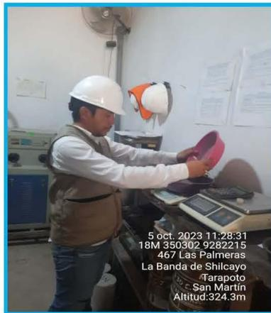
**REALIZANDO EL ANALISIS GRANULOMETRICO DE LA COMBINACION DE AGREGADOS (ARENA NATURAL Y ARENA TRITURADA).**
