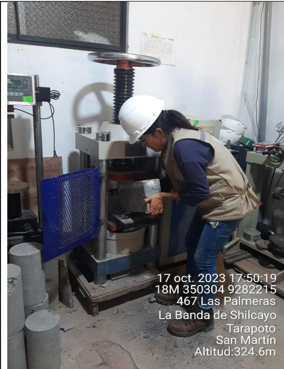
Colocación del Bloque en la prensa.
