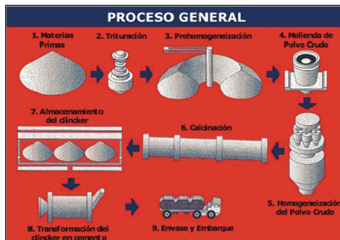
*Figura 07. Proceso de fabricación de cemento, extraído de (ClimateScience 2022).*
