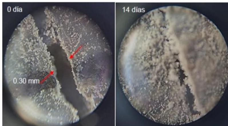
**Figura 41. Comparación de fisuras en concreto**
