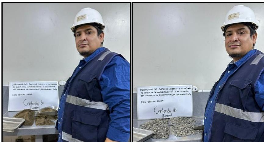
Figura 17. Cuarteo del agregado fino y grueso
