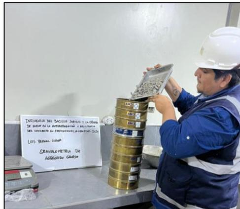
Figura 22. Granulometría de Agregado Grueso
