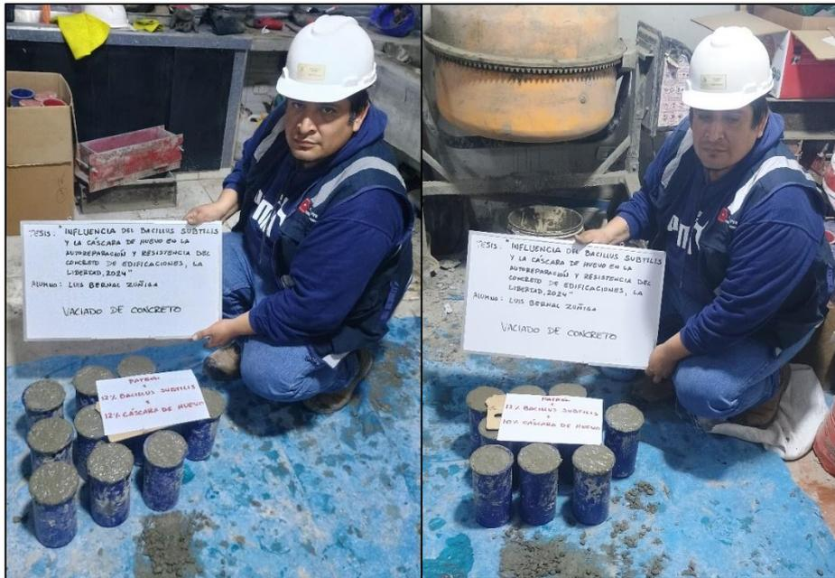
Figura 33. Elaboración de probetas cilíndricas
