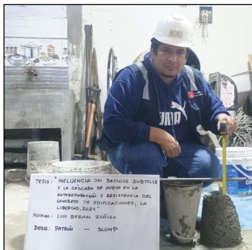
Figura 32. Prueba de Asentamiento (Slump)
