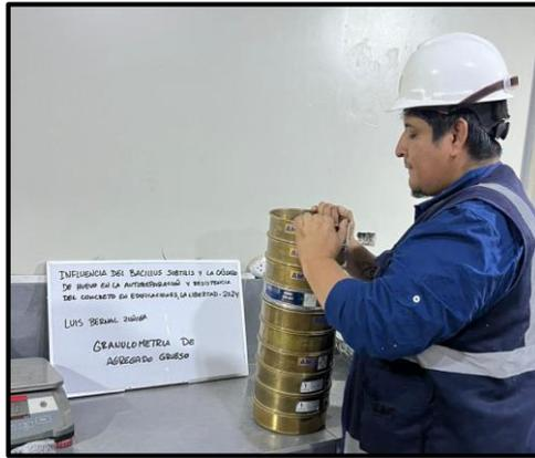
Figura 18. Granulometría de Agregado Fino
