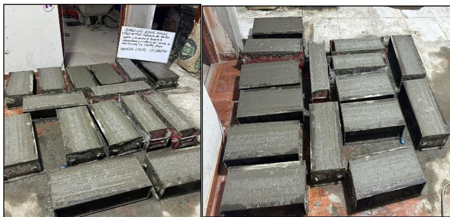
Figura 39. Vigas prismáticas fabricadas
