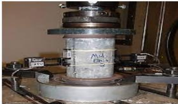
Figura 7. Ensayo de resistencia a la compresión.
