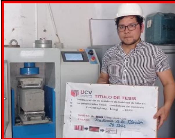
Ensayos de Resistencia a la flexión
