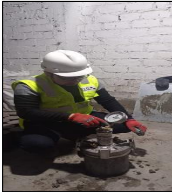
Figura 32. Ensayo de contenido de aire
