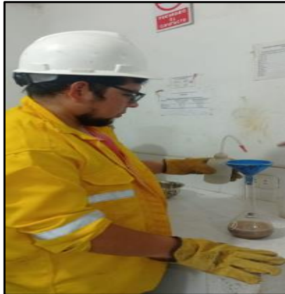
Figura 27. Ensayo de gravedad especifica del AF
