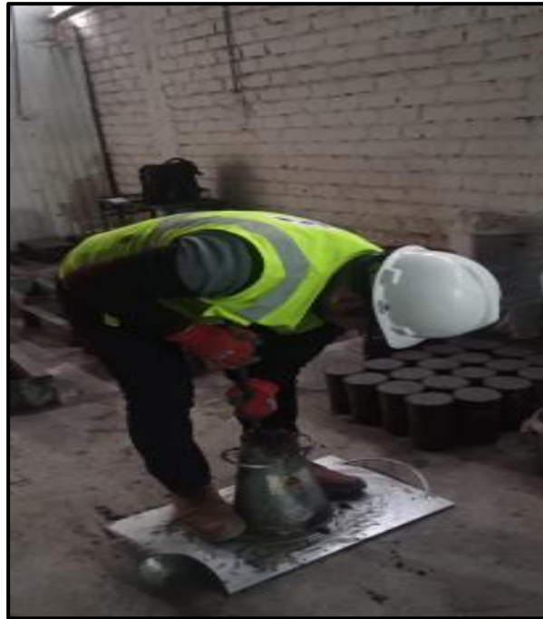
Figura 29. Asentamiento y consistencia del C°
