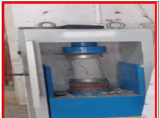
Probetas rotas en resistencia en compresión
