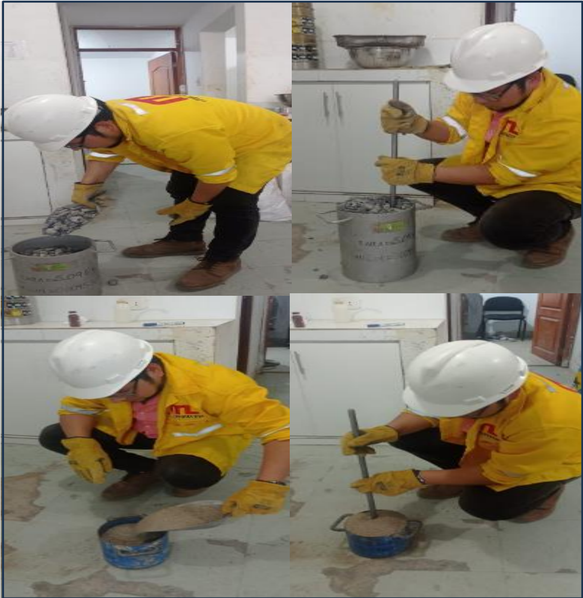
Figura 26. Ensayo de peso unitario del AG y AF
