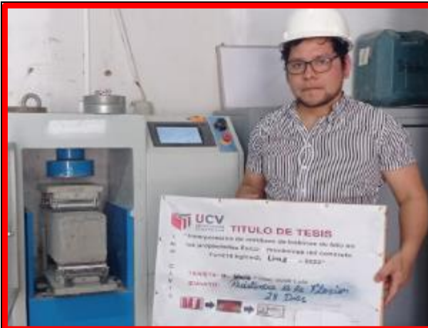
Ensayos de Resistencia a la flexión
