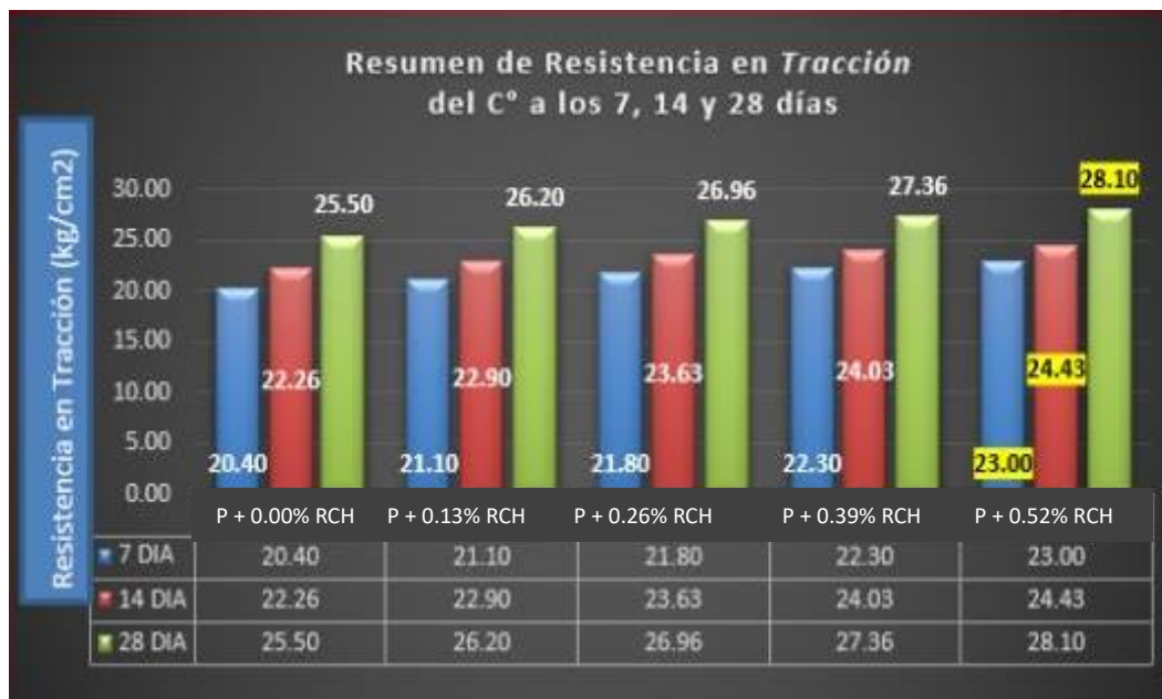
Figura 42. resumen a los 7, 14 y 28 días de resistencia a la tracción
