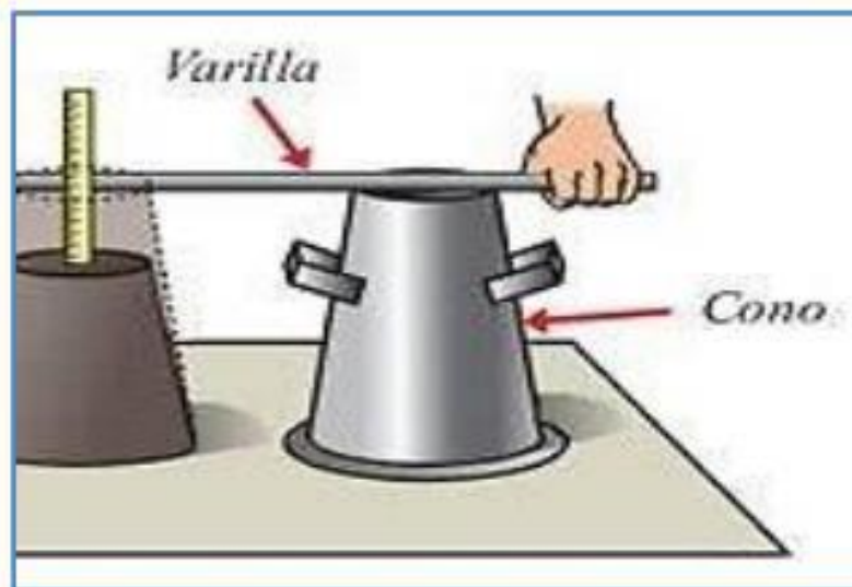
Figura 2. Procedimiento del Slump.
