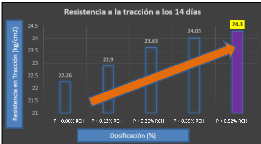
Figura 40. Gráfico de resistencia a la tracción a los 14 días
