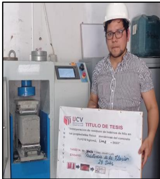
Figura 43. Ensayos de Resistencia a la flexión
