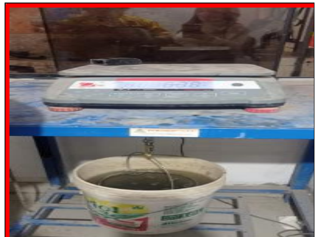
. Ensayo de gravedad específica del AG
