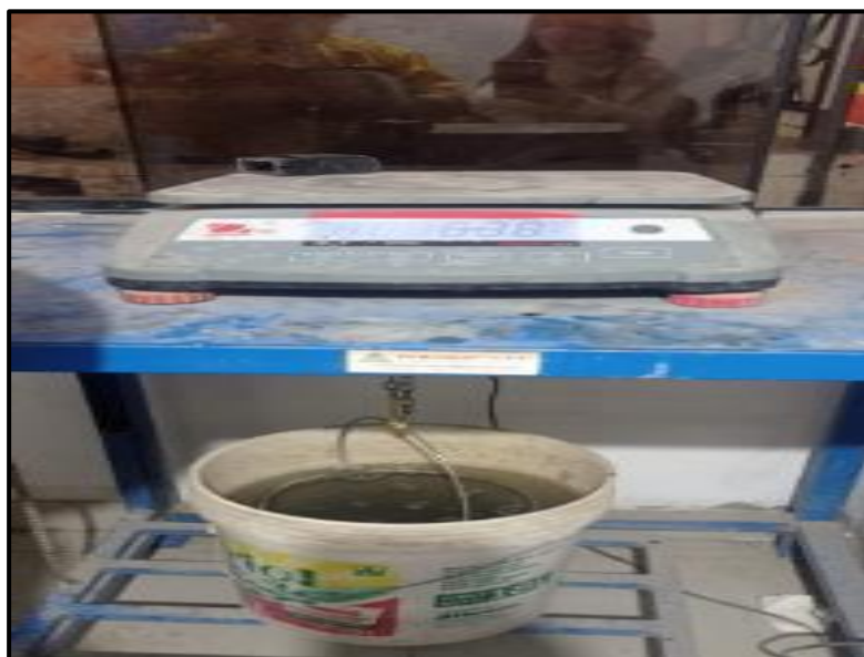
Figura 28. Gravedad específica del AG
