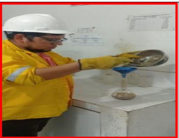
Ensayo de gravedad específica AF
