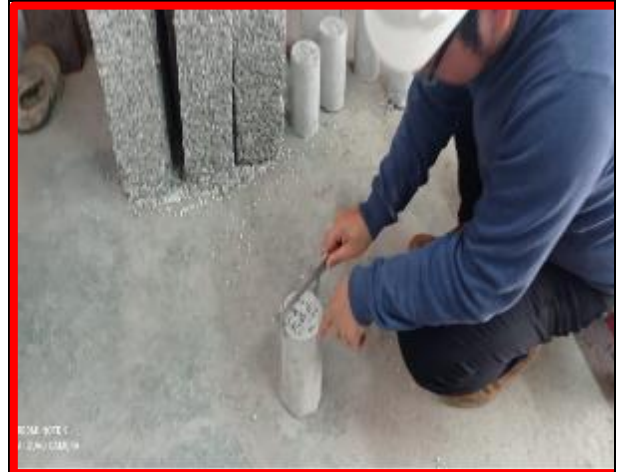
Medición de diámetro y altura de probeta
