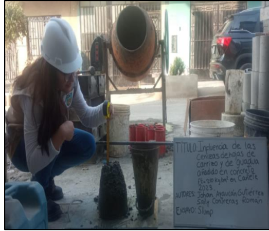
Ensayo de asentamiento.
