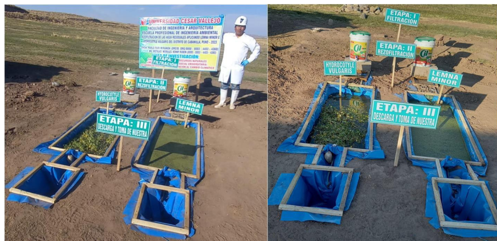
Figura 3. Rizofiltración ( hydrocotyle vulgaris y lemna minor )
