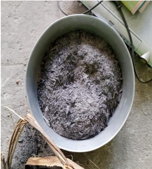
Comparación de texturas de la ceniza calcinada artesanalmente y la ceniza con segunda calcinación a 700 °C
