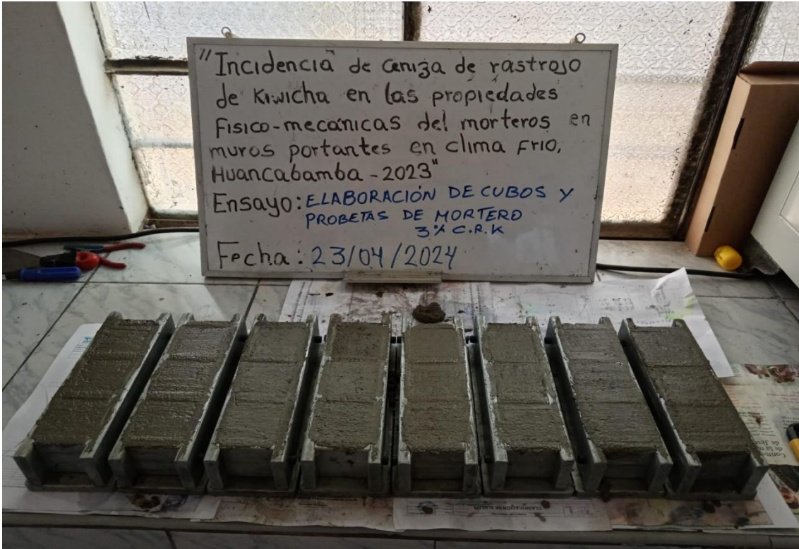
Elaboración de especímenes cúbicos de 5cm de lado con adición de 3% de ceniza de rastrojo de kwacha.
