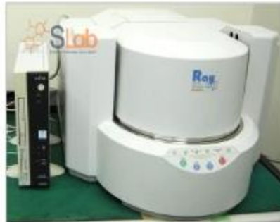
FOTO N°1: EQUIPO DE FLUORESCENCIA DE RAYOS X
