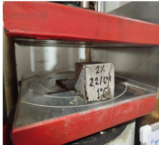
Figura 8: Rotura de especímenes cúbicos de 5cm de lado
