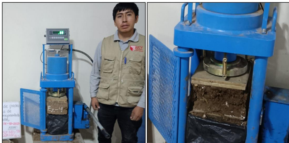
Anexo 19: Ensayo a compresión del adobe (10% PCT - 10% CCM) a los 14 días.
