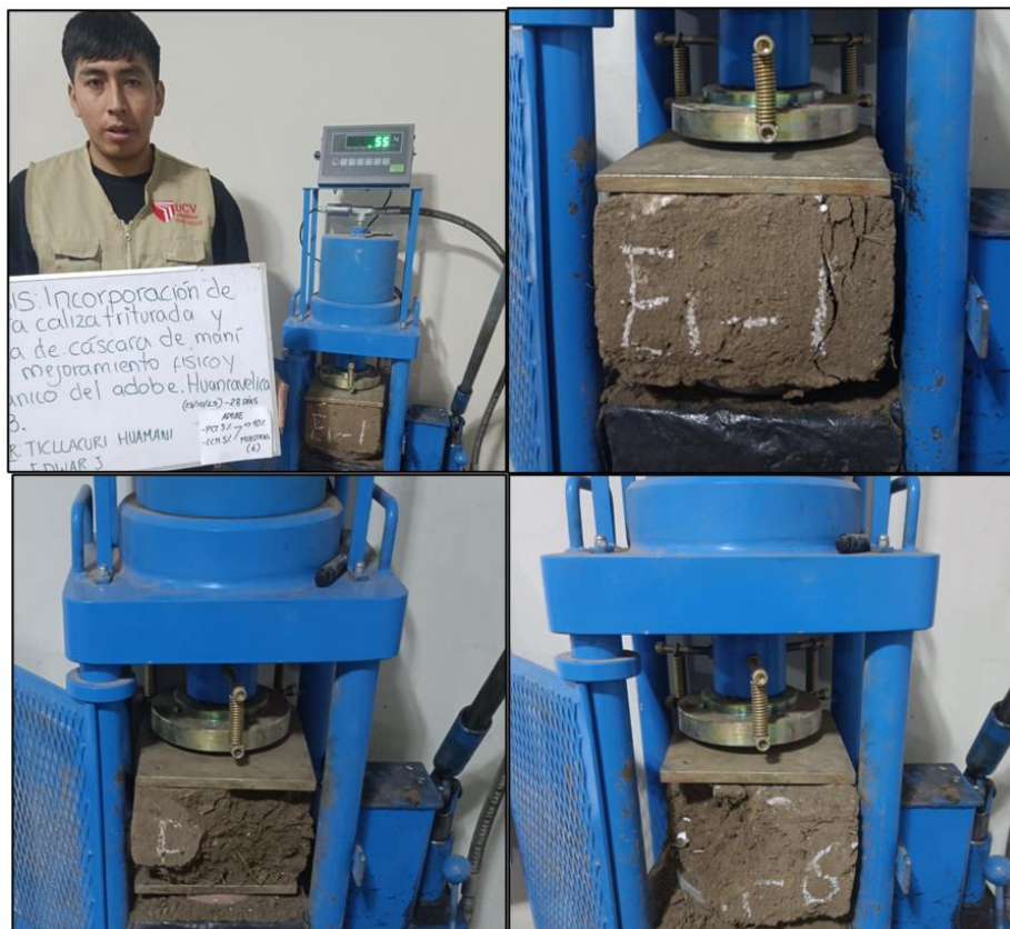
Anexo 26: Ensayo a compresión del adobe (5% PCT - 5% CCM) a los 28 días.
