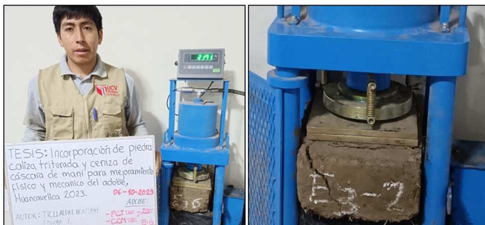
Anexo 19: Ensayo a compresión del adobe (10% PCT - 10% CCM) a los 14 días.
