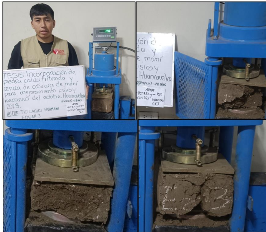
Anexo 28: Ensayo a compresión del adobe (10% PCT - 10% CCM) a los 28 días.
