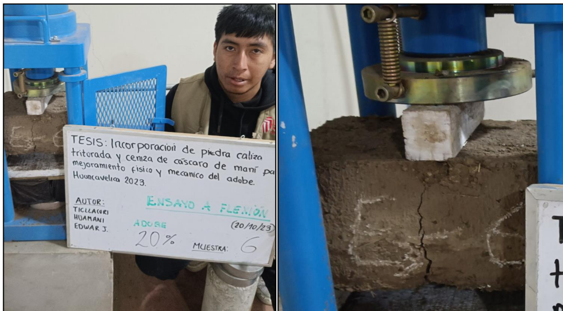
Anexo 37: Ensayo a flexión del adobe (10% PCT - 10% CCM) a los 28 días.
