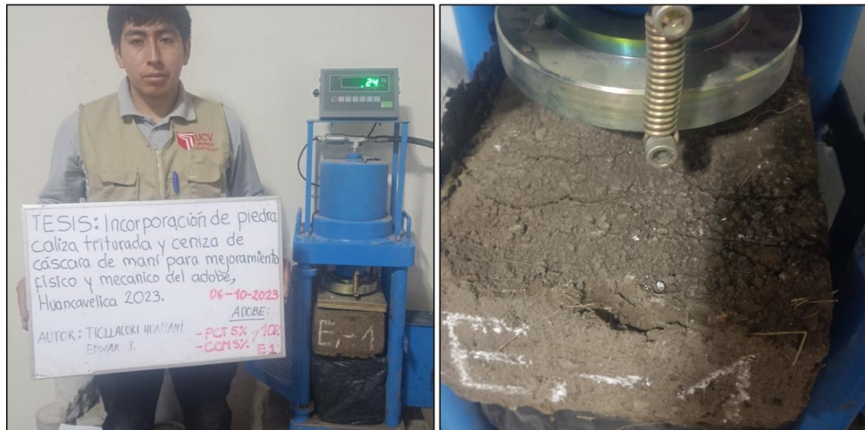
Anexo 18: Ensayo a compresión del adobe (7.5% PCT - 7.5% CCM) a los 14 días.
