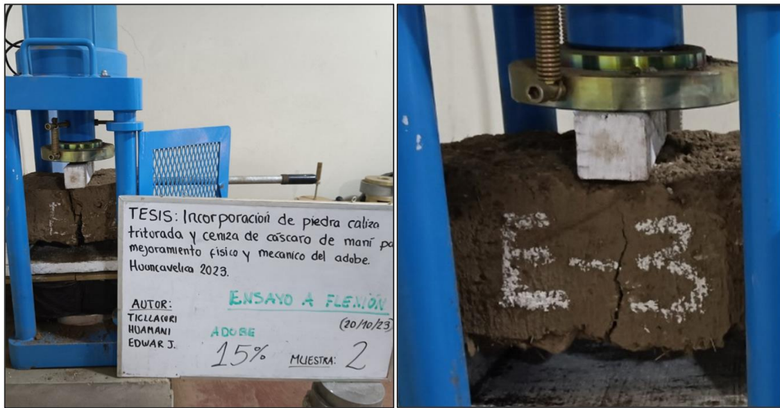
Anexo 37: Ensayo a flexión del adobe (10% PCT - 10% CCM) a los 28 días.
