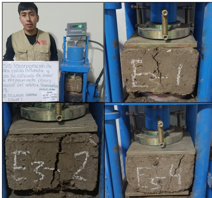
Anexo 28: Ensayo a compresión del adobe (10% PCT - 10% CCM) a los 28 días.
