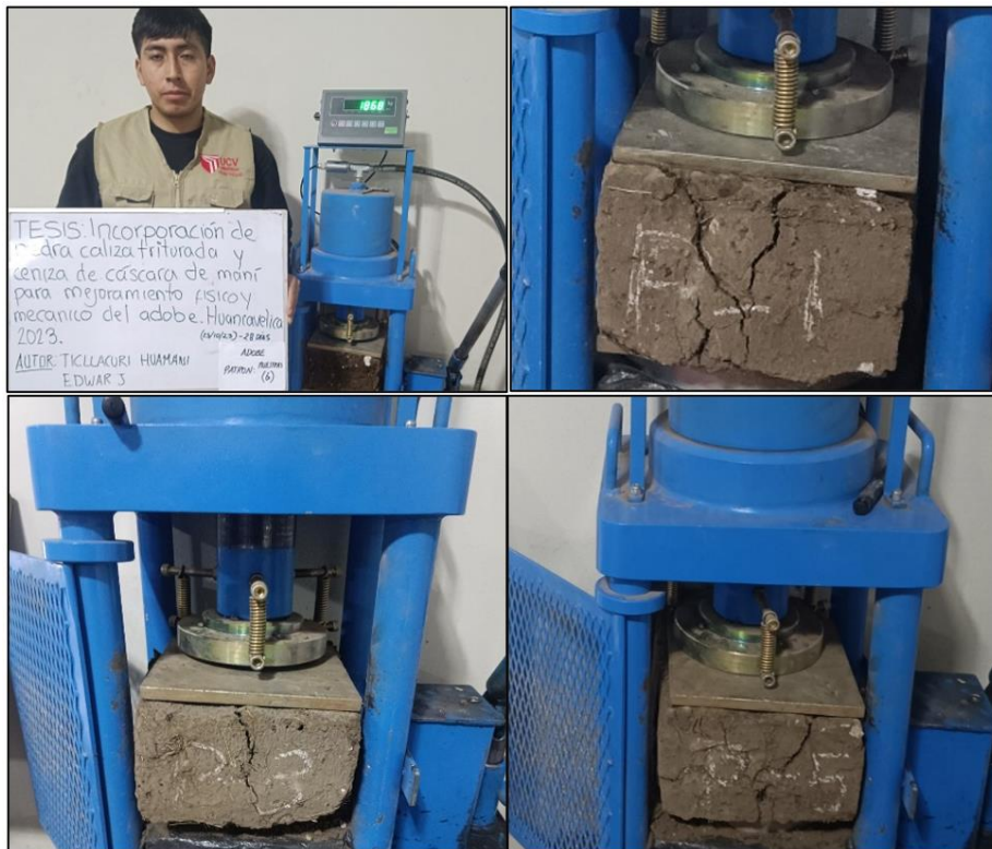
Anexo 26: Ensayo a compresión del adobe (5% PCT - 5% CCM) a los 28 días.
