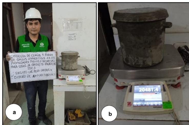
Figura 24: (a) y(b) Peso unitario del diseño de 1.0%CGD + 0.5%FGD.
