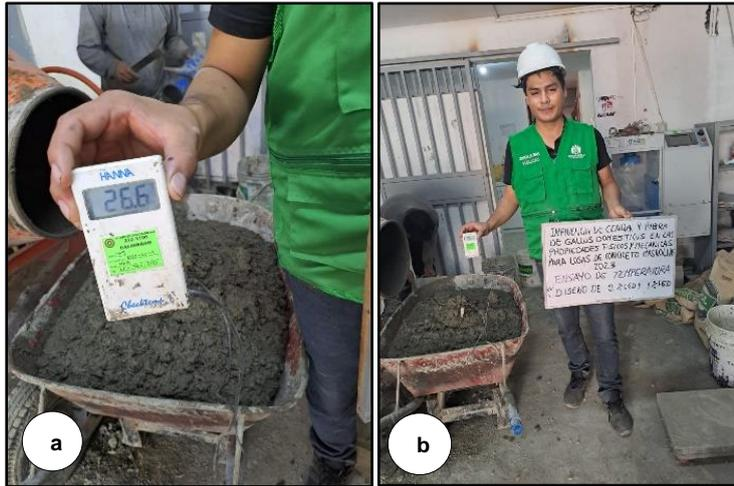
Figura 17: (a) y(b) Temperatura del diseño de 2.0%CGD + 1.0%FGD.
