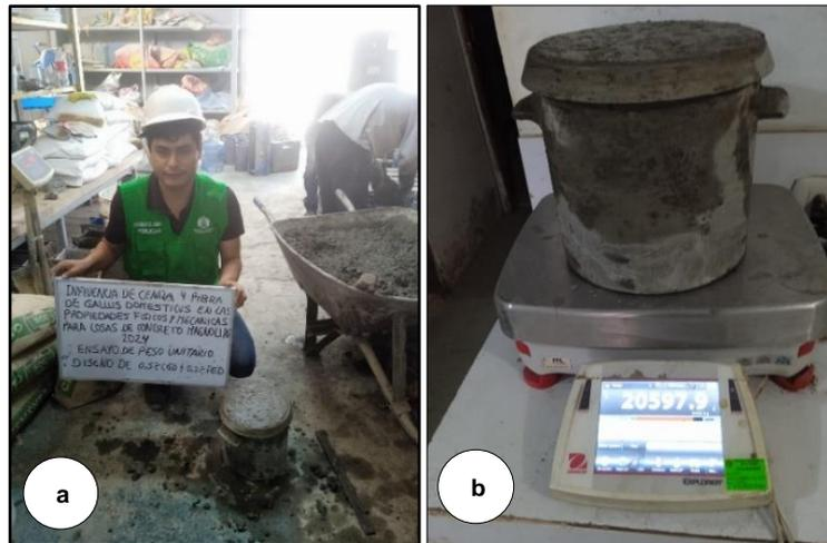
Figura 23: (a) y(b) Peso unitario de diseño de 0.5%CGD + 0.2%FGD.
