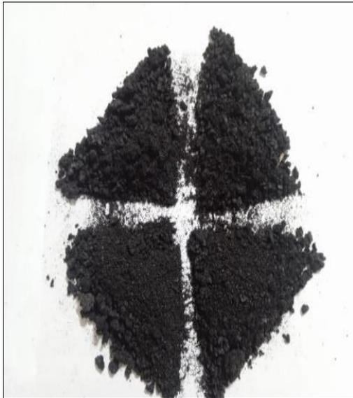
Fotografía 5. Ilustración de las cenizas obtenidas de la calcinación manual
