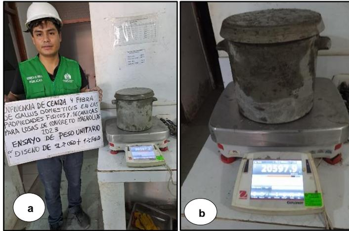
Figura 25: (a) y(b) Peso unitario del diseño de 2.0%CGD + 1.0%FGD.
