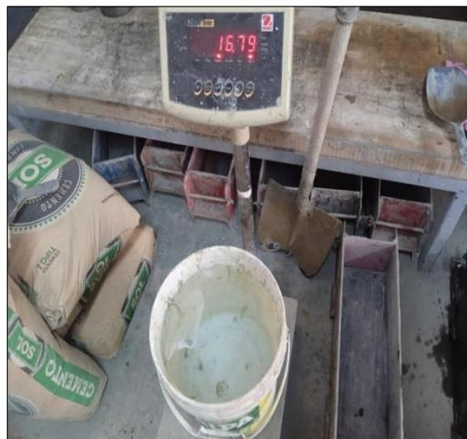
Fotografía 16. Pesando el agua para preparar el concreto
