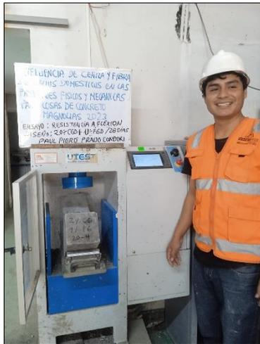
Fotografía 29. Ensayo de flexión de las vigas
