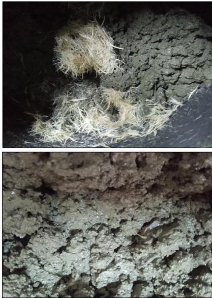
Fotografía 21. Momento donde la ceniza y fibra se mezclan con el concreto
