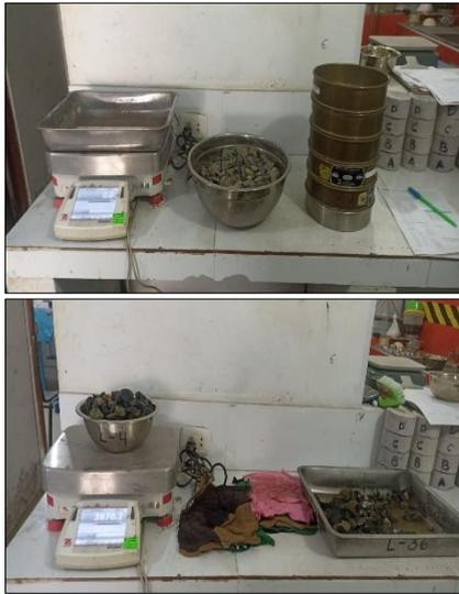
Fotografía 13. Ensayo de peso específico del agregado grueso
