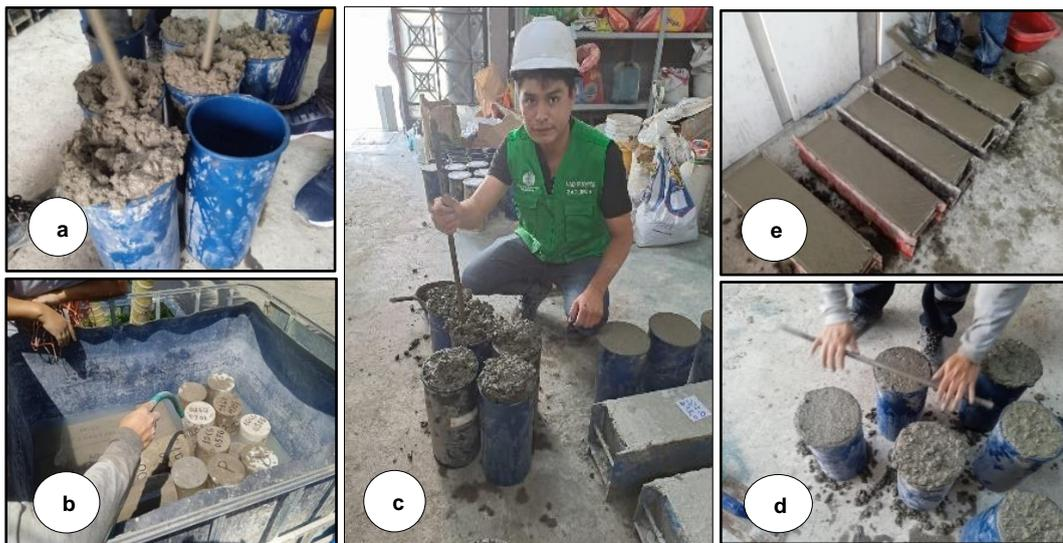
Figura 26: (a), (b), (c), (d) y (e) Elaboración y curado de las probetas y vigas
