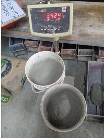
Fotografía 17. Pesando el cemento para preparar el concreto
