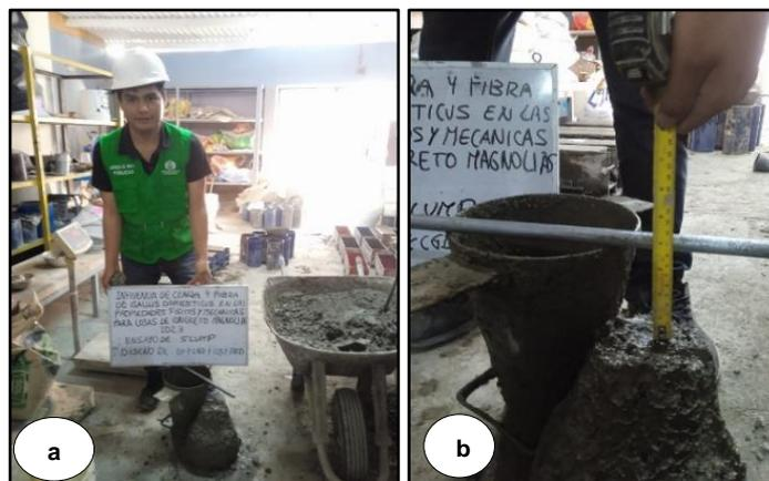
Figura 20: (a) y (b) SLUMP del diseño de 1.0%CGD + 0.5%FGD.
