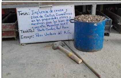
Fotografía 11. Ensayo de peso unitario de los agregados
