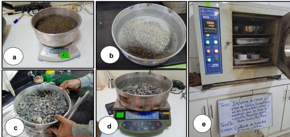
**Figura 7:** ensayo del contenido de humedad de AF y AG
