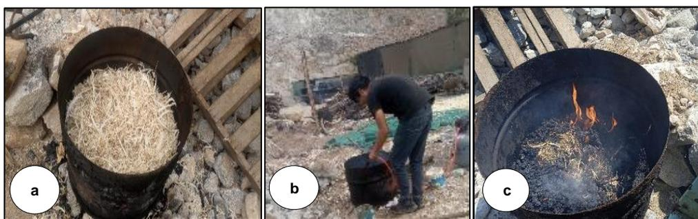
**Figura 5:** Proceso de calcinación manual de las plumas
