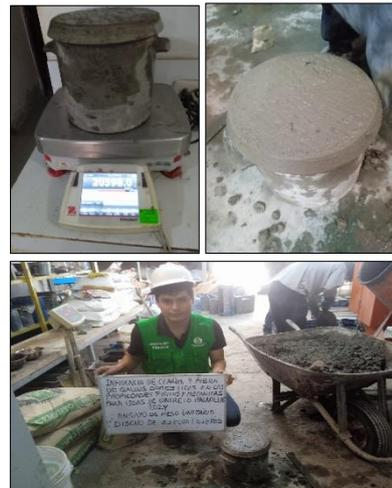
Fotografía 24. Ensayo del peso unitario del concreto
