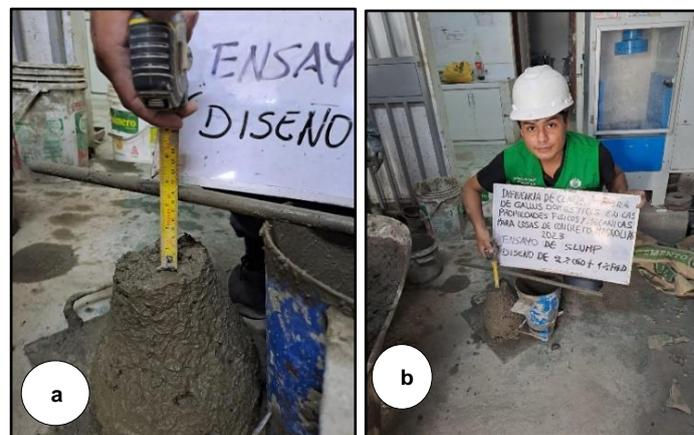
Figura 21: (a) y(b) SLUMP del diseño de 2.0%CGD + 1.0%FGD.
