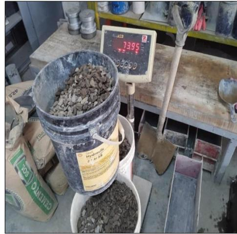
Fotografía 14. Pesando el agregado grueso para preparar el concreto
