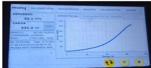
Fotografía 28. Ensayo a compresión de las probetas
