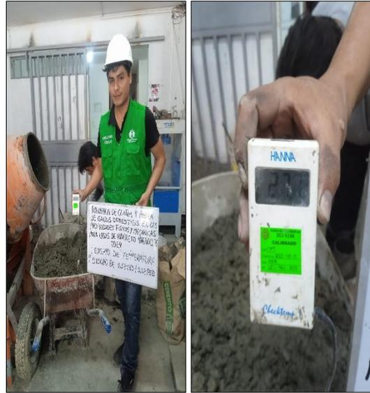
Fotografía 22. Ensayo de temperatura del concreto
