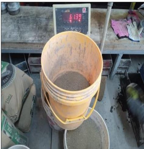
Fotografía 15. Pesando el agregado fino para preparar el concreto
