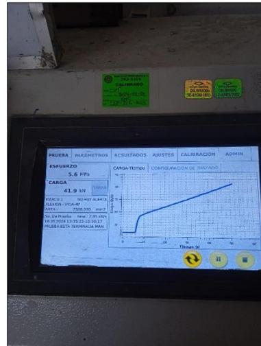
Fotografía 30. La pantalla de la maquina marca la fuerza aplicada a la viga
