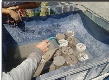
Fotografía 27. Curado de las probetas y vigas
