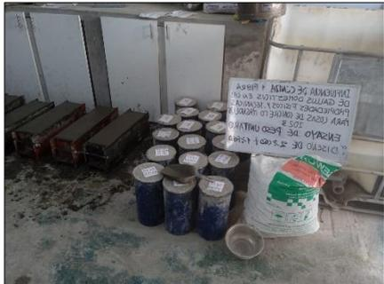
Fotografía 25. Preparación de las probetas
