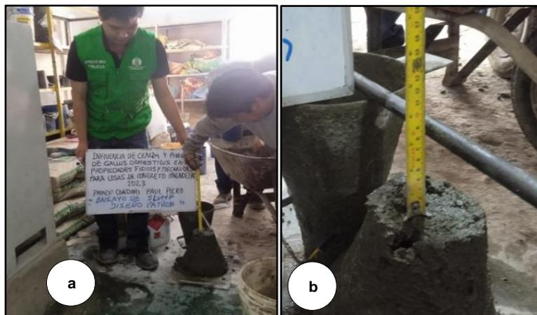
Figura 18: (a) y (b) SLUMP del diseño de patrón.
