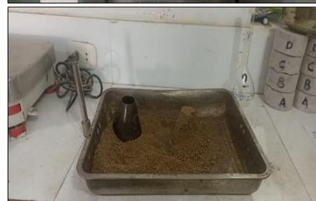
Fotografía 12. Ensayo de peso específico del agregado fino
