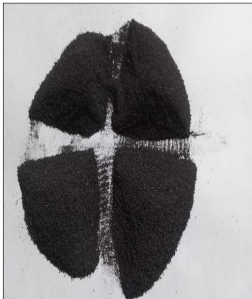
Fotografía 7. La ceniza después de la calcinación en la mufla
