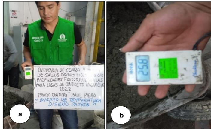
Figura 14: (a) y (b) Temperatura del diseño patrón.
