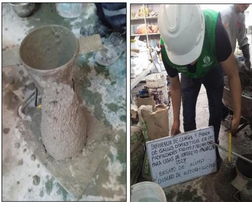
Fotografía 23. Ensayo del slump del concreto
