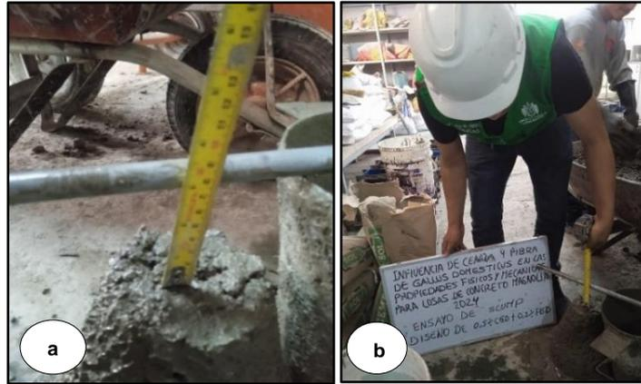
Figura 19: (a) y(b) SLUMP del diseño de 0.5%CGD + 0.2%FGD.
