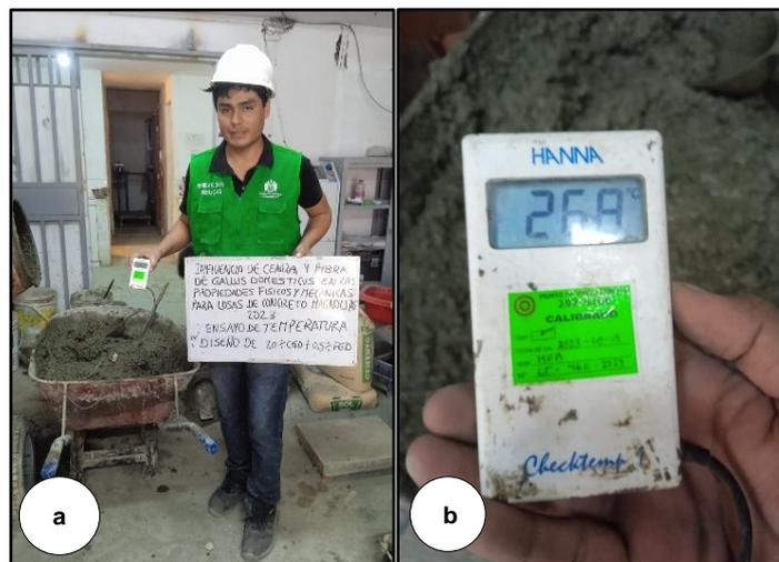
Figura 16: (a) y(b) Temperatura del diseño de 1.0%CGD + 0.5%FGD.
