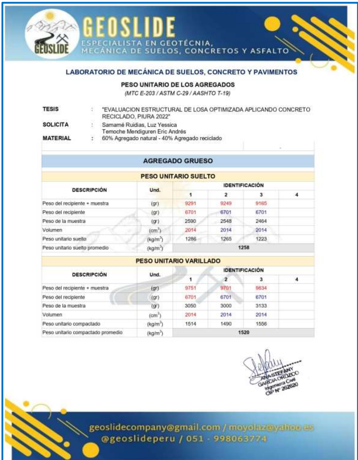
Figura 5. Ensayo de Peso Unitario del 60% de agregado natural - 40% agregado reciclado.
