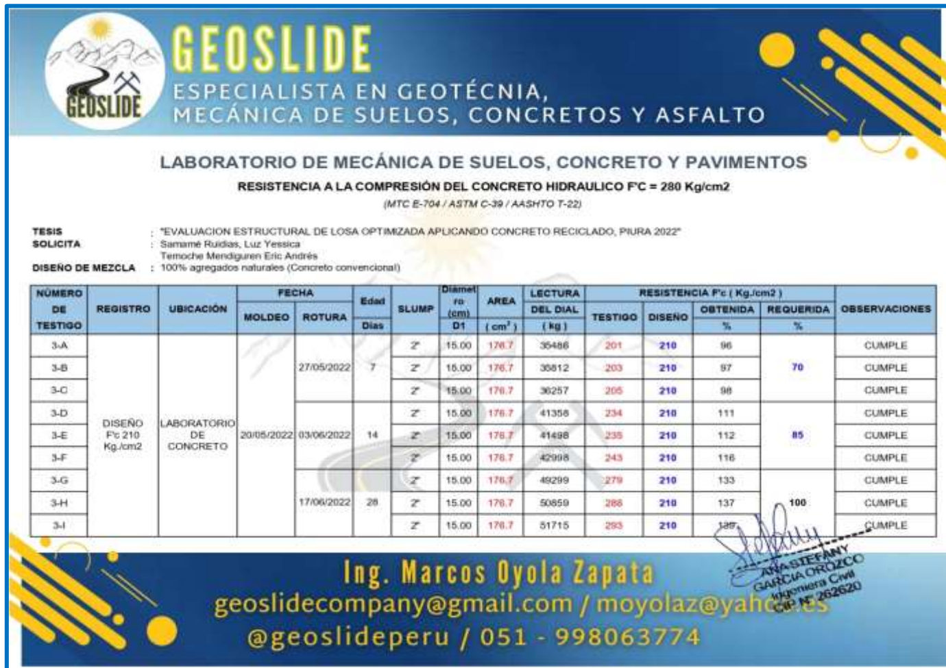
Figura 22. Ensayo de resistencia de concreto con 100% de agregado natural (Concreto convencional)
