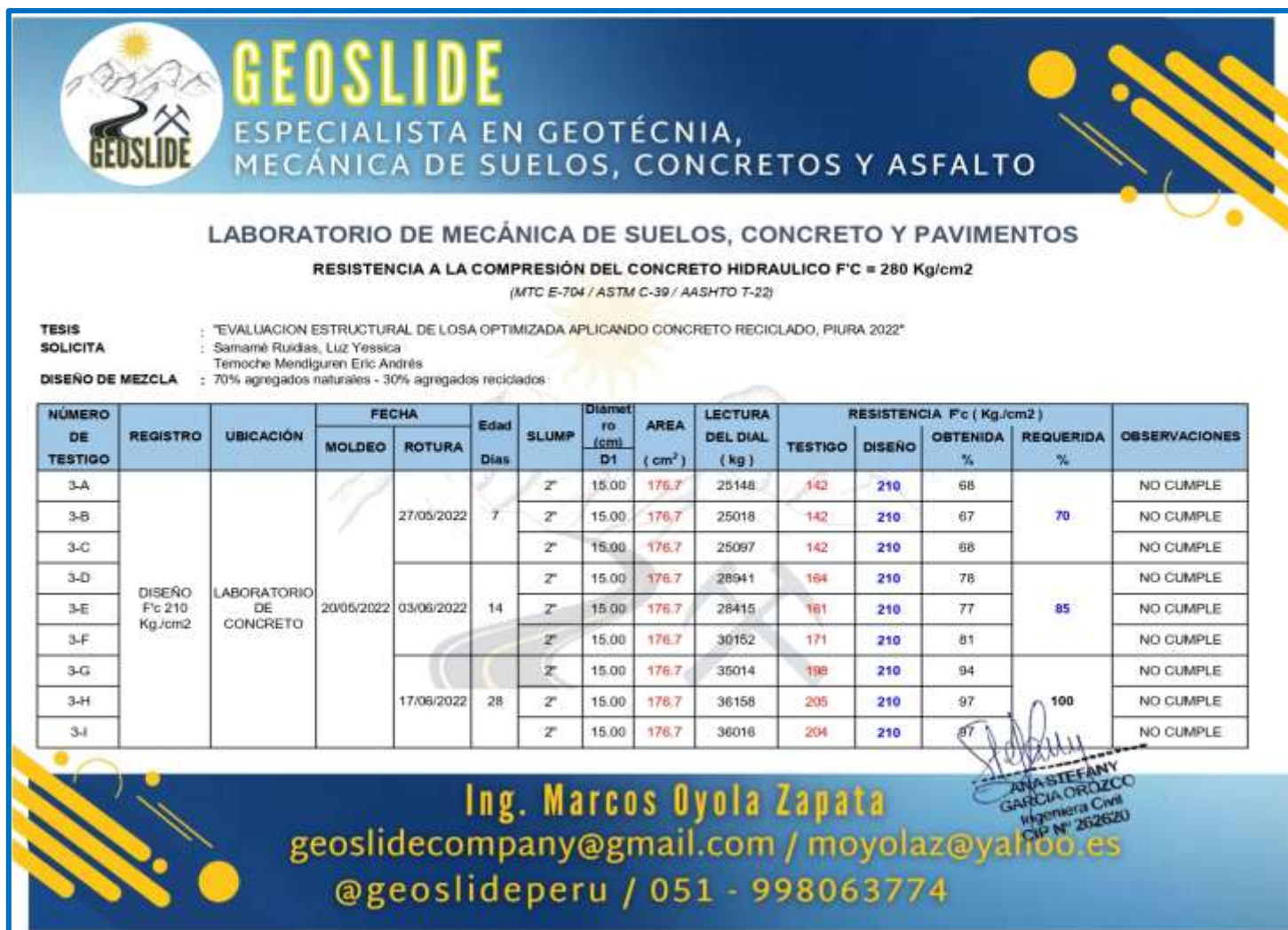
Figura 24. Ensayo de resistencia de concreto con 70% de agregado natural y 30% agregado reciclado.
