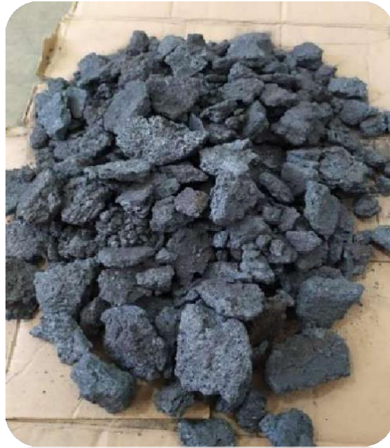
Figura.25 Escoria de acero
