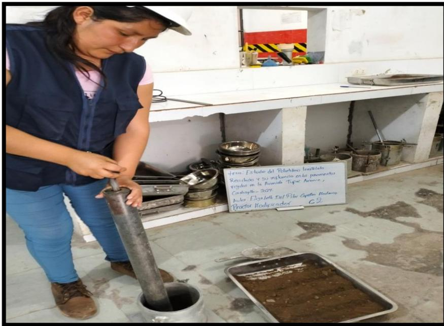
**Figura 16** Proceso Proctor modificador
