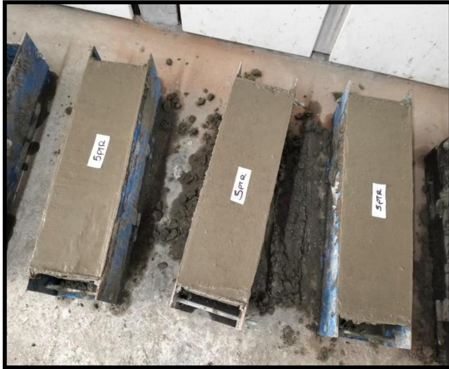
*Figura 25 Llenado de prismas adicionando 5% PET*
