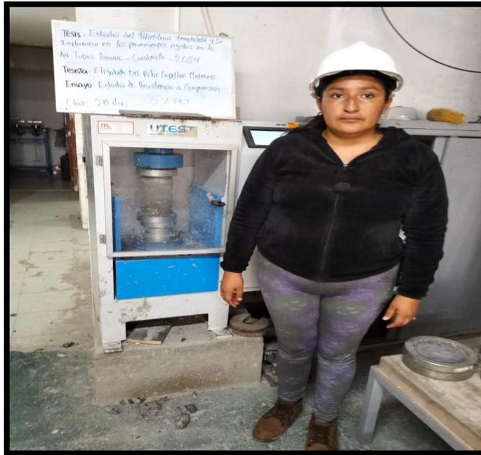
**Figura 51** Rotura de probeta 2da muestra, adicionando 5% PET-28 días.
