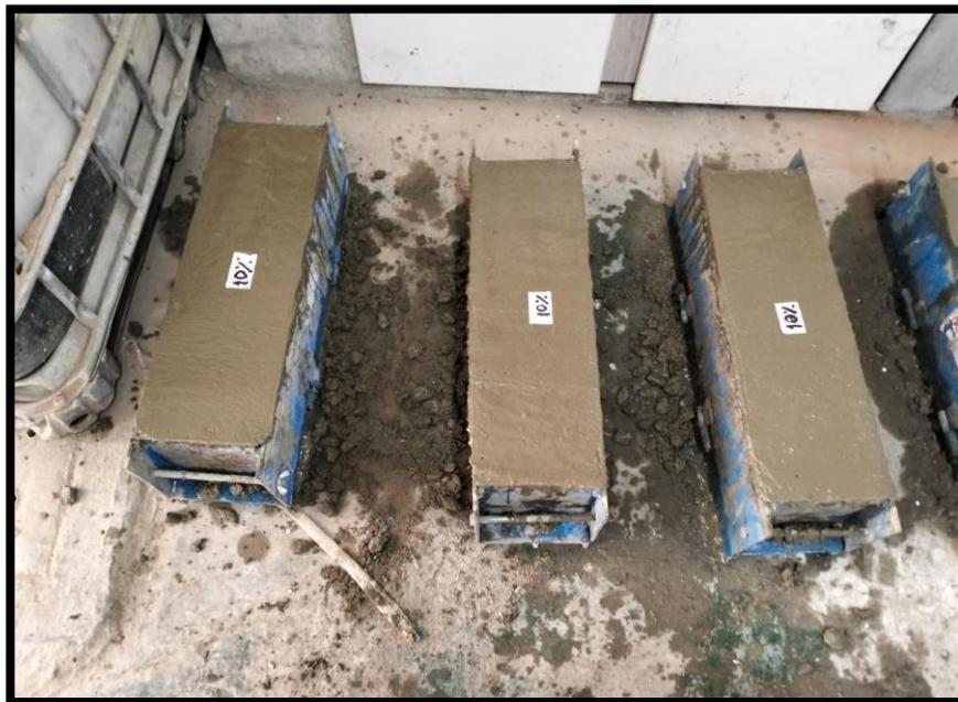
*Figura 26 Llenado de prismas adicionando 10% PET*
