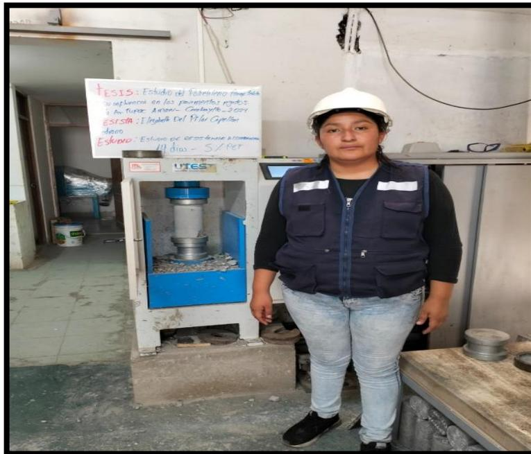
**Figura 42** Rotura de probeta 2da muestra, adicionando 5% PET- 14 das
