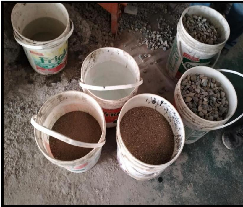
**Figura 17** Agregados utilizados para las probetas de concreto
