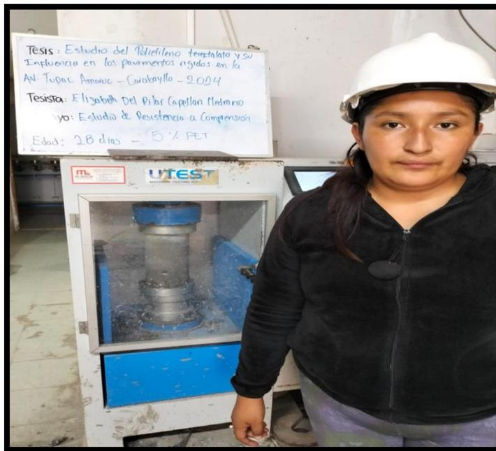
**Figura 52** Rotura de probeta 3era muestra, adicionando 5% PET-28 días
