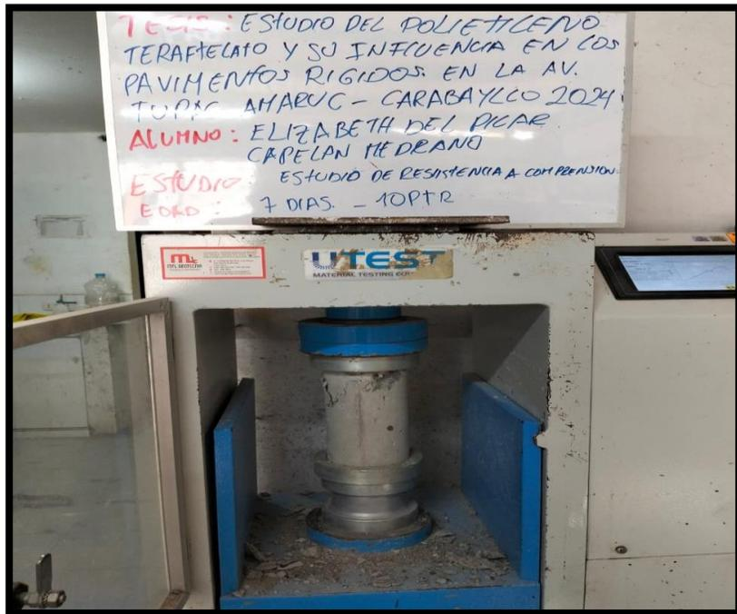
**Figura 36** Rotura de probeta 2da muestra adicionado 10% PET-7 días
