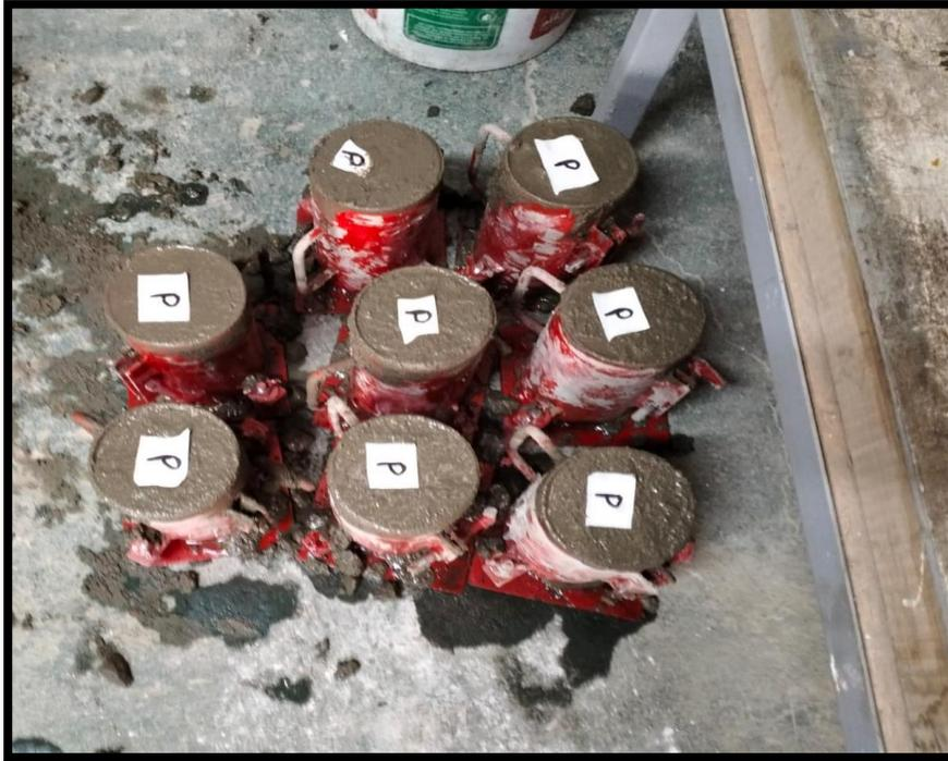
**Figura 21** Llenado de probetas del modelo patrón- Resistencia a compresión
