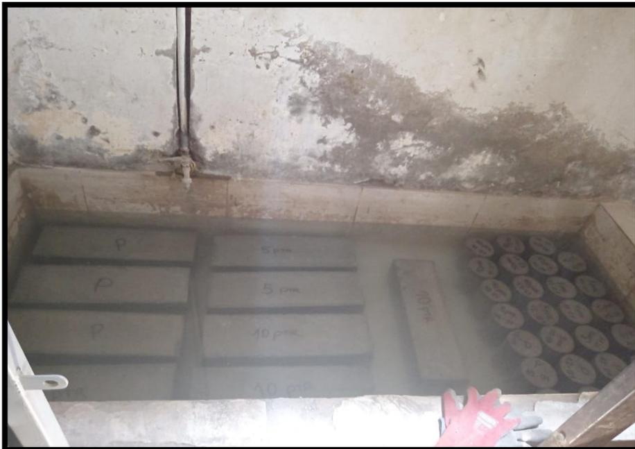
**Figura 28** Curado de probetas y prismas
