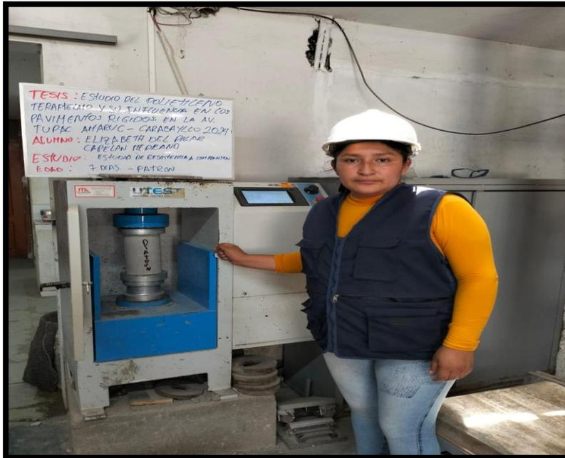
**Figura 29** Rotura de probetas 1ra muestra, modelo patrón- 7días
