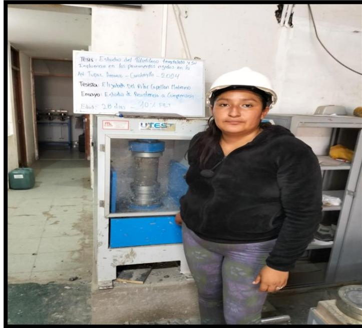
**Figura 55** Rotura de probeta 3era muestra, adicionando 10% PET- 28 días.
