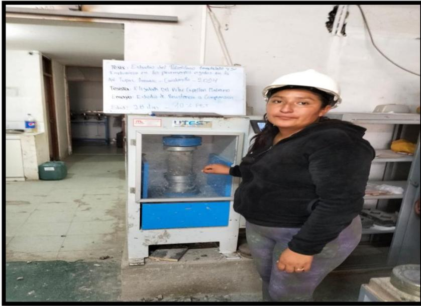
**Figura 53** Rotura de probeta 1era muestra, adicionando 10% PET-28 días.
