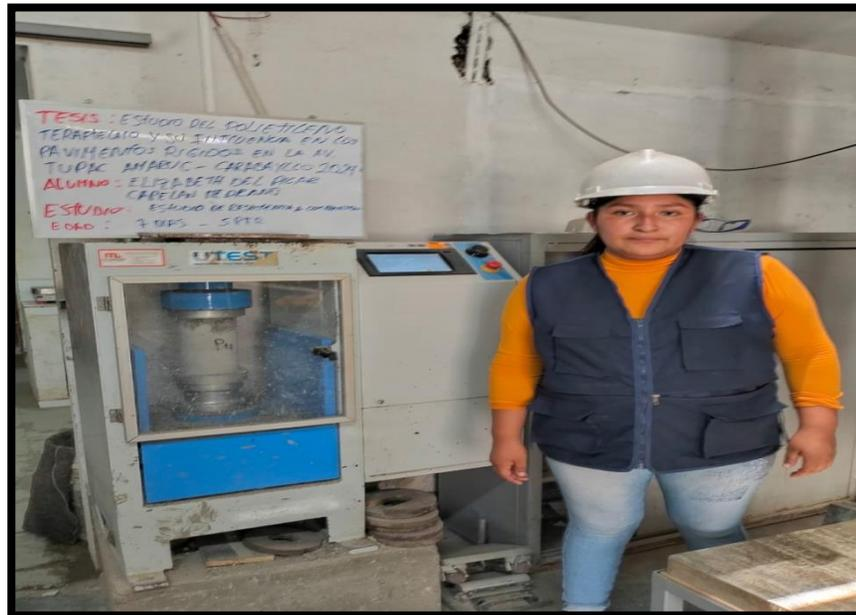
**Figura 32** Rotura de probeta 1ra muestra, adicionando 5% PET- 7 das
