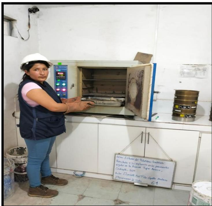
**Figura 11: Secado de muestra por 24 horas**
