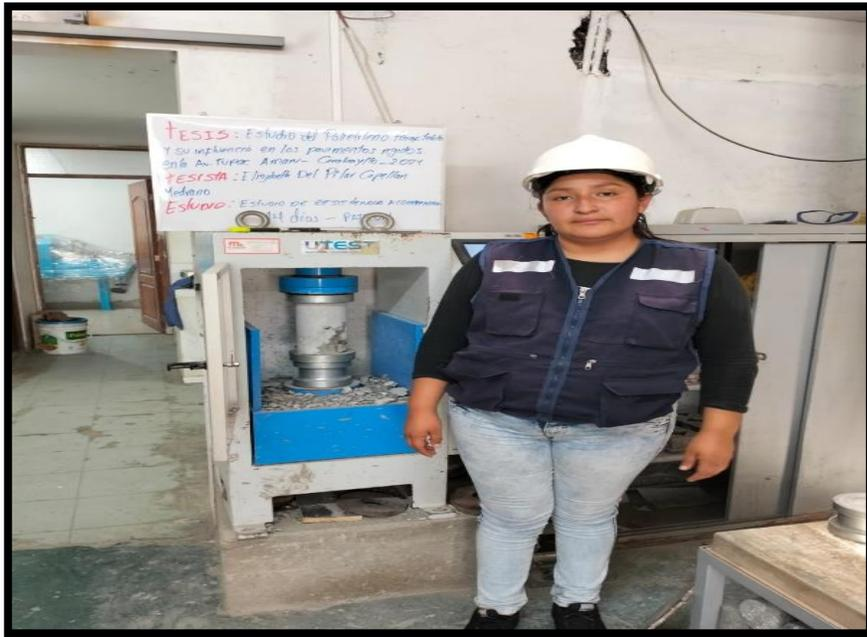
**Figura 39** Rotura de probeta 2da muestra, modelo patron-14dias
