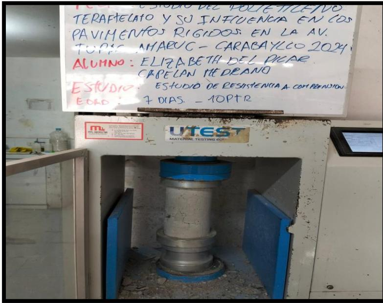
**Figura 37** Rotura de probeta 3era muestra adicionado 10% PET-7 días
