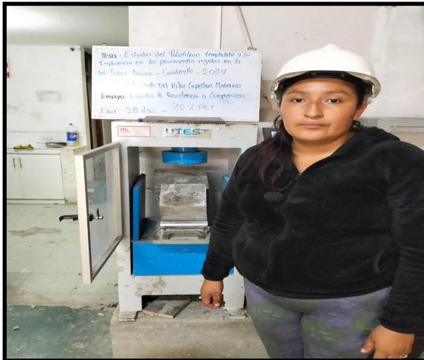
**Figura 54** Rotura de probeta 2dra muestra, adicionando 10% PET-28 días.
