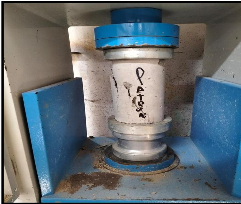
**Figura 30** Rotura de probeta 2da muestra, modelo patron-7días
