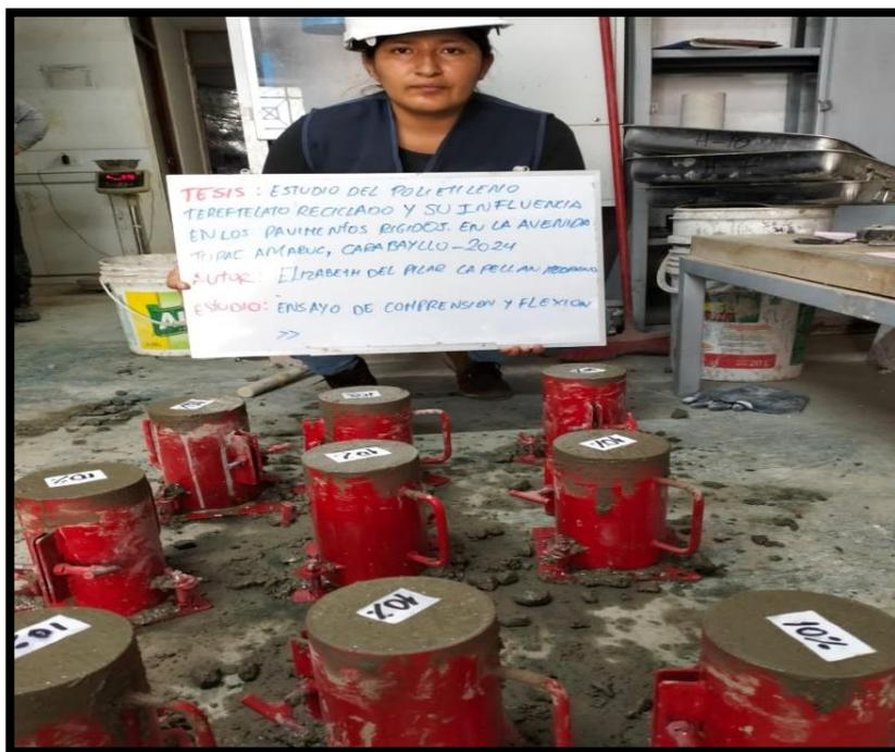
**Figura 23** Llenado de probetas adicionando 10% PET-resistencia a compresión
