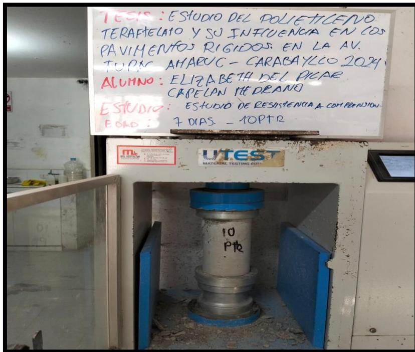
**Figura 35** Rotura de probeta 1era muestra adicionado 10% PET-7 días.
