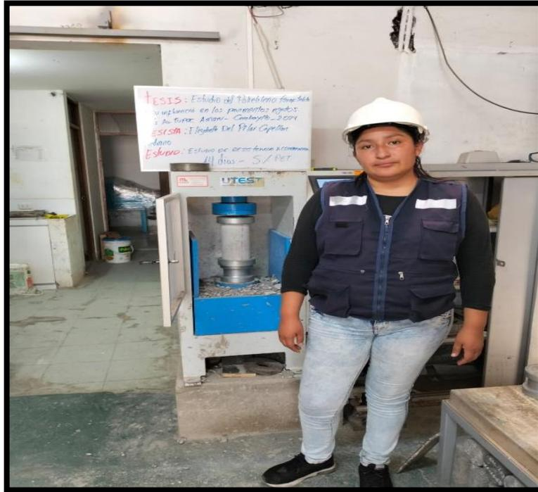
**Figura 41** Rotura de probeta 1ra muestra, adicionando 5% PET- 14 das
