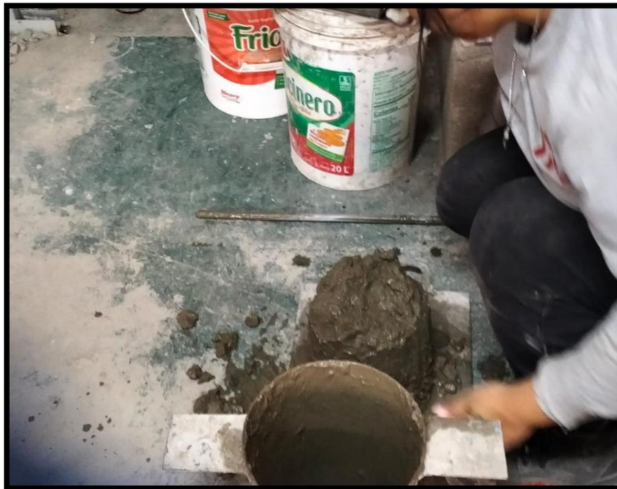
*Figura 20 Ensayo de prueba SLUMP*
