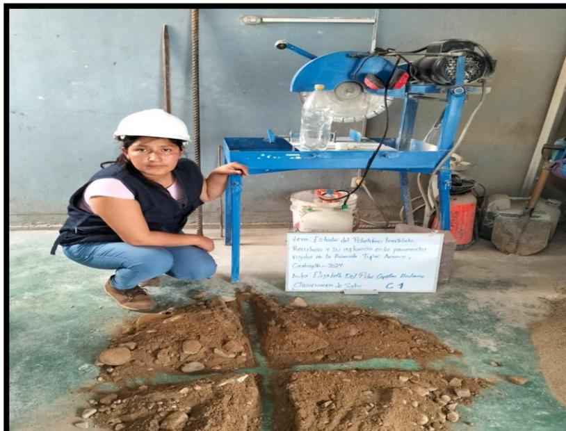
**Figura 10** Clasificación de suelos mediante cuarteo de muestra
