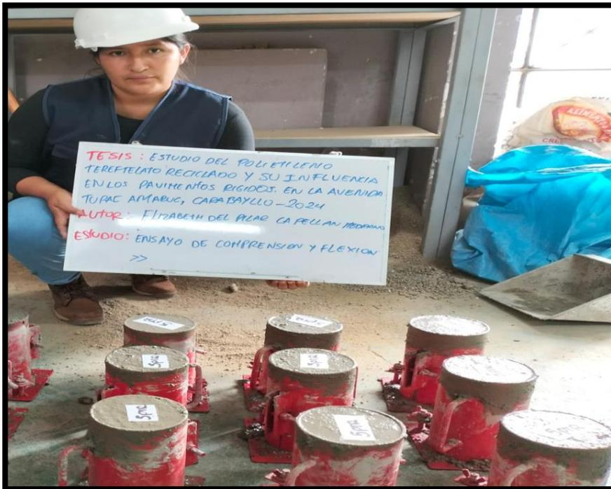
**Figura 22** Llenado de probetas adicionado 5% PET- Resistencia a compresión
