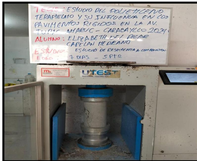
**Figura 34** Rotura de probeta 3era muestra adicionado 5% PET-7 días
