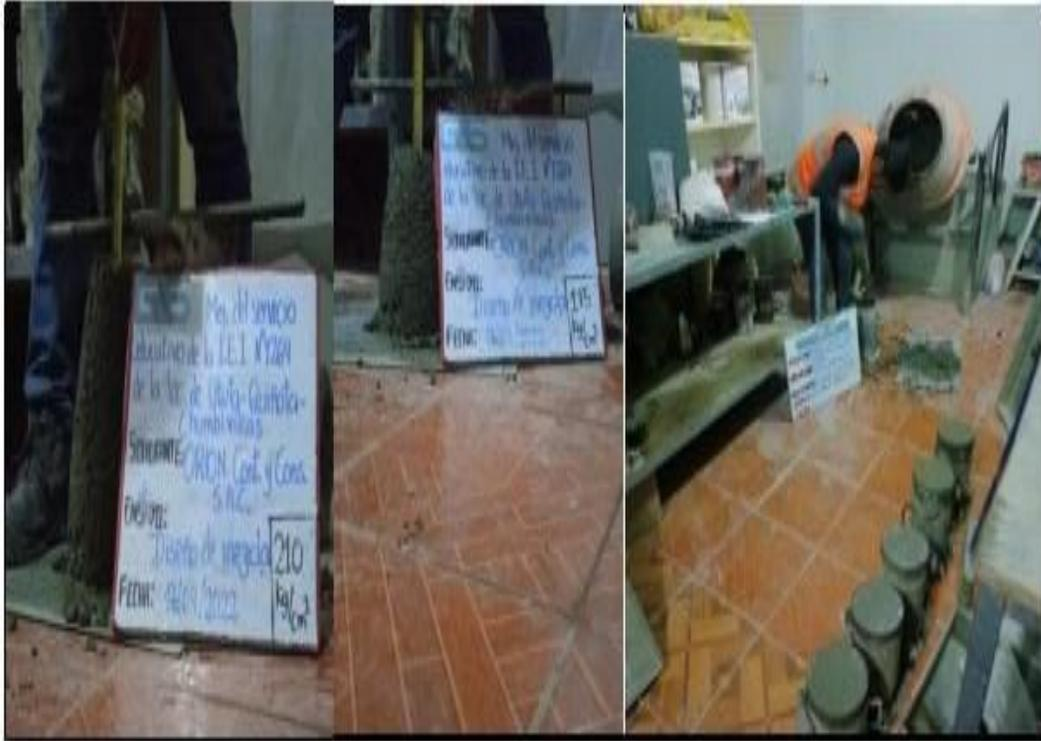
Figura 18. Dosificación de diseños de mezclas utilizados en obra por laboratorio.
