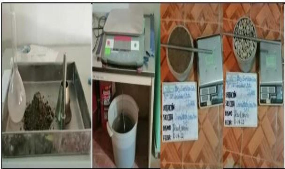
Figura 17. Ensayos de gravedad específica y pesos en laboratorio.
