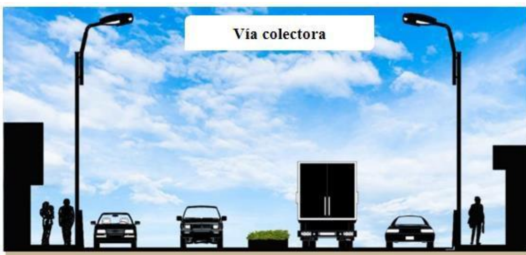
Figura 54. Sección de Vía colectora.
