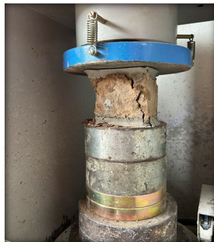
Figuras 66 y 67: Ensayo de resistencia a la compresión de adobe. Fuente: Propia.
