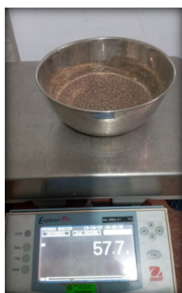
Figuras 73, 74 y 75: Proceso de clasificación de suelos - SUCS.
