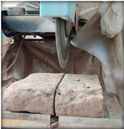
Figuras 64 y 65: Cortado y capeado de muestras de adobe. Fuente: Propia.
