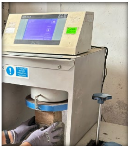
Figuras 66 y 67: Ensayo de resistencia a la compresión de adobe. Fuente: Propia.
