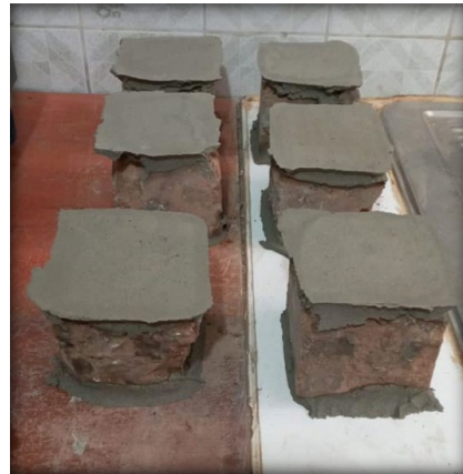
Figuras 64 y 65: Cortado y capeado de muestras de adobe. Fuente: Propia.
