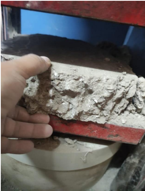
Fotografía 07: muestras de rotura a compresión
