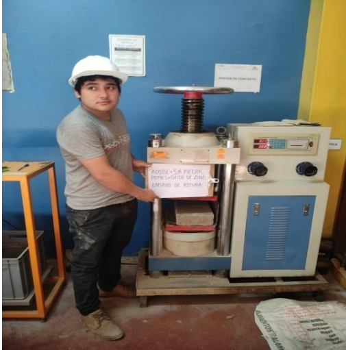
Fotografía 05: ensayo de rotura a compresión
