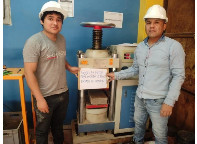
Fotografía 06: ensayo de rotura a compresión
