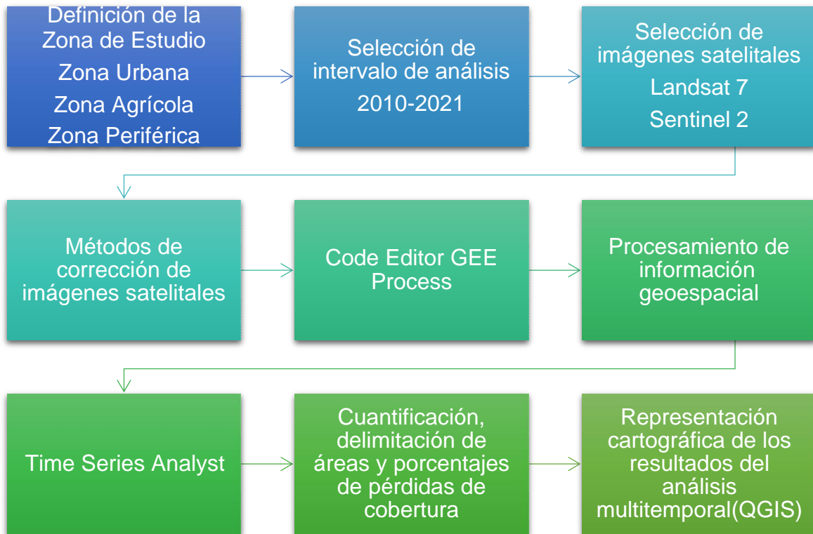
Figura 1 Diagrama de flujo de procesamiento de imágenes satelitales para el análisis de la deforestación y erosión de suelo
