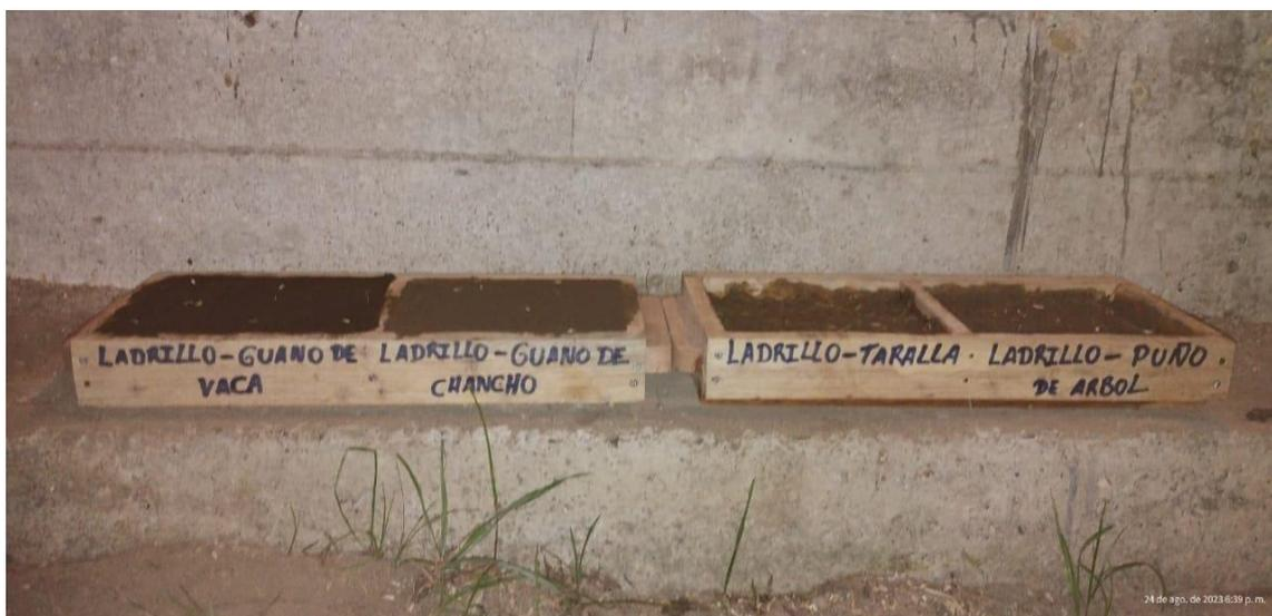
Nota. Esta figura muestra las pruebas de combinación en la elaboración de ladrillos combustibles
