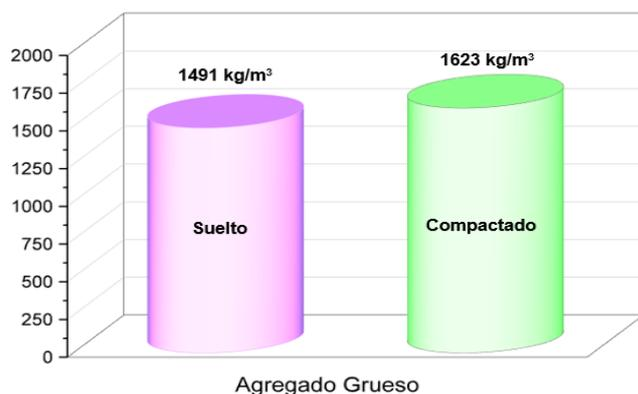
**Figura 19.** Comparativa del PUS y PUC del agregado grueso
