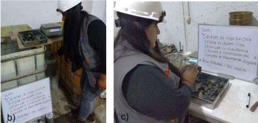
**Figura 10.** Prueba en A. G. de (a) gravedad específica y (b) absorción
