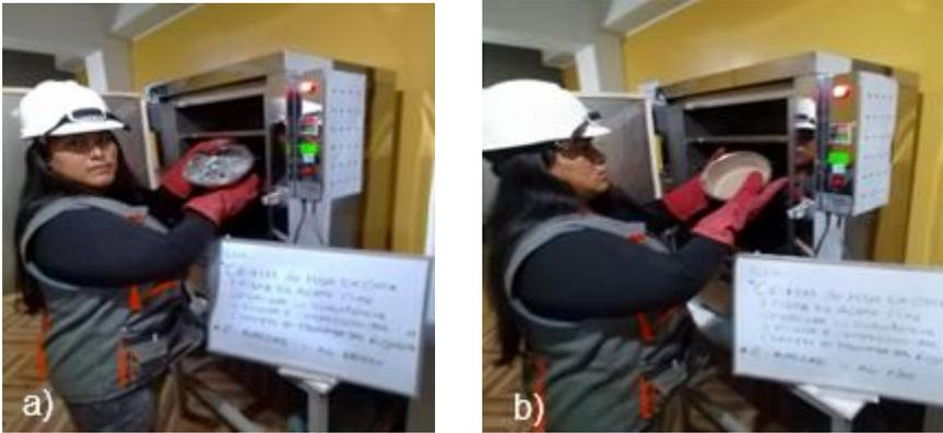
**Figura 6.** Humedad en el agregado (a) grueso (b) fino
