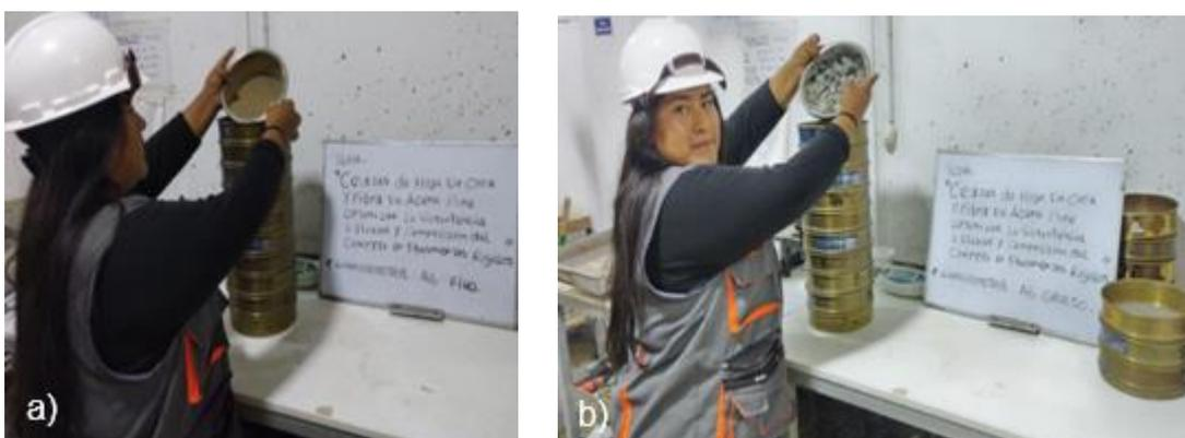
**Figura 5.** Los agregados y su granulometría de (a) finos y (b) gruesos
