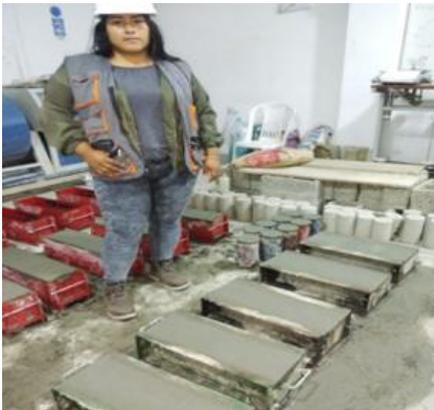
**Figura 13.** Colocado del concreto en los moldes
