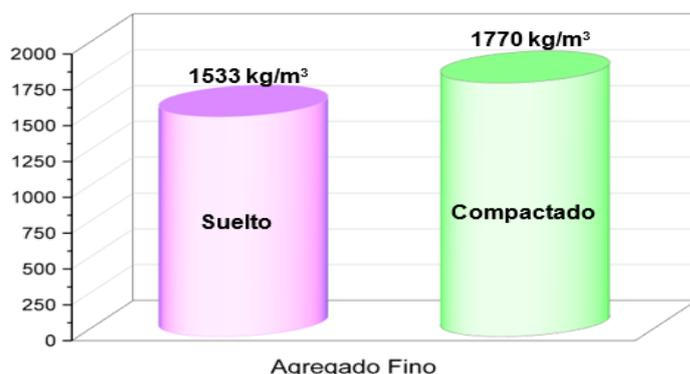
**Figura 18.** Comparativa del PUS y PUC del agregado fino
