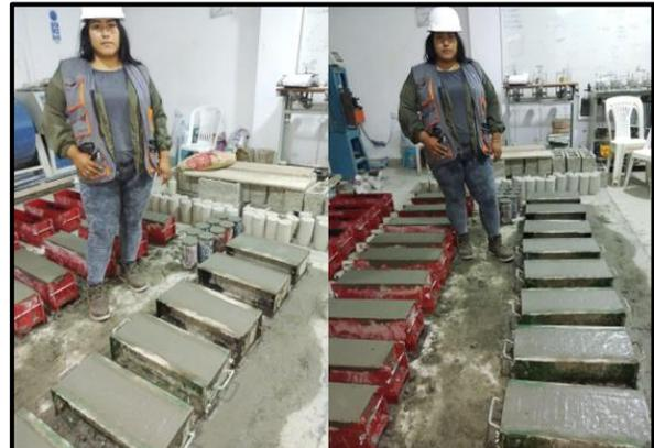
Fotografía 10. Elaboración de especímenes de concreto
