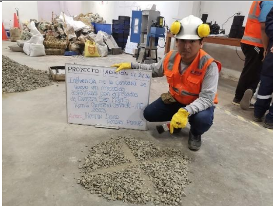
Cuarteo de agregado grueso
