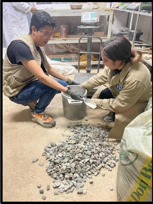
Foto 15: Ensayo de peso unitario de agregado
