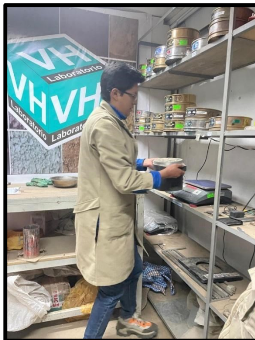
Foto 14: Ensayo de peso unitario de agregado
