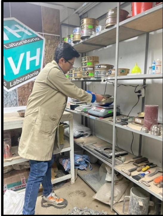
Foto 08: Ensayo de peso unitario de agregado
