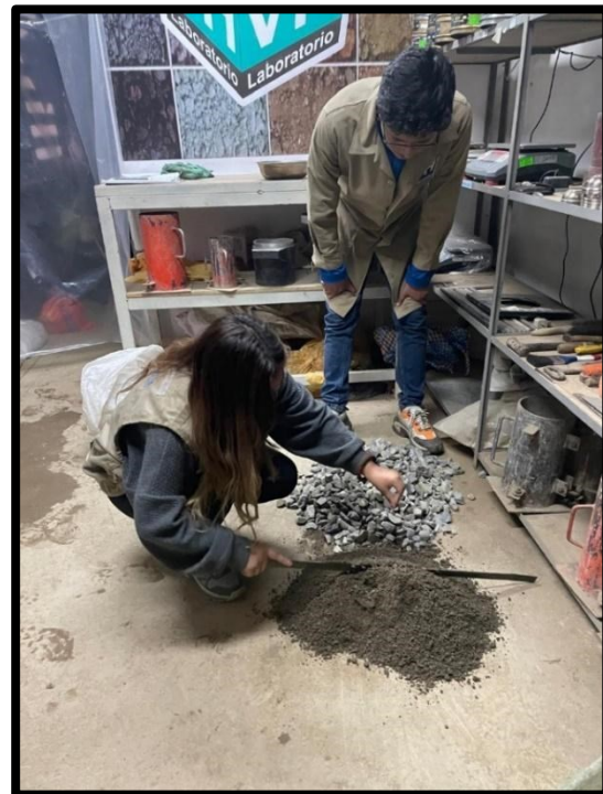
Foto 06: Cuarteo de la arena gruesa
