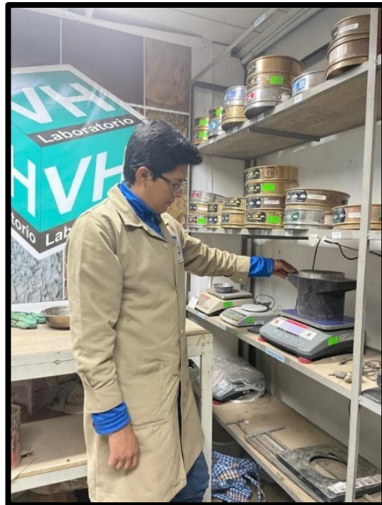
Foto 12: Ensayo de peso unitario de agregado
