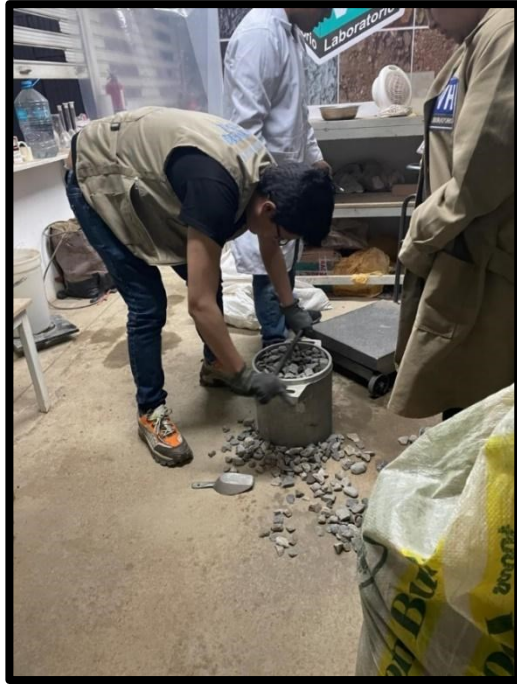
Foto 16: Ensayo de peso unitario de agregado
