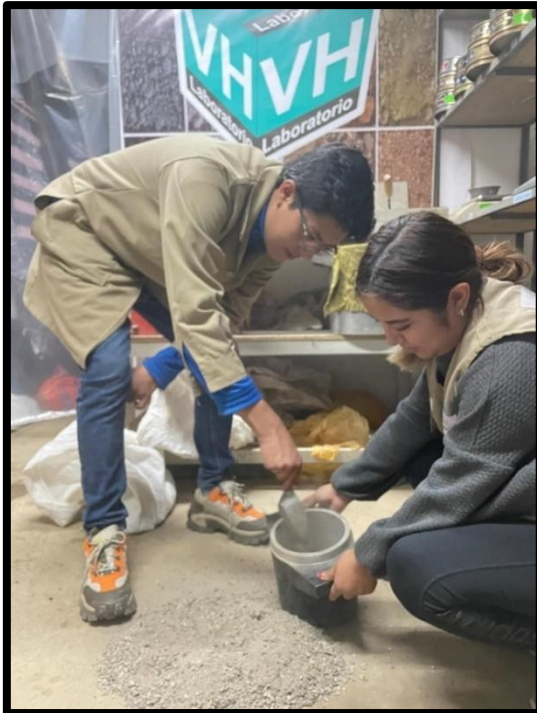
Foto 11: Ensayo de peso unitario de agregado
