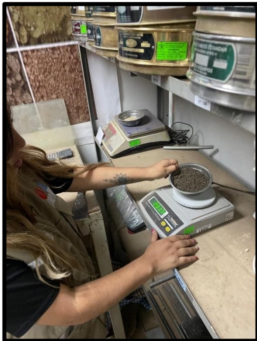
Foto 21: Ensayo de humedad de agregados
