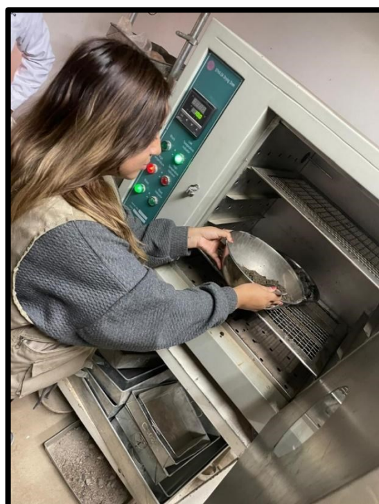
Foto 10: Ensayo de humedad de agregados
