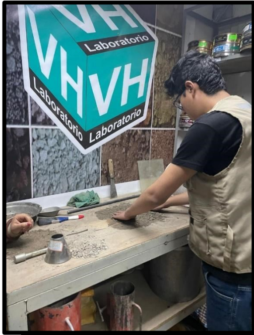
Foto 20: Ensayo de humedad de agregados
