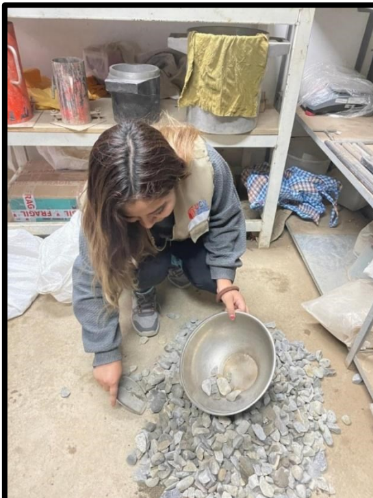
Foto 09: Ensayo de peso unitario de agregado
