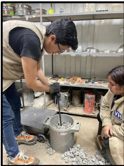
Foto 18: Varillado de piedra chancada
