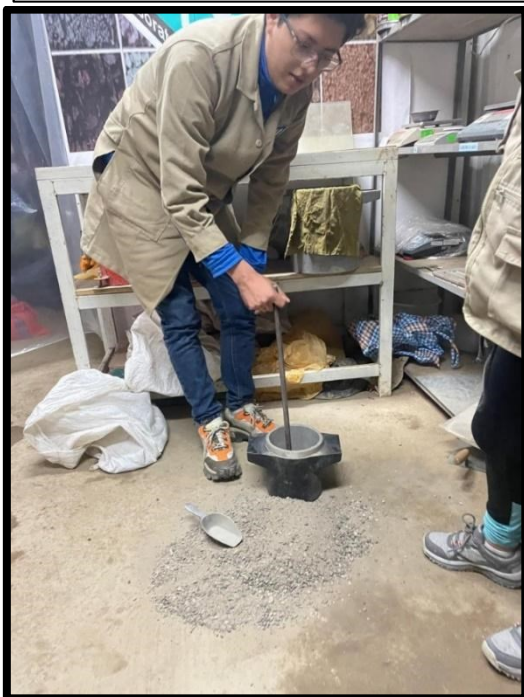
Foto 13: Varillado de piedra chancada
