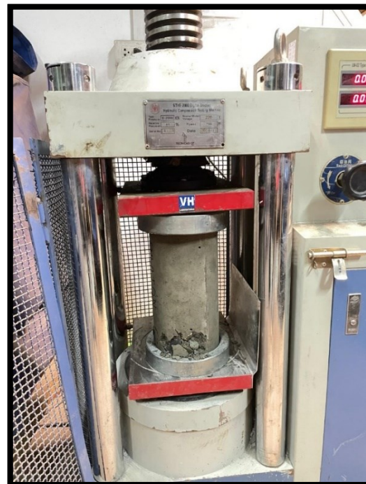
Foto 48: Ensayo de compresión al concreto, Tipo V
