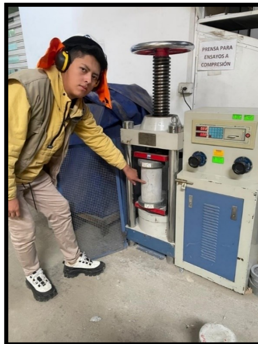
Foto 35: Ensayo de compresión al concreto, Tipo II
