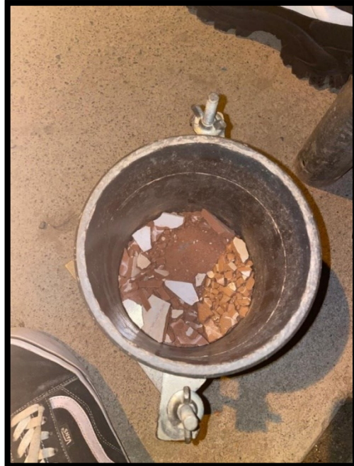
Foto 27: Trituración de cerámico reciclado
