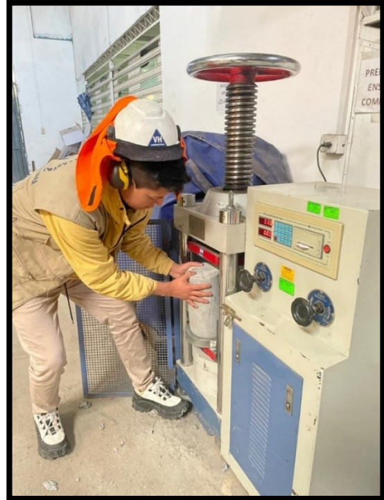
Foto 54: Ensayo de compresión al concreto
