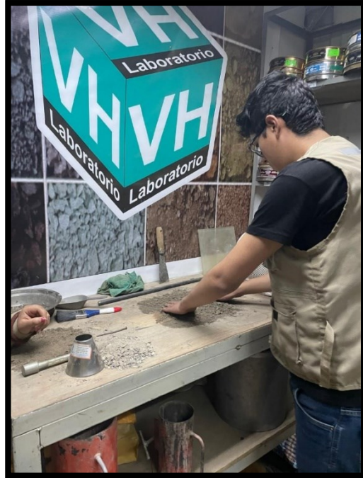
Foto 20: Ensayo de humedad de agregados
