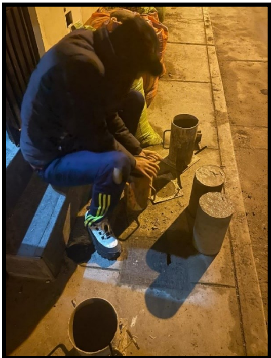
Foto 43: Desencofrado de probetas
