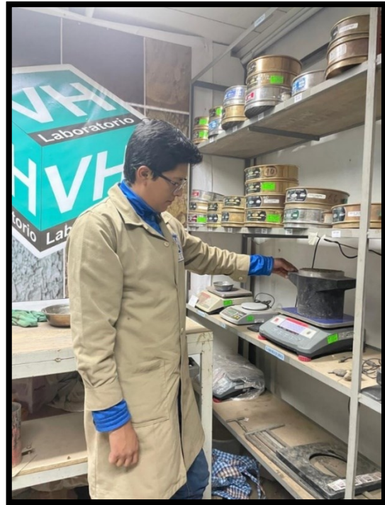
Foto 12: Ensayo de peso unitario de agregado
