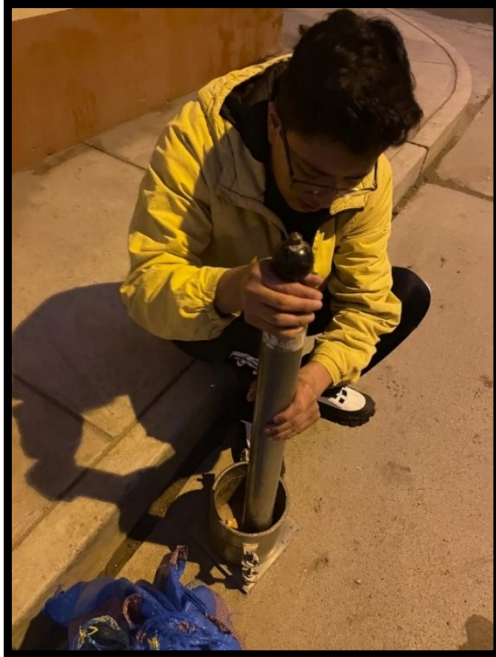
Foto 26: Trituración de cerámico reciclado
