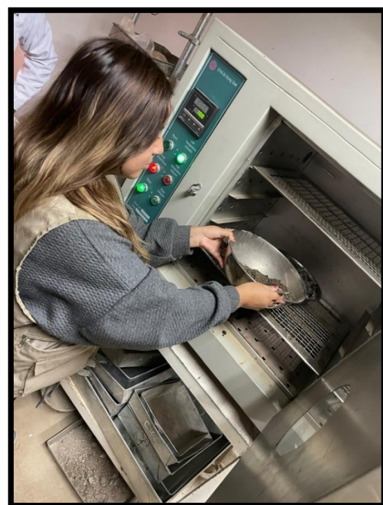
Foto 10: Ensayo de humedad de agregados
