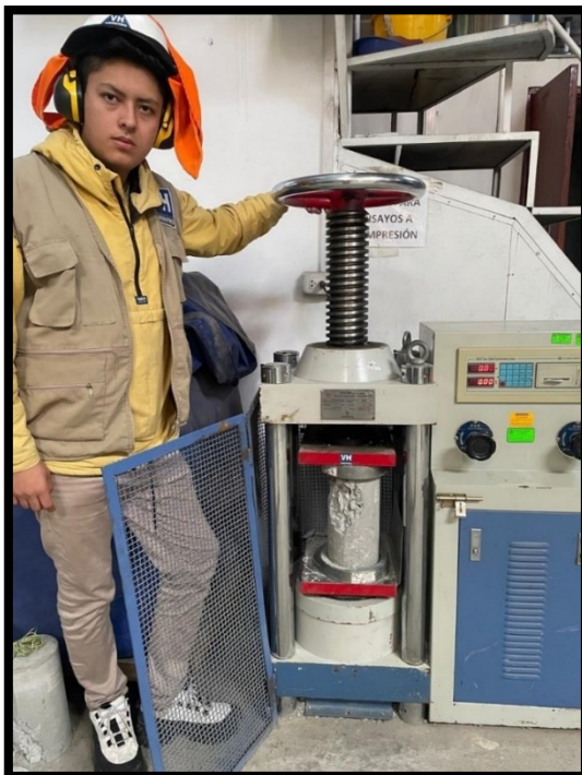
Foto 51: Ensayo de compresión al concreto, Tipo II
