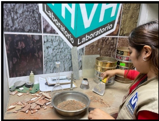
Foto 31: Ensayo granulométrico de cerámico reciclado
