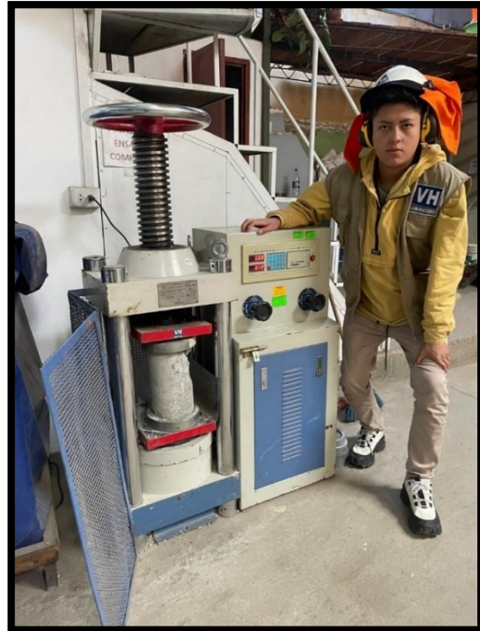
Foto 52: Ensayo de compresión al concreto, Tipo V
