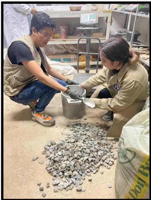
Foto 15: Ensayo de peso unitario de agregado
