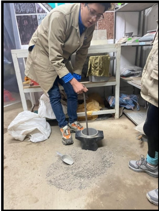
Foto 13: Varillado de piedra chancada
