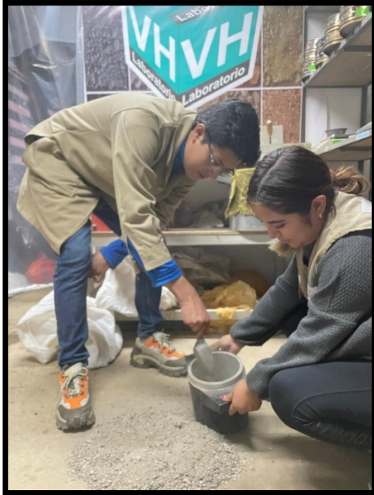
Foto 11: Ensayo de peso unitario de agregado
