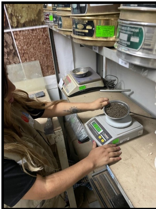
Foto 21: Ensayo de humedad de agregados
