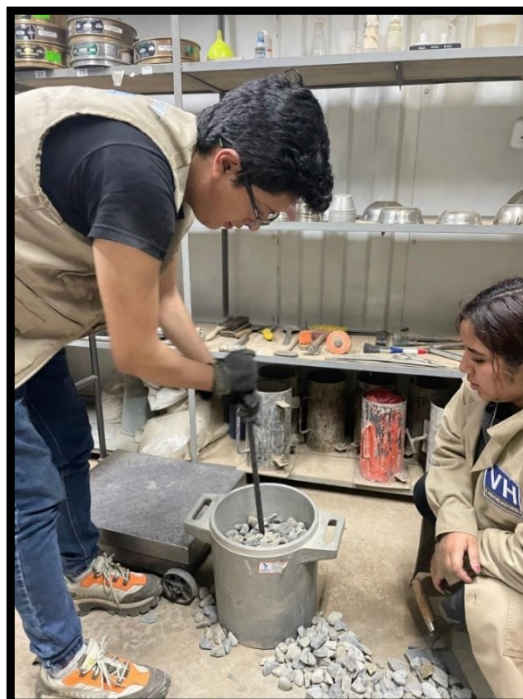
Foto 18: Varillado de piedra chancada
