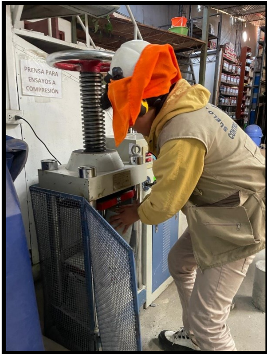
Foto 53: Ensayo de compresión al concreto
