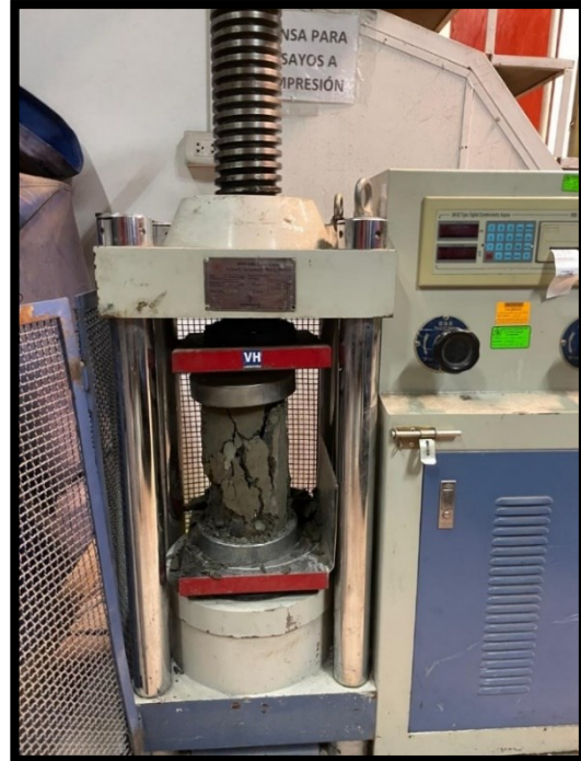
Foto 50: Ensayo de compresión al concreto, Tipo III
