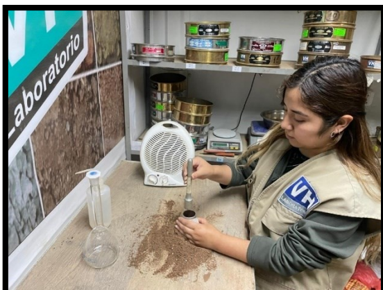
Foto 35: Ensayo granulométrico de cerámico reciclado
