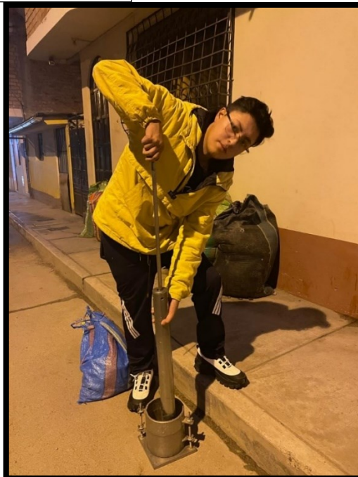
Foto 28: Trituración de cerámico reciclado
