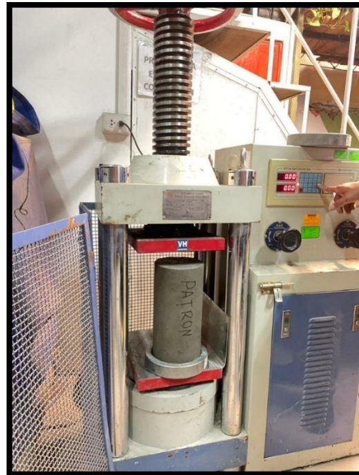
Foto 46: Ensayo de compresión al concreto
