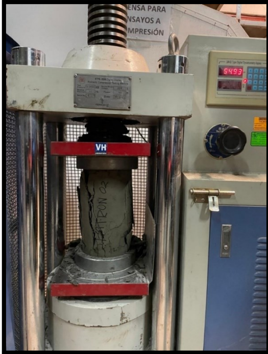
Foto 49: Ensayo de compresión al concreto, Tipo II
