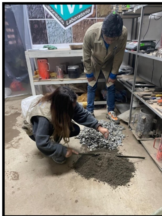
Foto 06: Cuarteo de la arena gruesa
