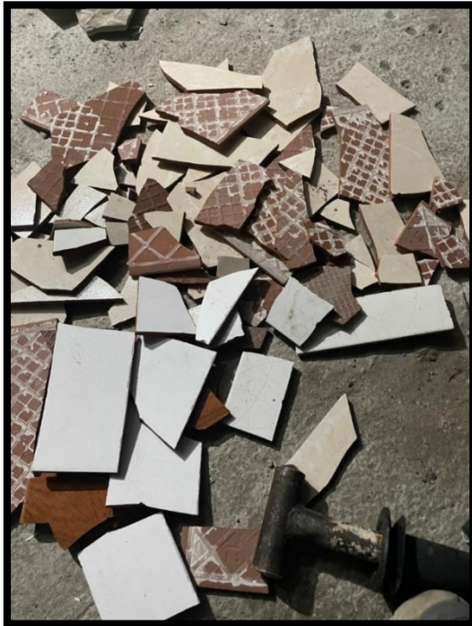
Foto 24: Trituración de cerámico reciclado
