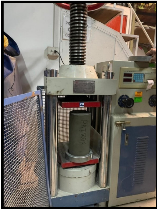
Foto 45: Ensayo de compresión al concreto
