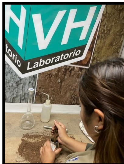
Foto 34: Ensayo granulométrico de cerámico reciclado
