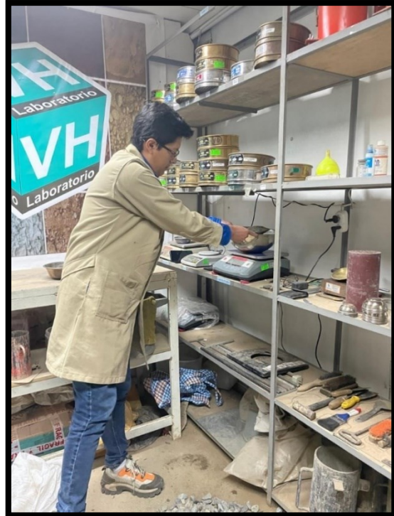
Foto 08: Ensayo de peso unitario de agregado
