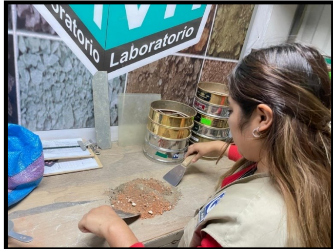
Foto 30: Ensayo granulométrico de cerámico reciclado
