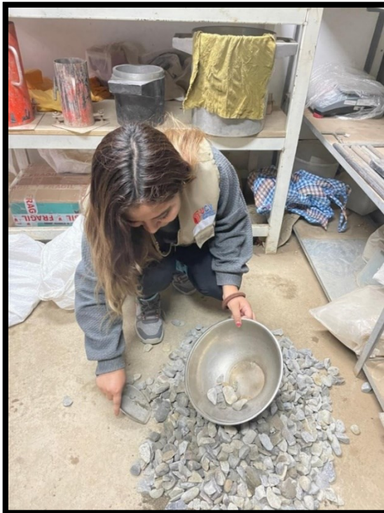
Foto 09: Ensayo de peso unitario de agregado
