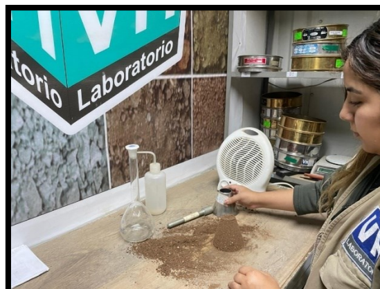
Foto 36: Ensayo granulométrico de cerámico reciclado
