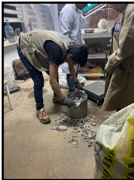
Foto 16: Ensayo de peso unitario de agregado
