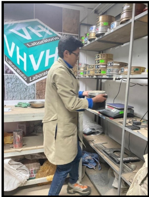
Foto 14: Ensayo de peso unitario de agregado
