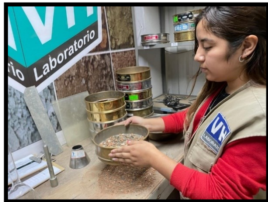
Foto 32: Ensayo granulométrico de cerámico reciclado
