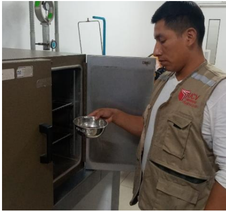
Foto 19. Muestra al horno 24 horas (arcilla)
