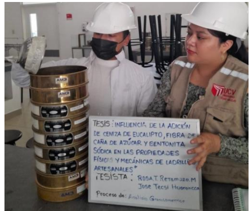
Foto 20. Tamizado de material
