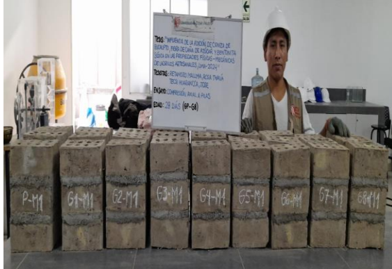
Foto 67. Grupo de ladrillos secos a pilas para ensayo a compresión axial
