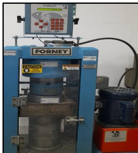
Figura 36. Resistencia a compresión de ladrillos
