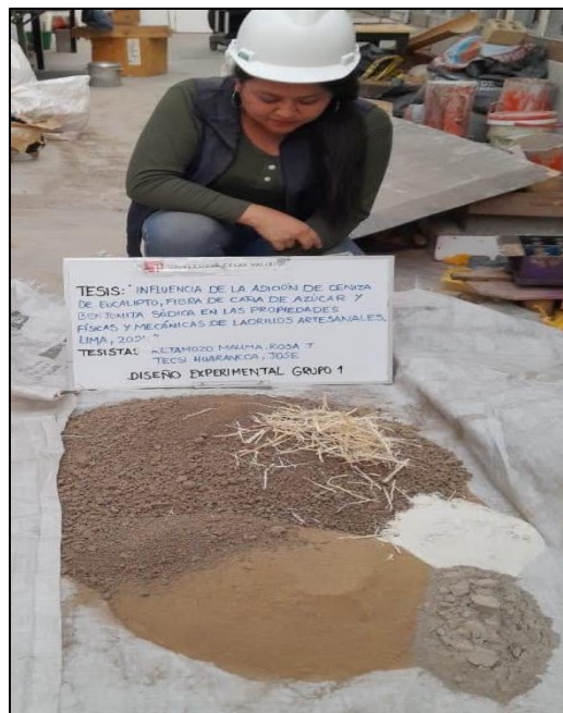
Figura 30. Mezcla seca para ladrillos artesanales del grupo 1
