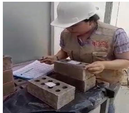
Foto 60. Medición de cada ladrillo artesanal (ancho, largo y alto) por cada G.E
