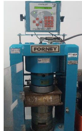
Foto 56. Ensayo a compresión de ladrillo artesanal
