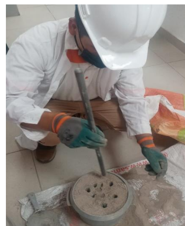
Foto 30. Material compactado de la ceniza de eucalipto
