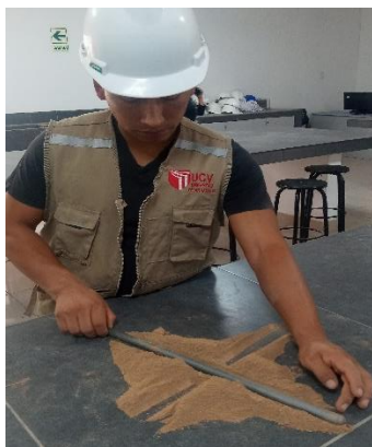
Foto 11. Cuarteo de tierra amarilla
