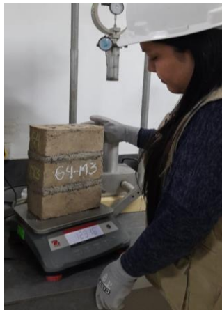
Foto 69. Pesado de cada murete(pilas)
