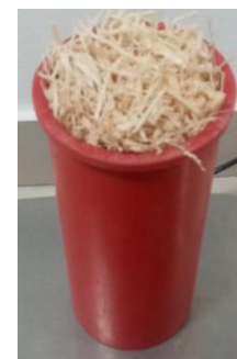
Foto 36. Material compactado de la fibra de caña de azúcar
