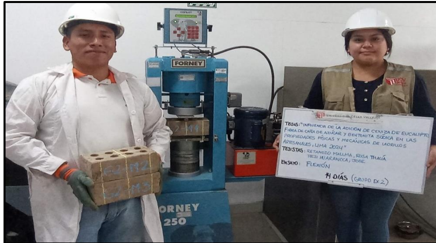
Figura 9. Ensayo de resistencia a la flexión Fuente: propia
