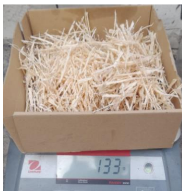
Foto 35. Material suelto de la fibra de caña de azúcar
