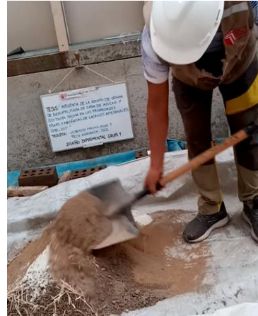
Foto 44. Mezcla de los aditivos con la arcilla
