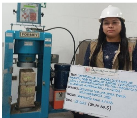
Foto 71. Rotura a compresión axial a pilas
