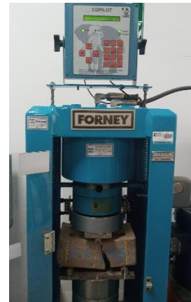
Foto 58. Ensayo a flexión de ladrillo artesanal
