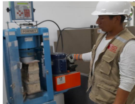
Foto 70. Proceso de rotura de muretes (pilas)
