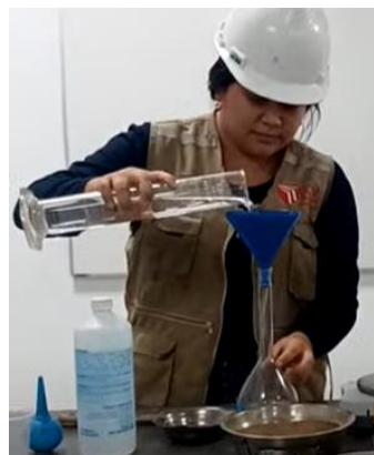
Foto 40. Llenado de agua al picnómetro
