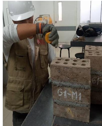
Foto 68. Proceso de medición de cada murete(pilas)
