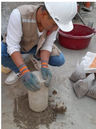
Foto 37. Material molido de ladrillo artesanal
