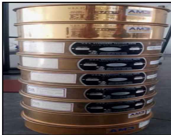
Figura 7. Determinación de la granulometría de las partículas Fuente: propia
