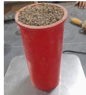
Foto 34. Material compactado de la arcilla
