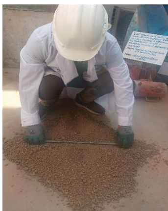
Foto 17. Cuarteo de material(arcilla)
