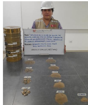
Foto 16. Retenido de material en mallas
