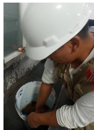
Foto 18. Lavado de material(arcilla)
