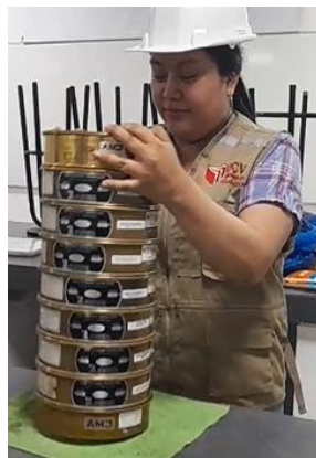
Foto 15. Tamizado de material
