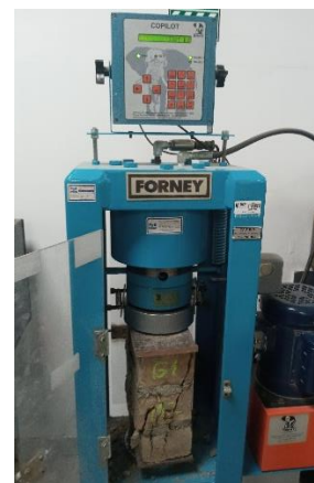
Foto 72. Ensayo de compresión axial a pilas
