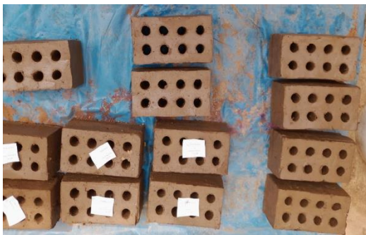
Foto 53. Grupo de ladrillos al secado natural
