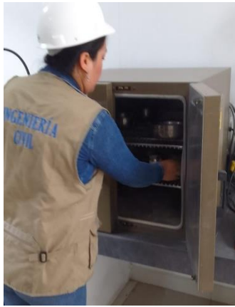
Foto 13. Muestra al horno 24 horas (tierra amarilla)
