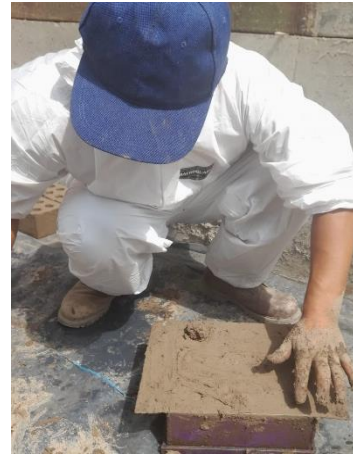
Foto 50. Rellenado de masa al molde de 8 huecos
